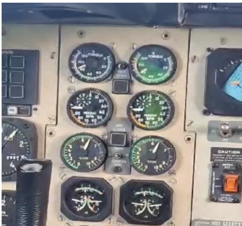
Imagen 7. Parámetros del motor izquierdo durante la corrida, dentro de los límites operacionales y sin fluctuación YV3438.
