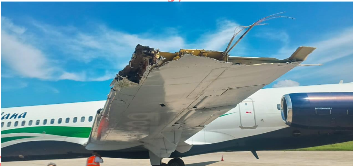
Imagen 8. Vista del impacto en el plano izquierdo YV3499 Fuente: Investigadora Encargada. Año: 2026
