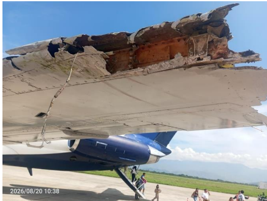
Imagen 11. Daño estructural el plano izquierdo YV3499
