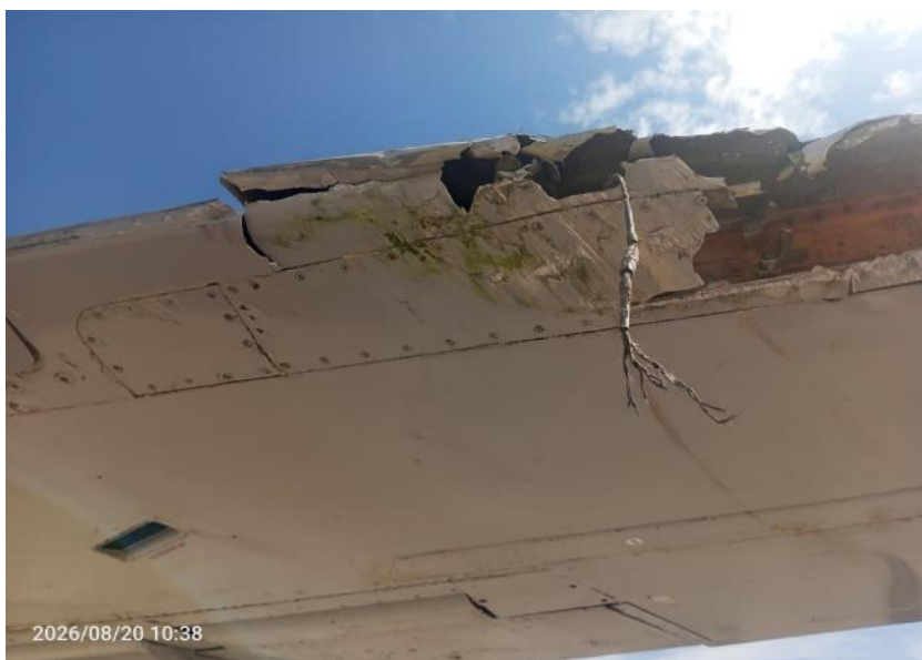
Imagen 12. Corte y exposición de cableado eléctrico plano izquierdo YV3499
