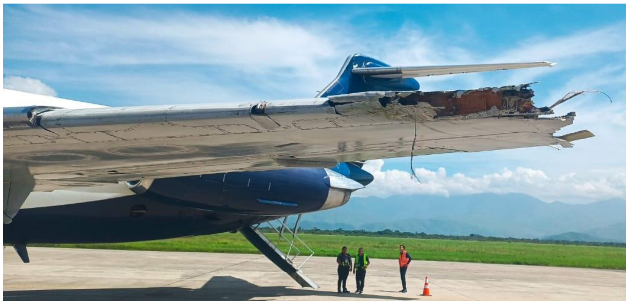
Imagen 9. Vista del impacto en el plano izquierdo YV3499 Fuente: Investigadora Encargada. Año: 2026
