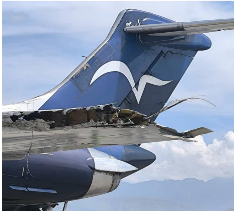
Imagen 7. Vista del impacto en el plano izquierdo YV3499 Fuente: Investigadora Encargada. Año: 2026
