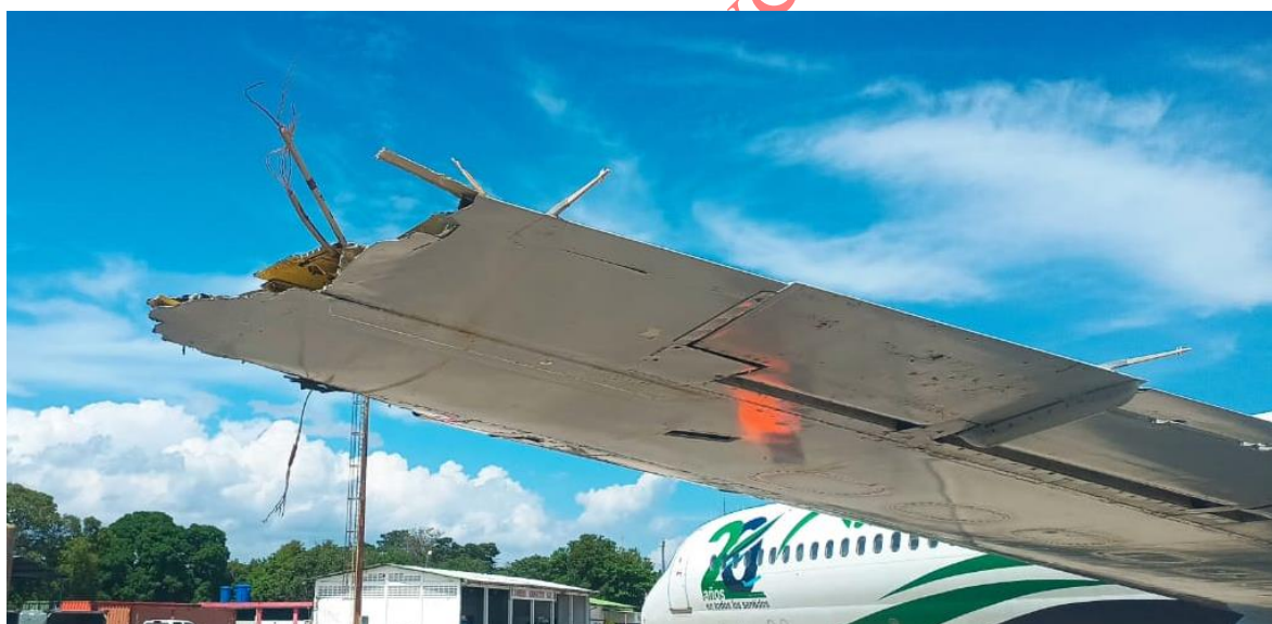
Imagen 10. Vista del impacto en el plano izquierdo YV3499 Fuente: Investigadora Encargada. Año: 2026
