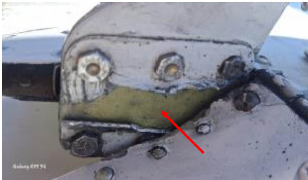
Imagen 11. Vista superior de Ruptura de Lever trim tab derecho, YV2925.
