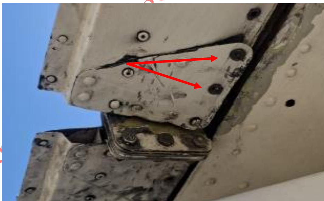
Imagen 12. Vista inferior de Ruptura de Lever trim tab drive derecho, desprendimiento parcial de remaches, YV2925.
