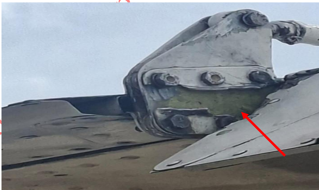
Imagen 10. Ruptura de Lever Trim tab derecho, YV2925.
