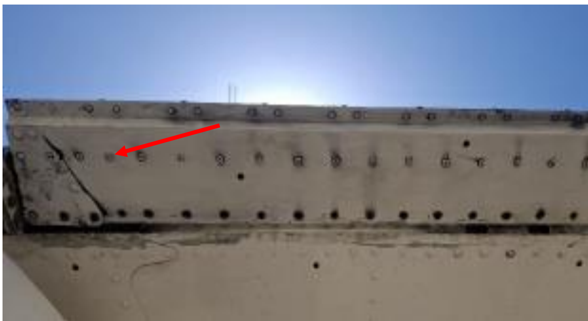
Imagen 13. Vista inferior de Ruptura de Lever trim tab drive derecho, desprendimiento parcial de remaches, YV2925.
