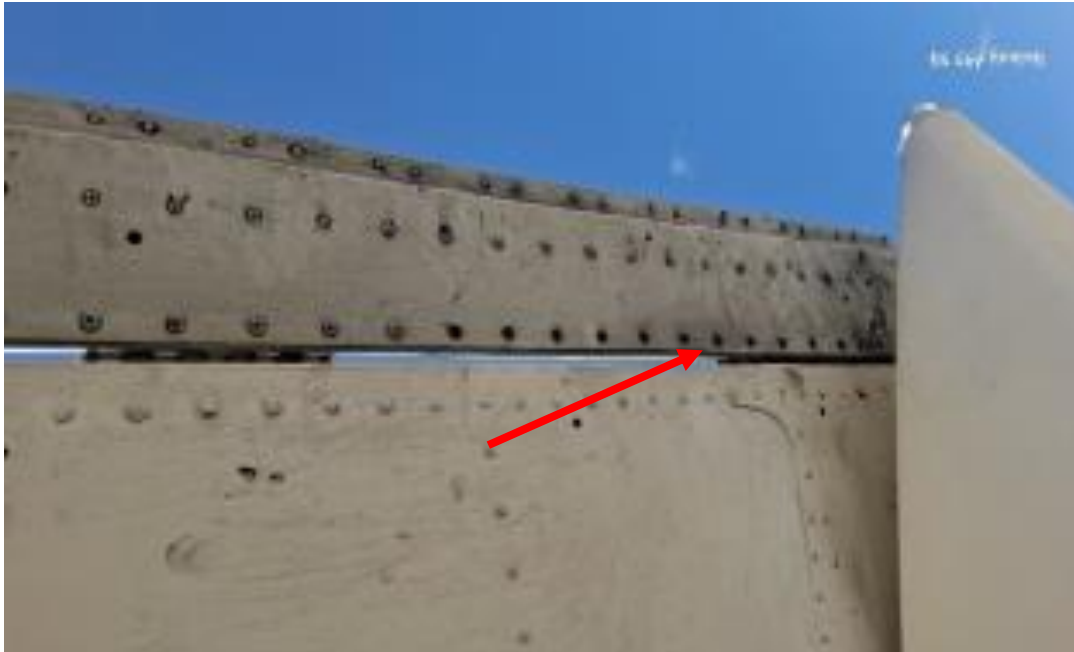
Imagen 15. Vista inferior de integridad de Lever trim tab drive izquierdo, desprendimiento parcial de remaches, YV2925.
