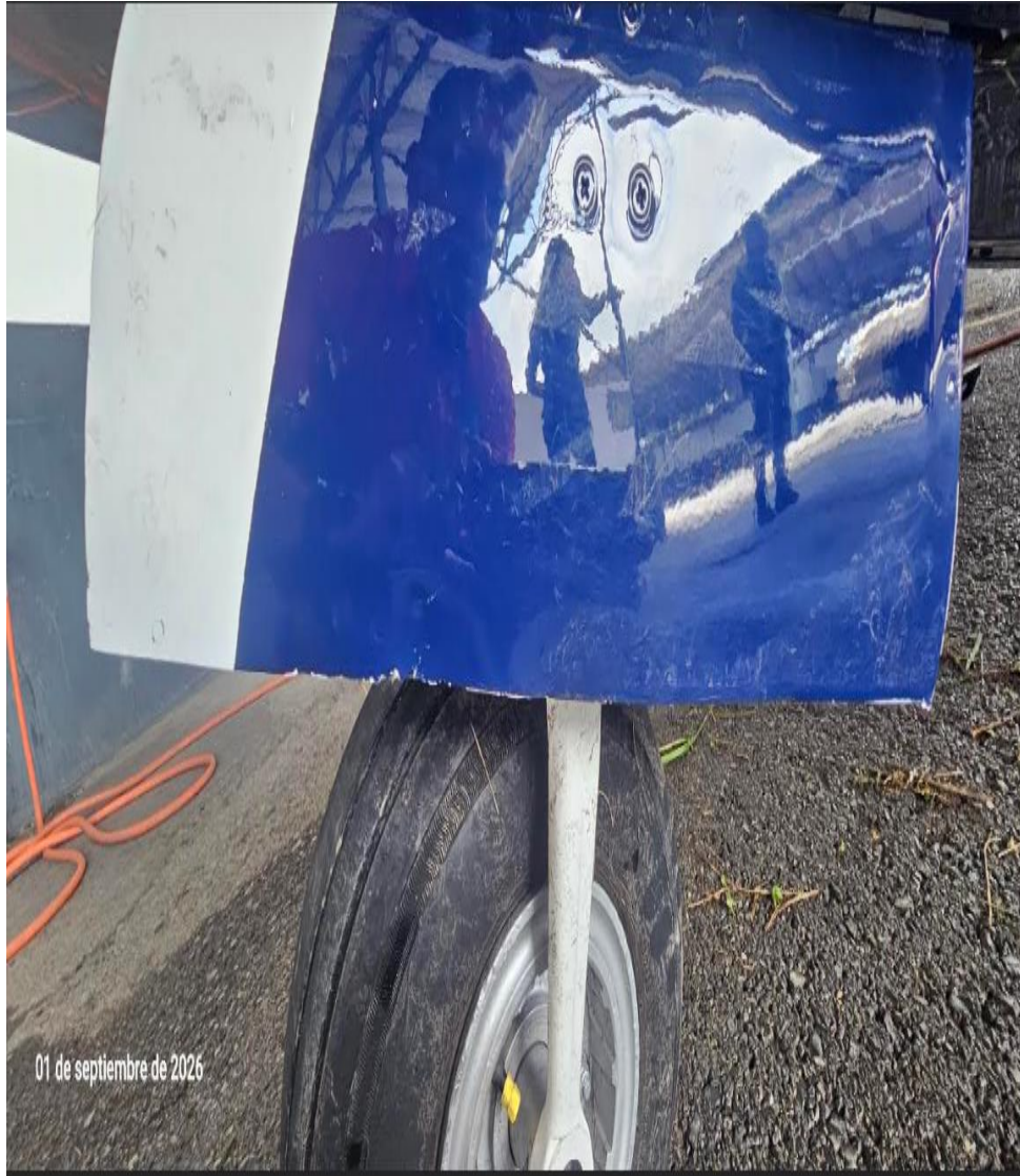
Imagen 13. Daños en la tapa del tren nariz Fuente: Investigador Encargado. Año: 2026
