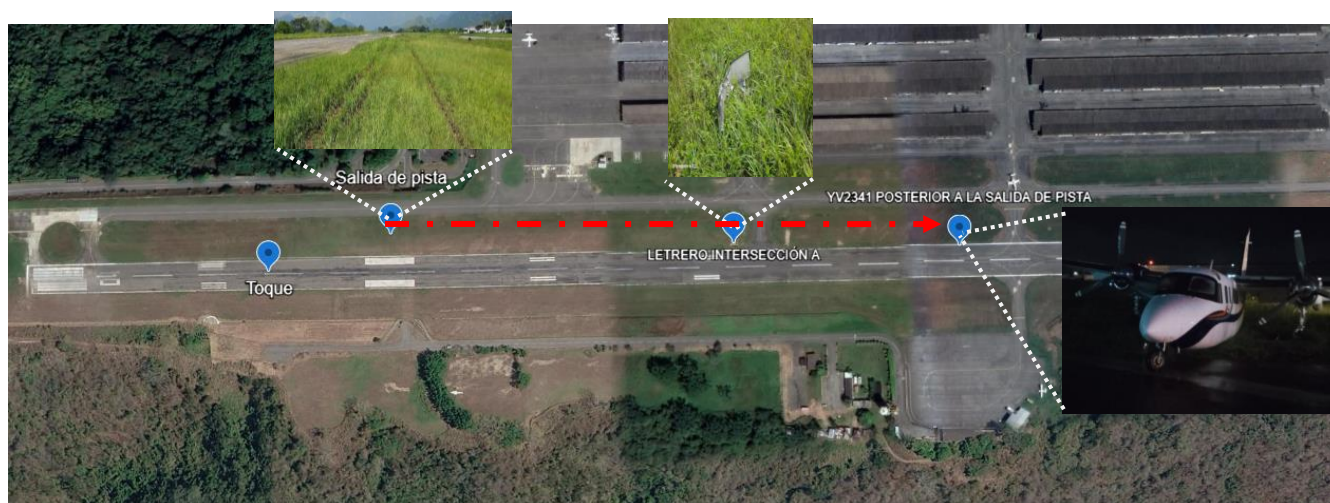
Imagen 2. Referencia recorrido del YV2341 durante la excursión de pista Fuente: Investigador Encargado. Año: 2026
