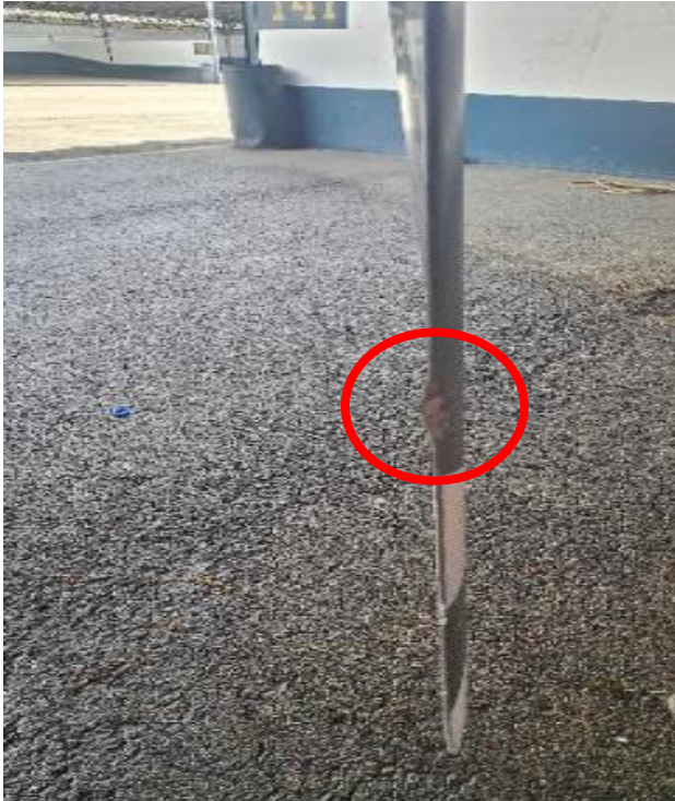
Imagen 15. Daños en las palas de la hélice LH de la aeronave YV2341.
