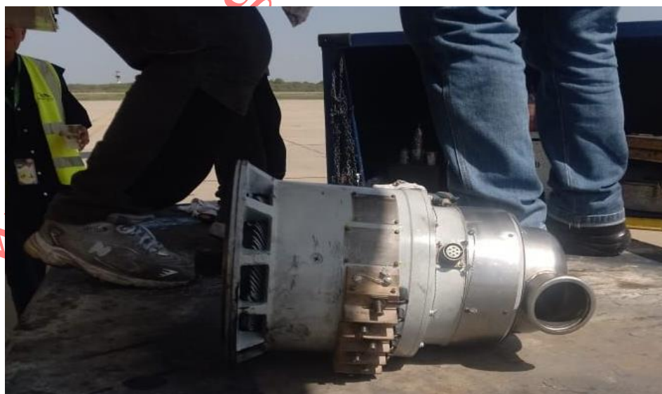
Figura 5. Constant Speed Drive (CSD) removido YV670T. Fuente: Investigador Encargado Año: 2026
