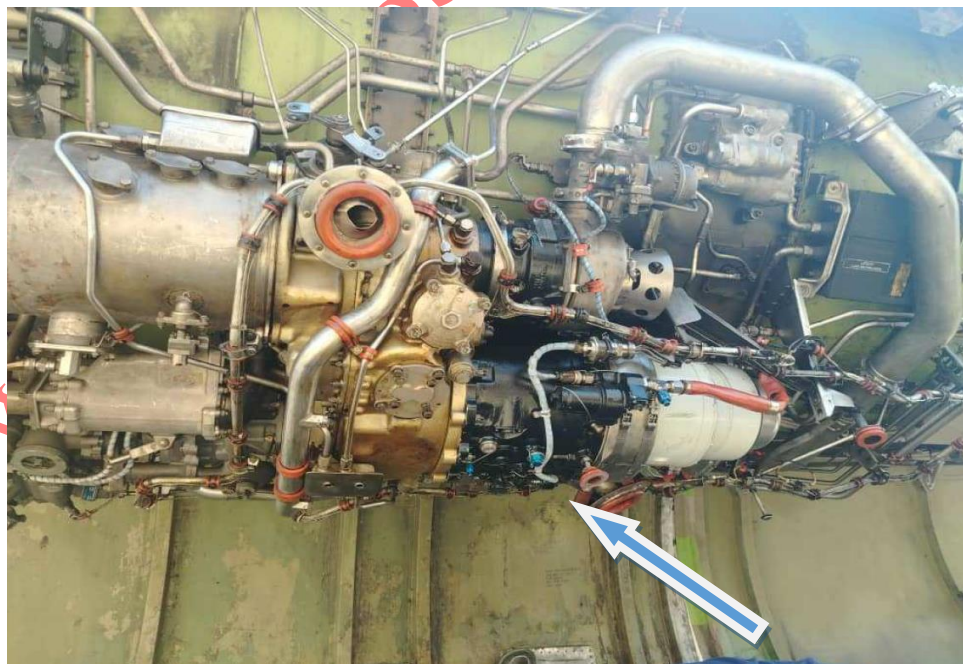
Figura 7. Constant Speed Drive (CSD) instalado YV670T. Fuente: Investigador Encargado Año: 2026
