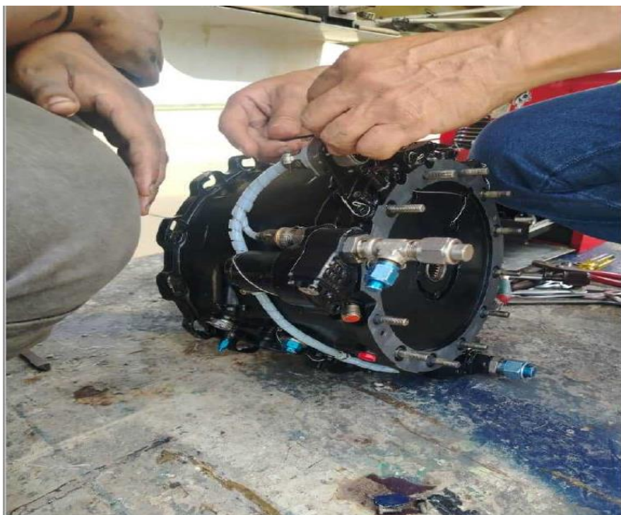
Figura 6. Constant Speed Drive (CSD) de reemplazo YV670T. Fuente: Investigador Encargado Año: 2026
