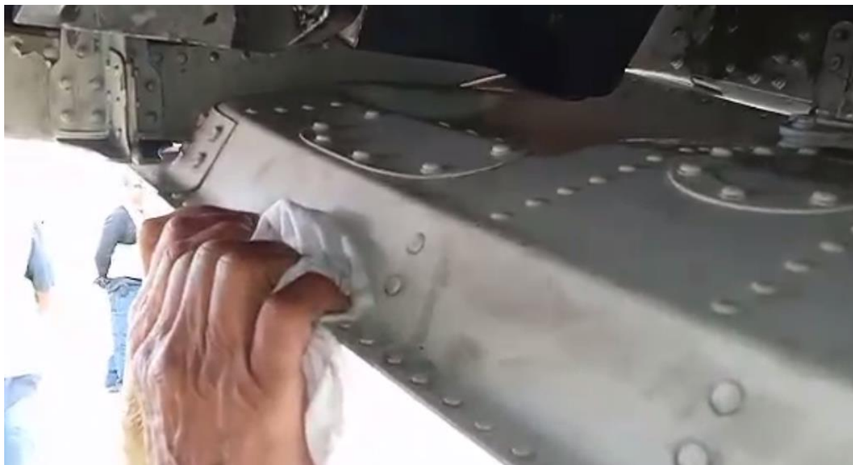
Figura 4. Inspección de la compuerta del tren de nariz luego del reemplazo del actuador, Aeronave YV3145.
