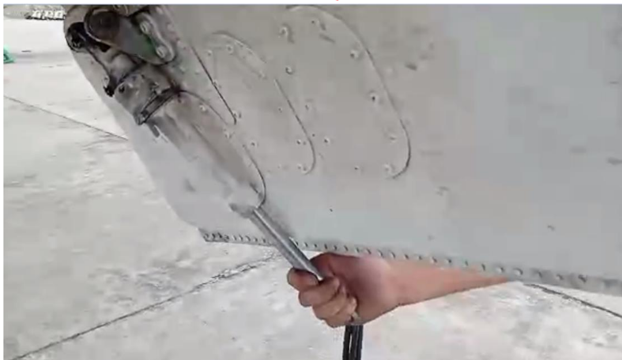
Figura 5. Ajuste de la Compuerta N° 2 tren de nariz Aeronave YV3145.
