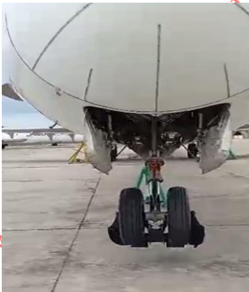
Figura 2. Prueba de retracción del Tren de Nariz, Aeronave YV3145. Fuente: Investigador Encargado. Año: 2026
