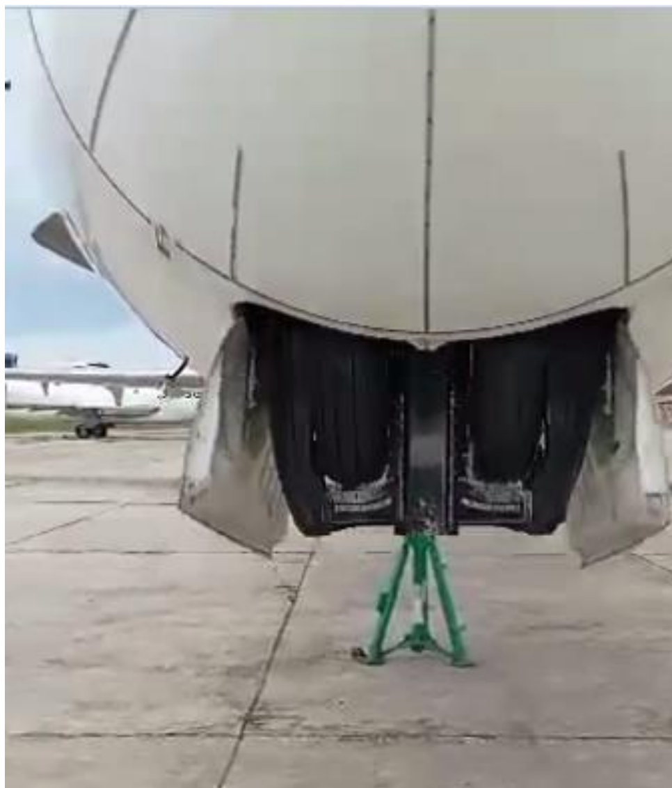
Figura 3. Prueba de extensión del Tren de Nariz Aeronave YV3145 Fuente: Investigador Encargado. Año: 2026
