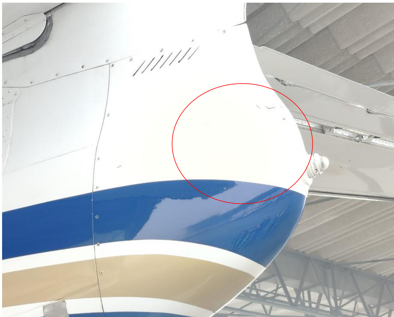
Figura 4. Abolladura en la cola de Timón de la aeronave YV3456 Fuente: Investigador Encargado. Año: 2026
