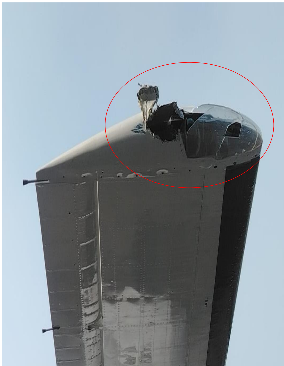
Figura 7. Daño del WING TIP del plano derecho, Aeronave YV2027 Fuente: Investigador Encargado. Año: 2026
