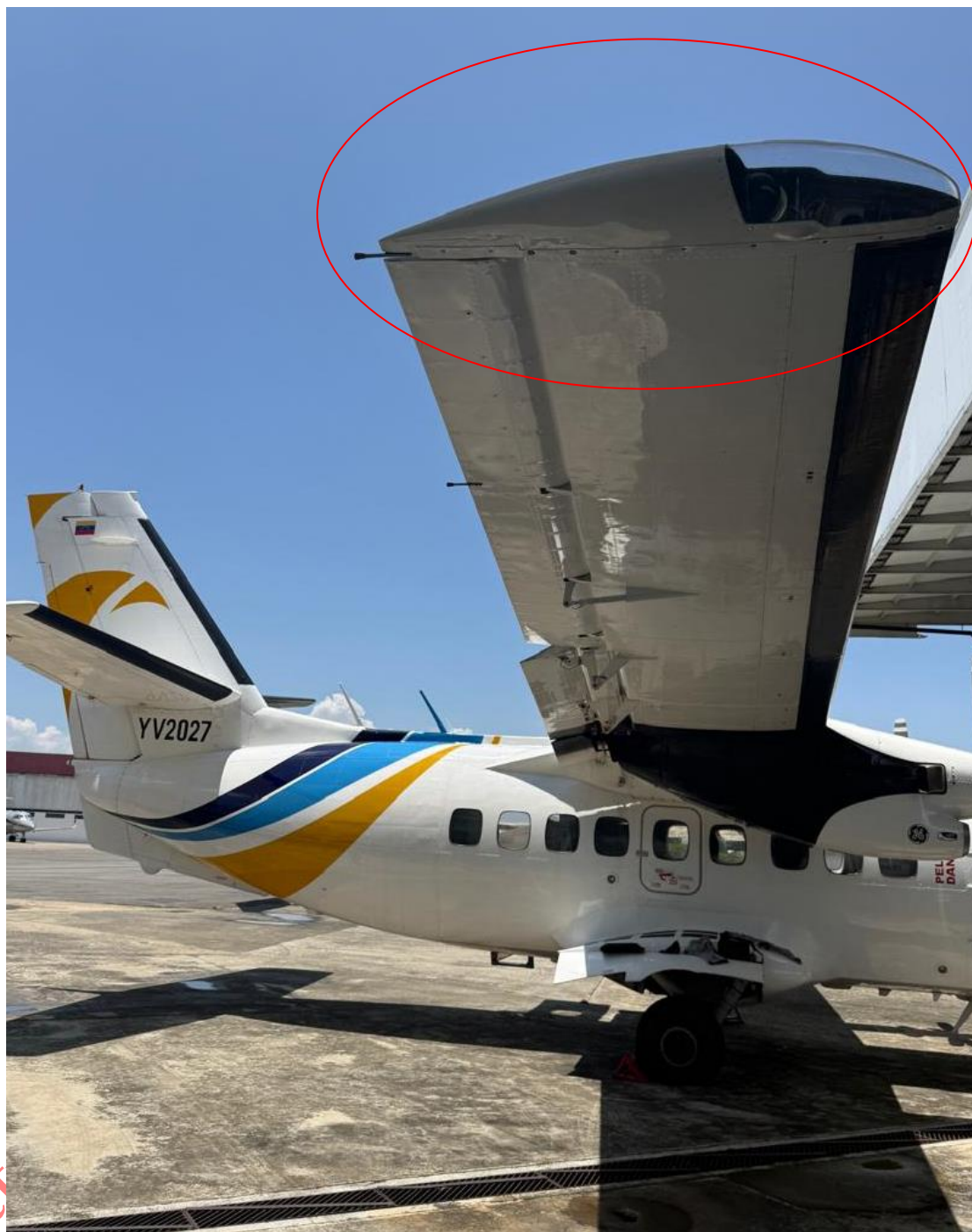
Figura 12. WING TIP reemplazado YV2027 Fuente: Investigador Encargado 2026
