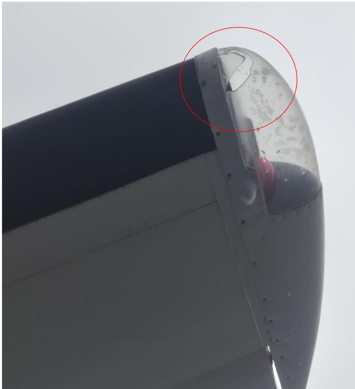
Figura 5. Mica partida de la luz de navegación del plano izquierdo de la aeronave YV2027
