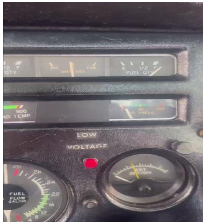
Imagen 3: Indicador de Combustible lado derecho (LLENO) Aeronave XB-BQT Fuente: Investigadora Encargada. Año: 2026.
