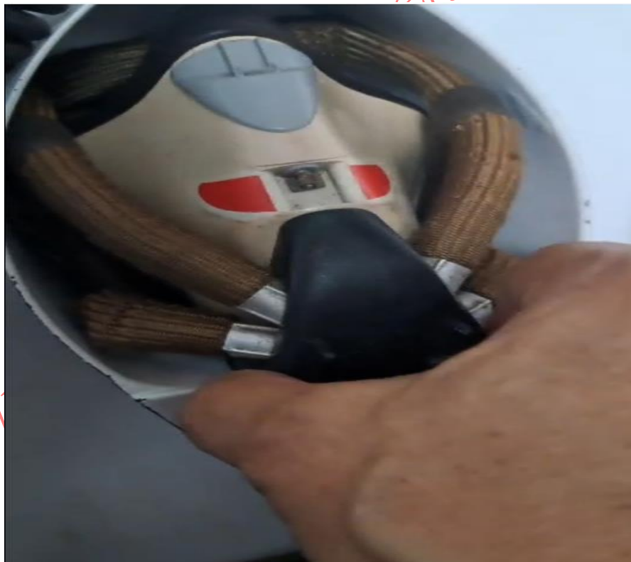
Imagen 12. Prueba para desenganchar la máscara asegurada resultó insatisfactoria YV661T.
