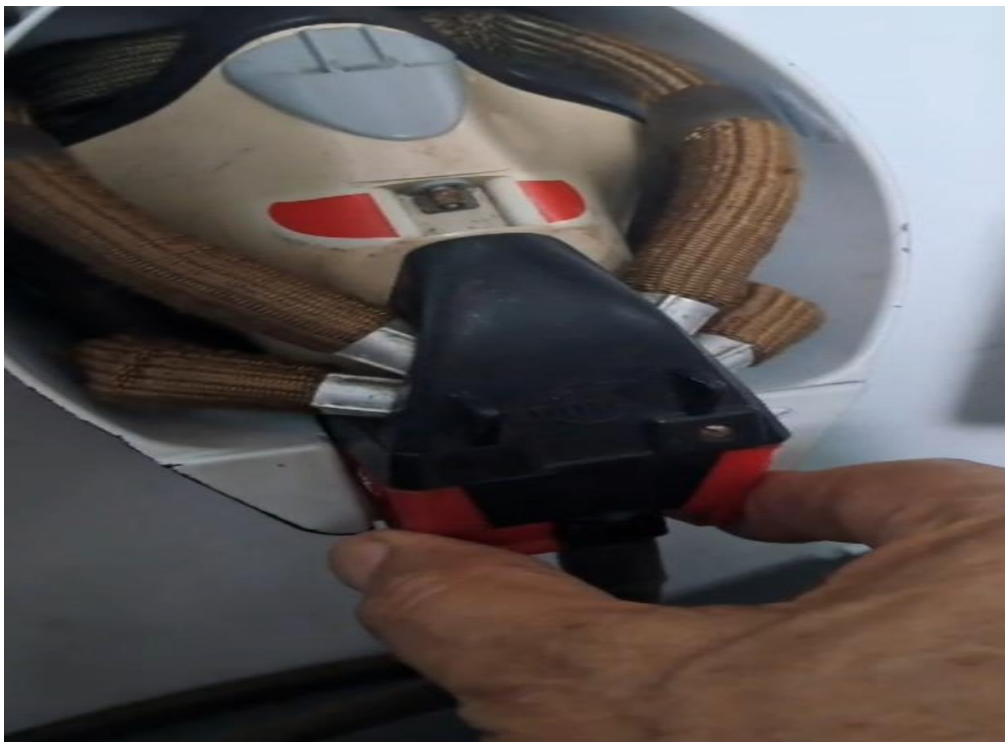
Imagen 13. Procedimiento para desenganchar la máscara presionando las dos pestañas.
