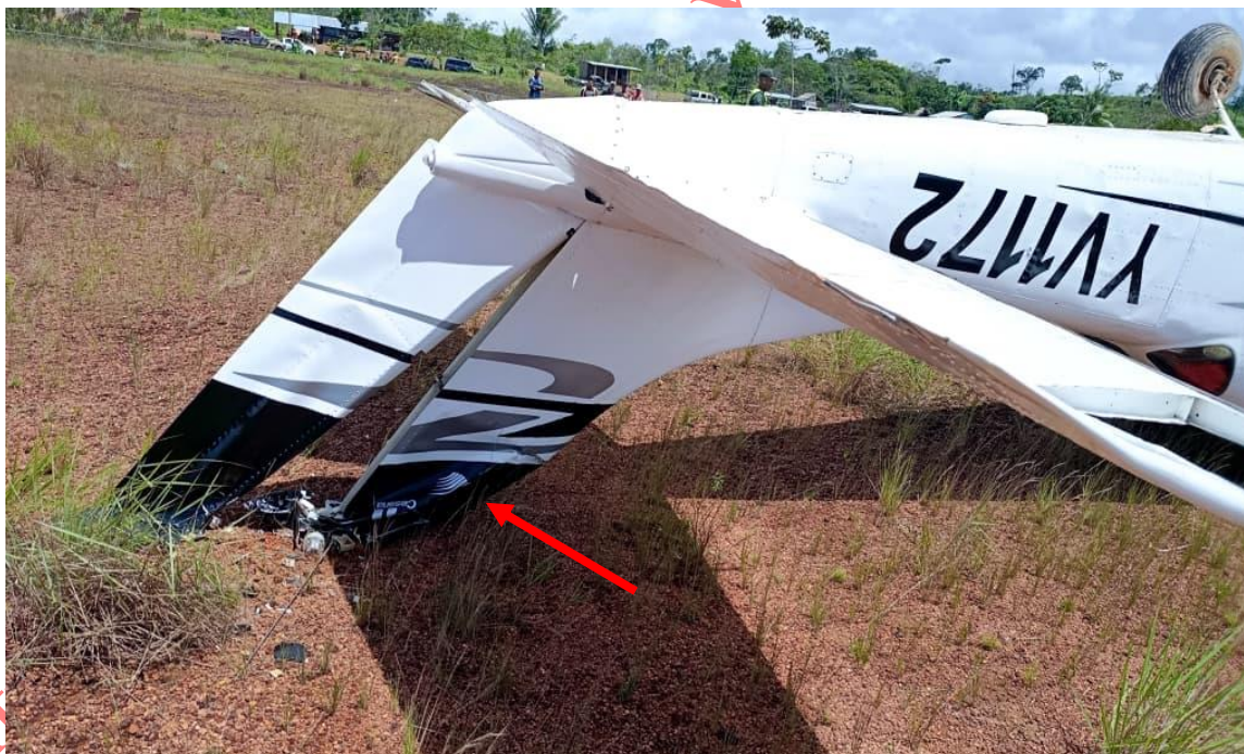
Imagen 7. Daños en el Empenaje, Estabilizador Horizontal, Rudder YV1172.
