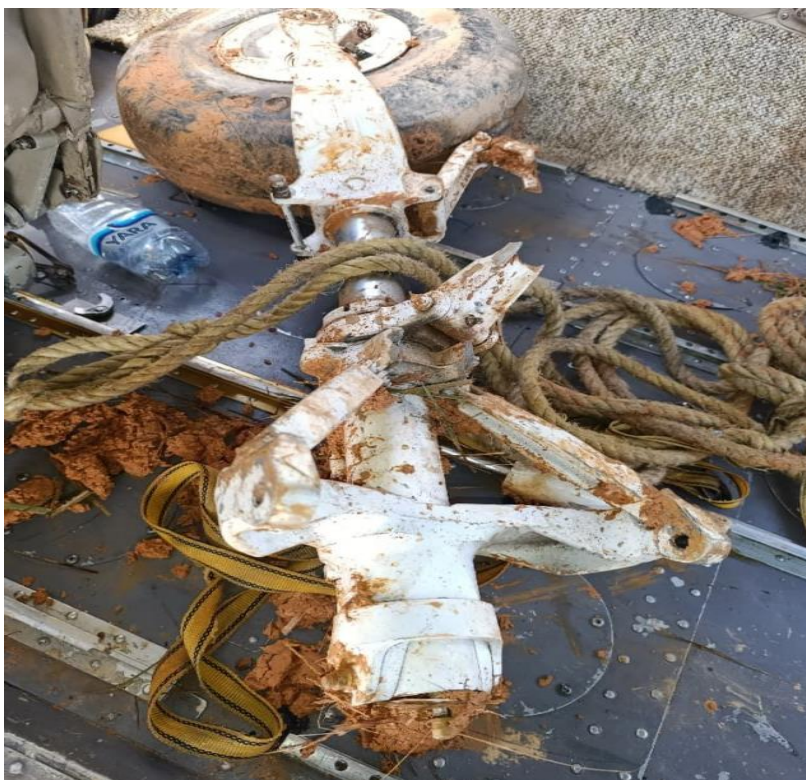
Imagen 13. Tren de Nariz Fracturado YV1172.
