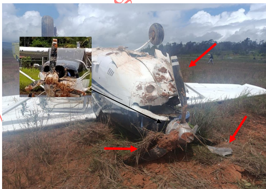
Imagen 5. Daños en las palas YV1172.
