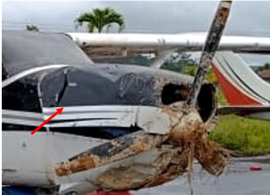
Imagen 9. Capota superior del motor RH presenta daños YV1172.
