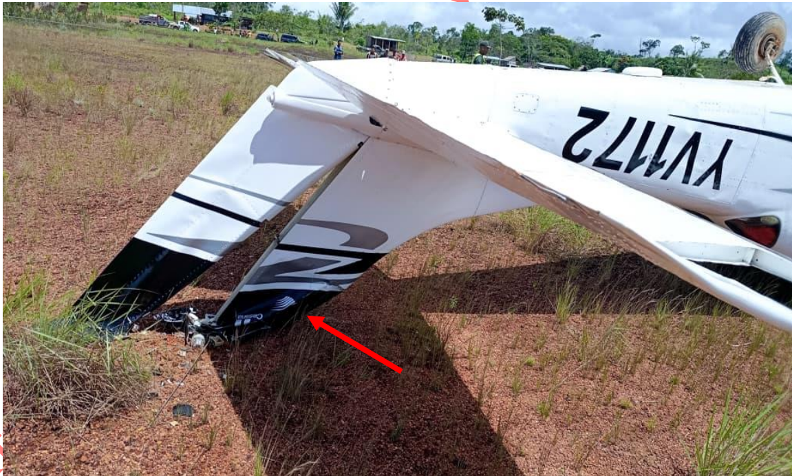
Imagen 7. Daños en el Empenaje, Estabilizador Horizontal, Rudder YV1172. Fuente: Investigador Encargado. Año: 2026.
