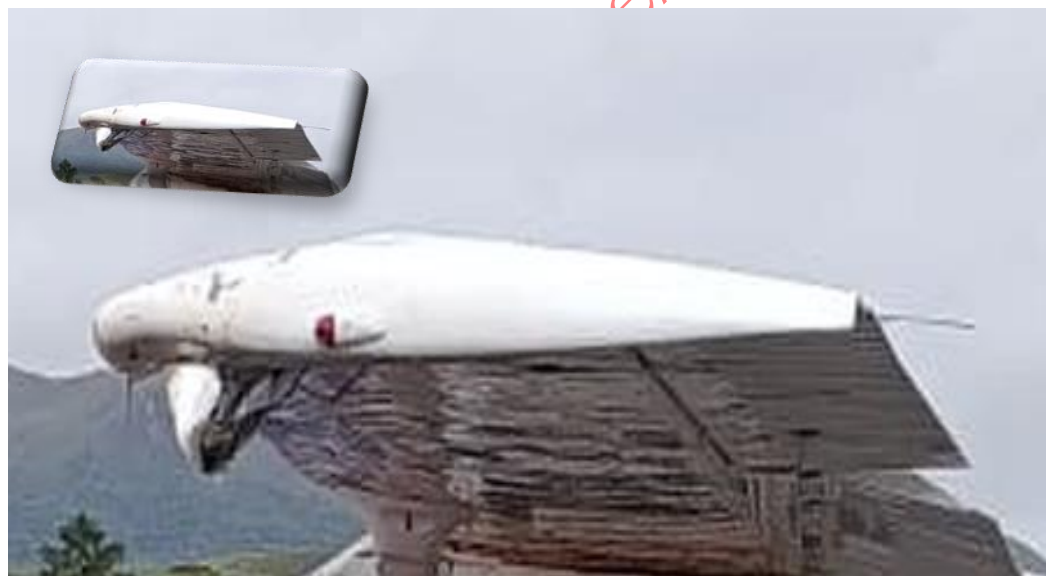
Imagen 12. Daños en el Wing-Tip y borde de ataque plano izquierdo YV1172.
