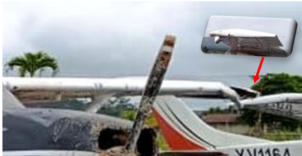
Imagen 11. Daños en el Wing-Tip y borde de ataque plano izquierdo YV1172.
