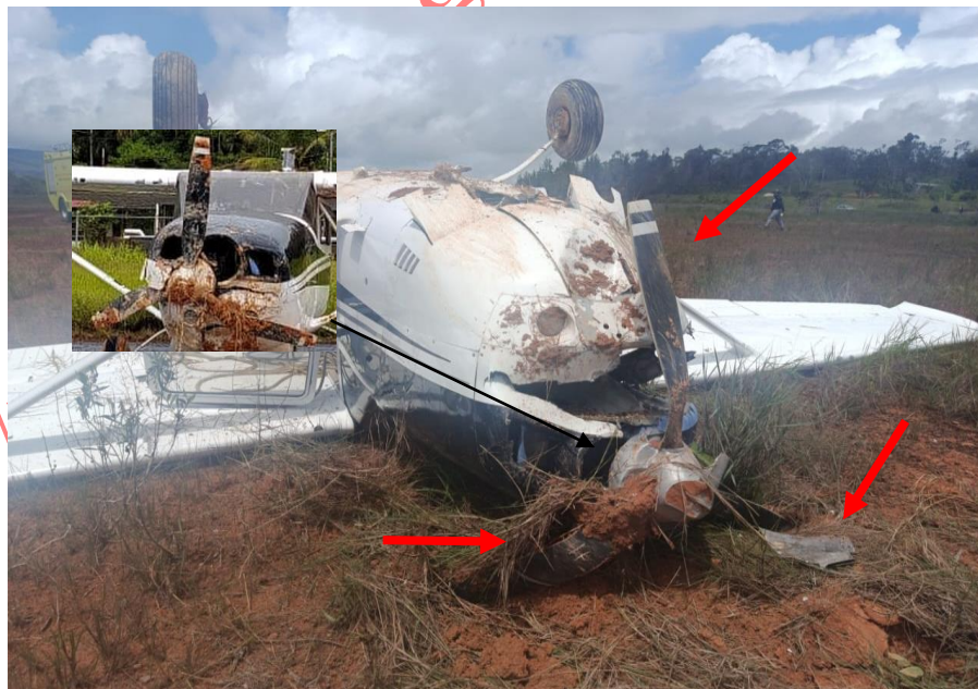
Imagen 5. Daños en las palas YV1172.
