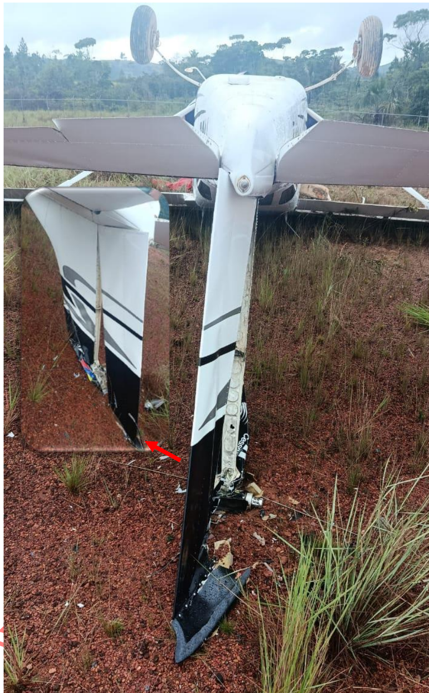
Imagen 8. Daños en el Empenaje, Estabilizador Horizontal, Rudder YV1172.
