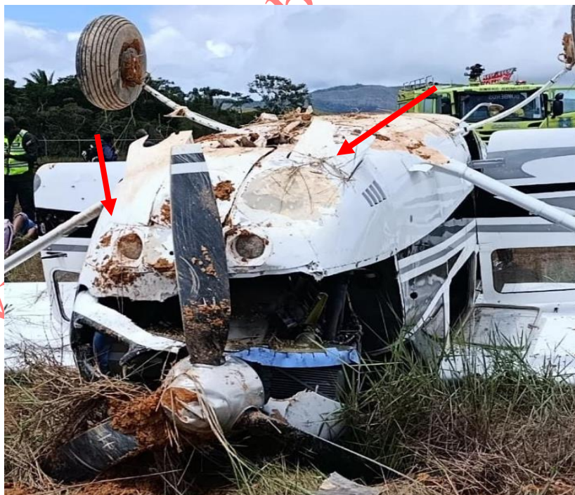
Imagen 10. Fuselaje; lamina lado LH y RH parte delantera estación 18.4, presenta arrugas YV1172.
