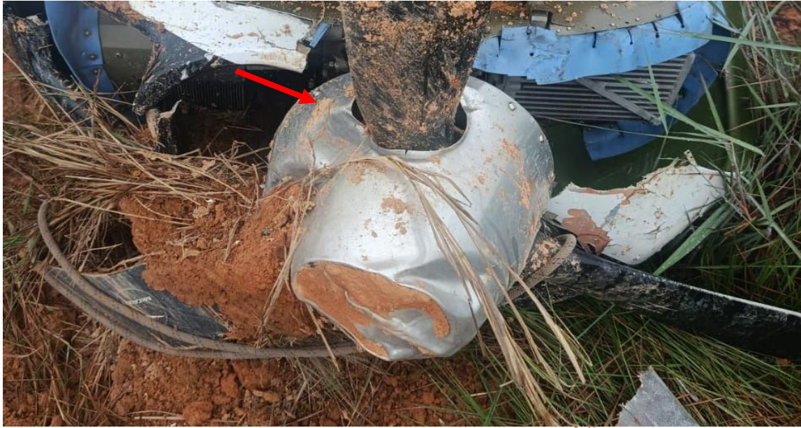
Imagen 6. Daños en el Espiner YV1172. Fuente: Investigador Encargado. Año: 2026.
