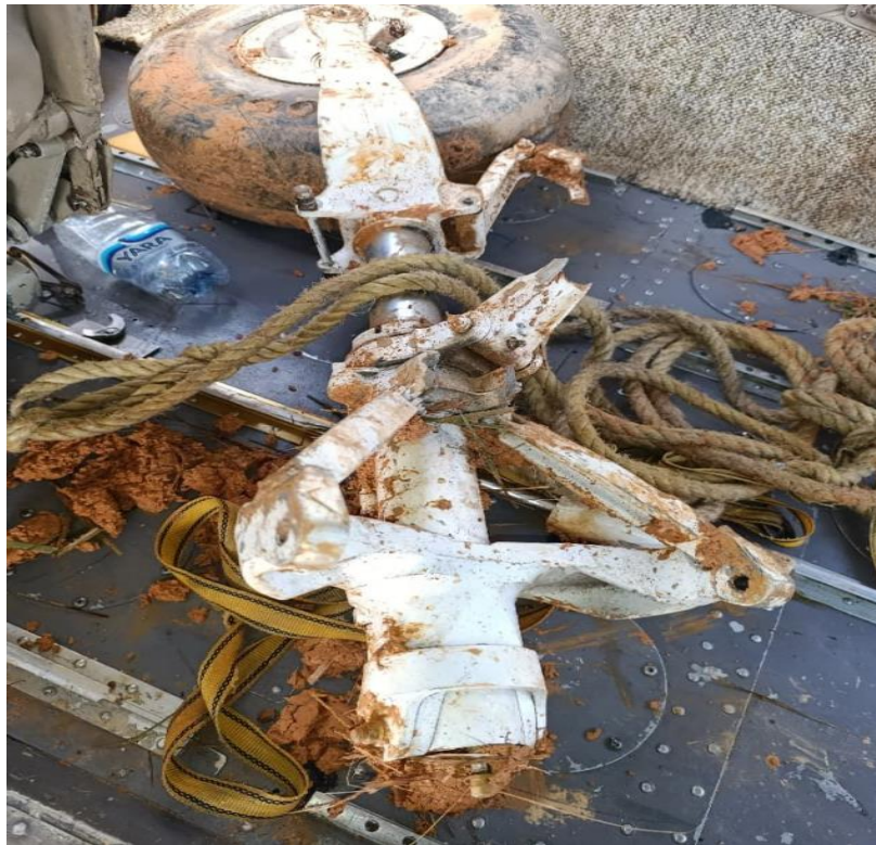
Imagen 13. Tren de Nariz Fracturado YV1172. Fuente: Investigador Encargado. Año: 2026
