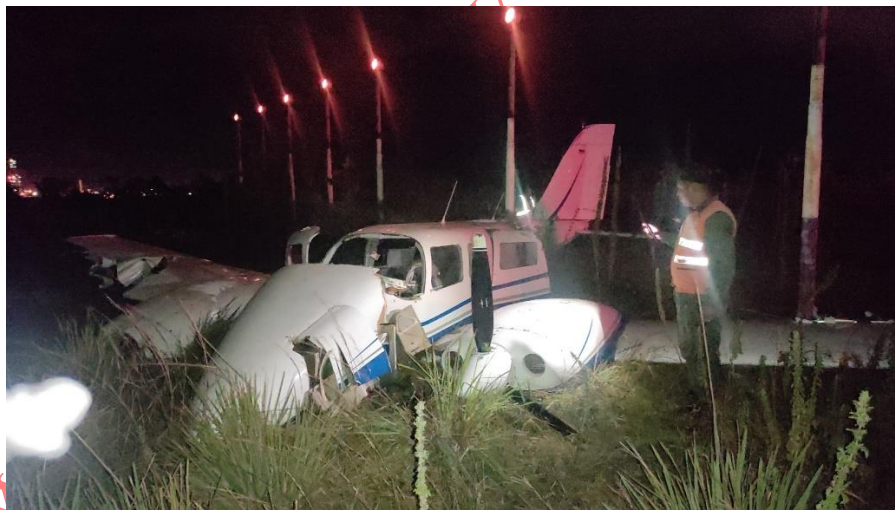
Foto 1. La aeronave yace en el terreno con el fuselaje delantero destruido, desprendimiento de la hélice derecha, el ala izquierda rasgada por un poste de alumbrado. Se observan las luces del sistema de alumbrado de aproximación encendidas.
