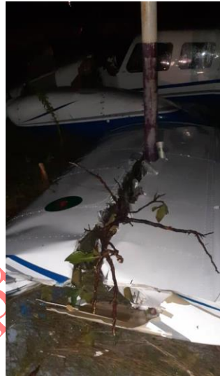
Foto 3. Ala izquierda que impactó en tierra un poste de alumbrado de aproximación, siendo rasgada desde su extremo hasta un tercio de la envergadura.
