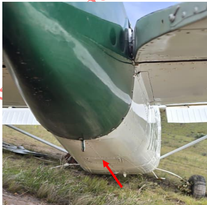
Imagen 12. Laminado parte trasera no presento daños YV1665.
