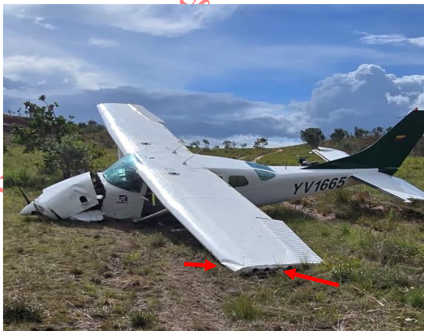
Imagen 8. Daños en el Wing-Tip y borde de ataque plano izquierdo YV1665.
