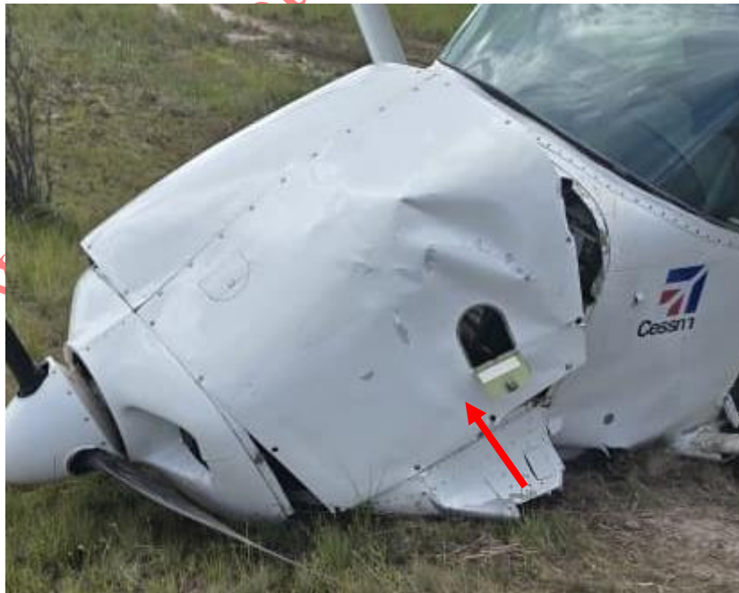
Imagen 10. Capota superior del motor LH presenta daños YV1665.
