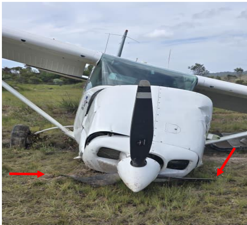
Imagen 5. Daños en dos Palas, YV1665.
