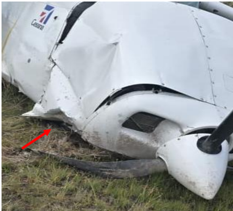
Imagen 11. Capota superior del motor RH presenta daños YV1665.
