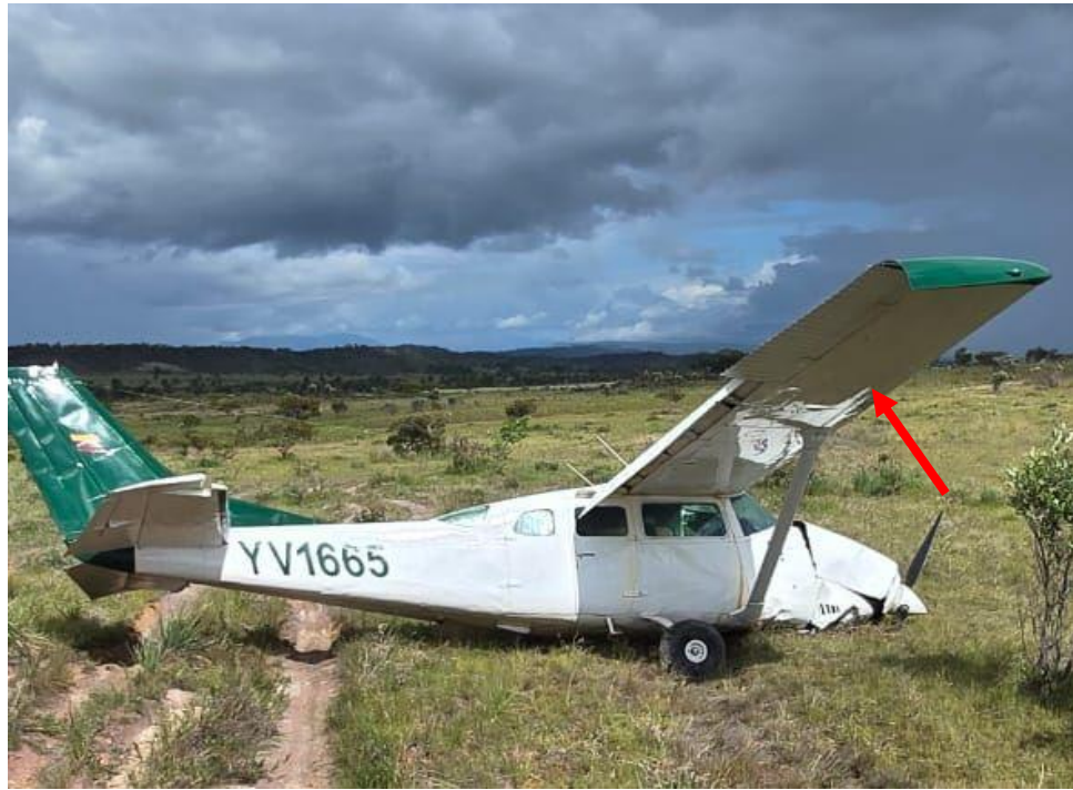
Imagen 9. Plano derecho sin daños YV1665.
