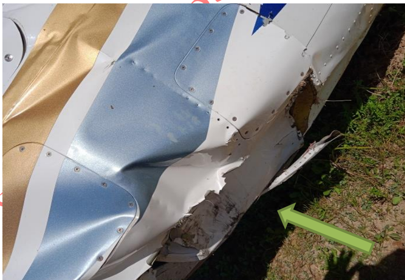
Figura 11. Daños en el fuselaje, Aeronave YV1473 Fuente: Investigador Encargado. Año: 2023
