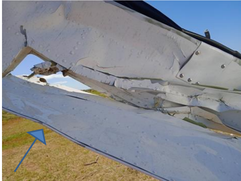
Figura 12. Daños en el plano, Aeronave YV1473 Fuente: Investigador Encargado. Año: 2023
