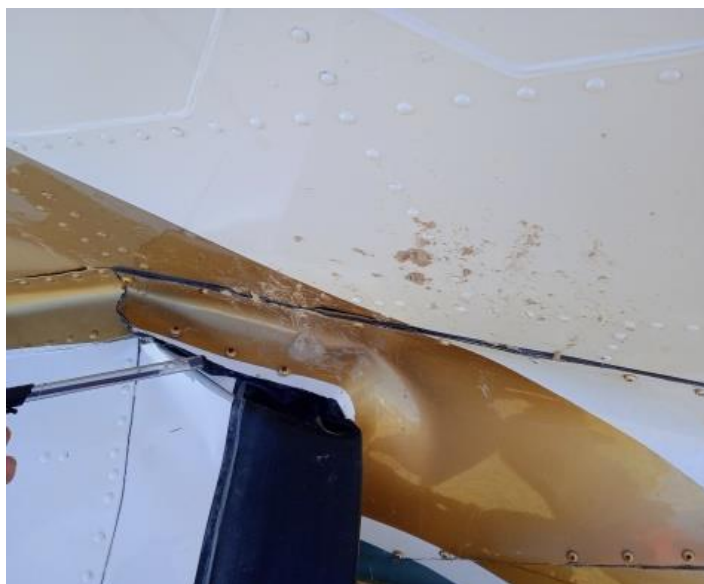
Figura 10. Daños en el empenaje, Aeronave YV1473 Fuente: Investigador Encargado. Año: 2023
