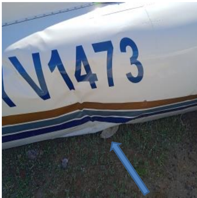
Figura 8. Daños en el fuselaje, Aeronave YV1473 Fuente: Investigador Encargado. Año: 2023
