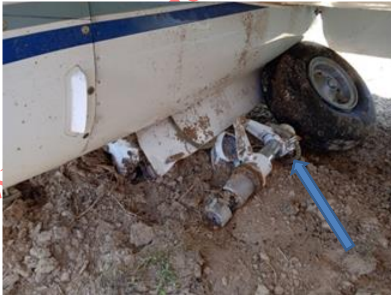
Figura 7. Daños tren principal izquierdo, Aeronave YV1473 Fuente: Investigador Encargado. Año: 2023
