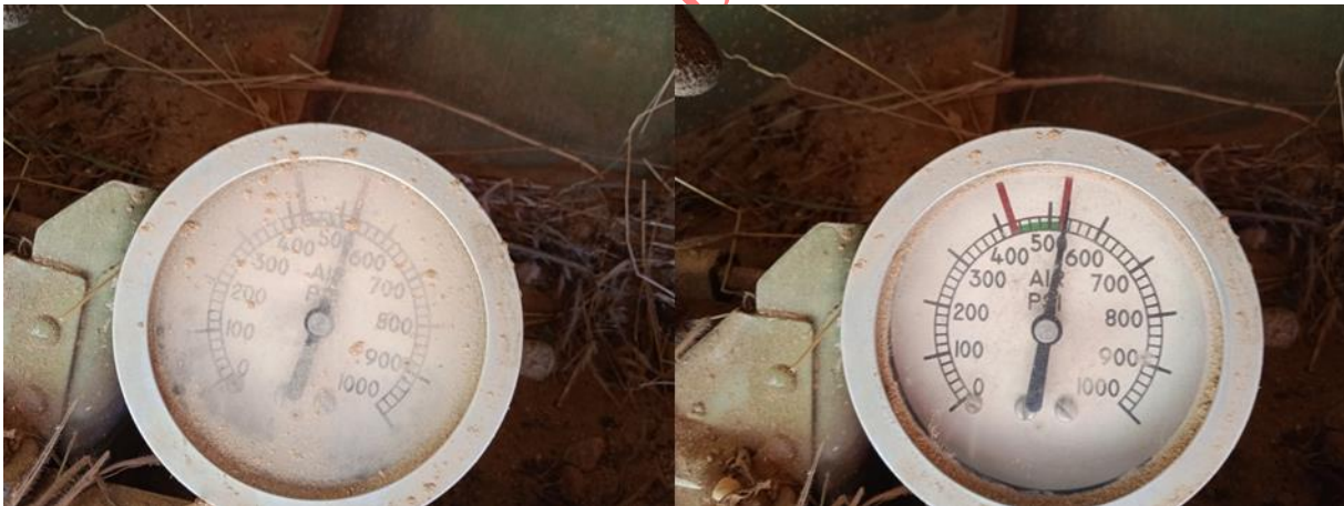
Figura 17. Carga de Cilindro de Nitrógeno, Aeronave YV1473 Fuente: Investigador Encargado. Año: 2023
