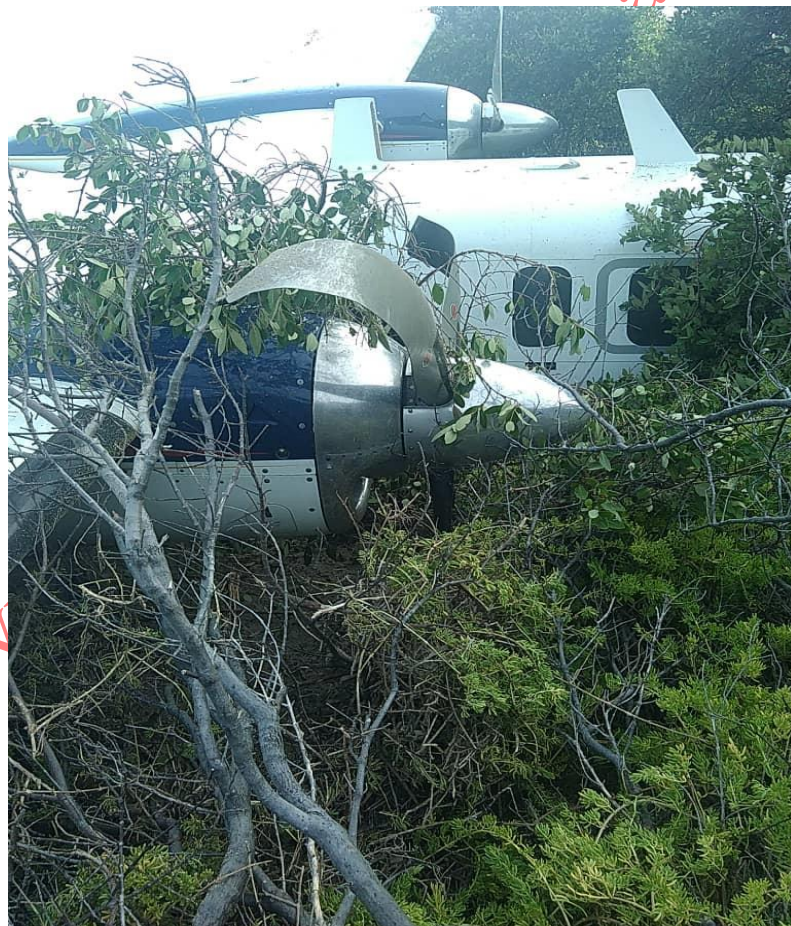
Imagen 2: Daños en las palas del motor derecho.
