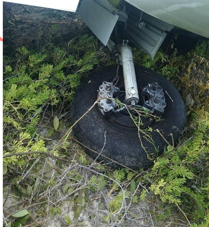
Imagen 5 y 6: Condición de los trenes de aterrizaje principales de la aeronave YVO112
