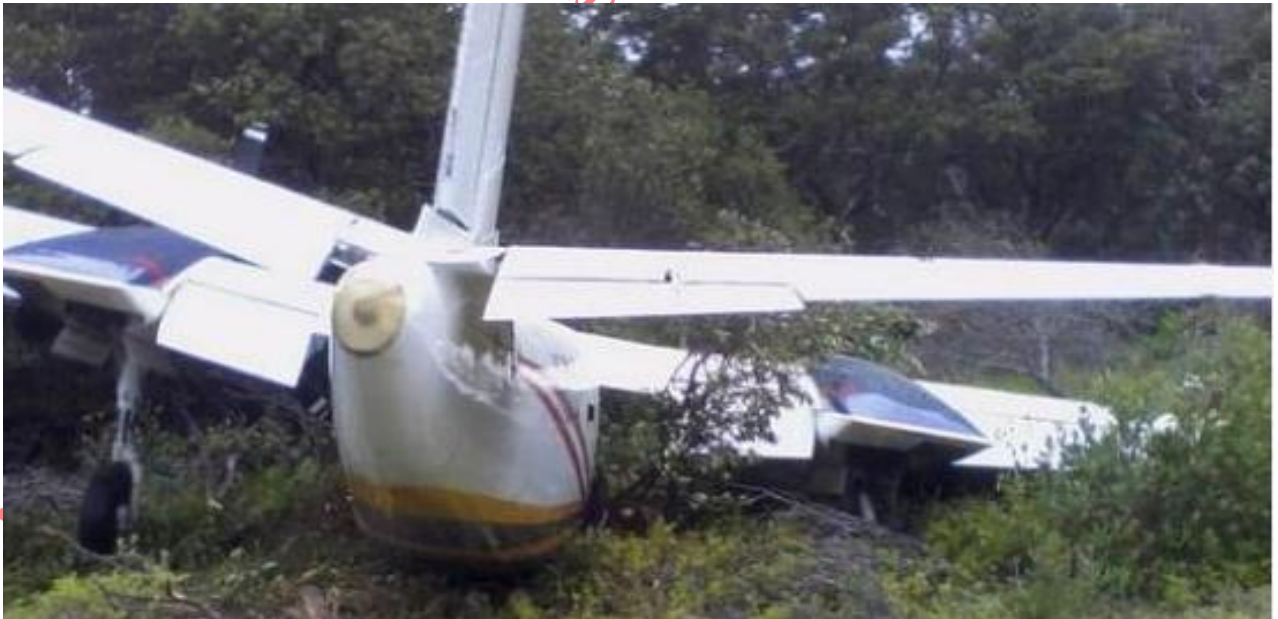
Imagen 4: Daños en el plano derecho y tren principal derecho.
