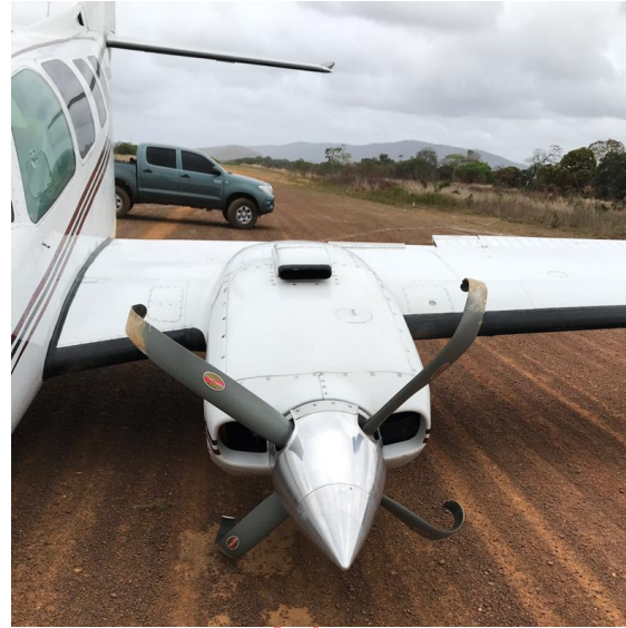
Imagen 4 y 5: Torsión en las palas de las hélices de ambos motores, Aeronave YV3162
