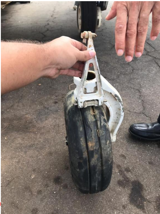
Imagen 6 y 7: Tren de aterrizaje fracturado, Aeronave YV3162
