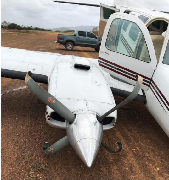
Imagen 4 y 5: Torsión en las palas de las hélices de ambos motores, Aeronave YV3162
