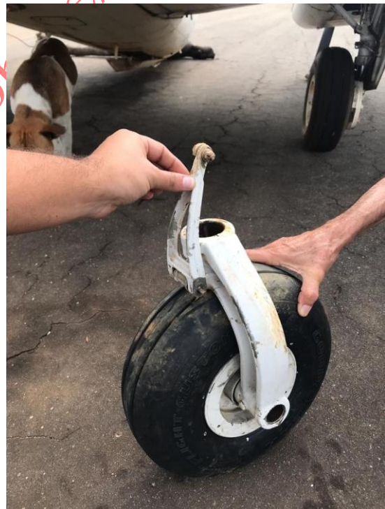
Imagen 6 y 7: Tren de aterrizaje fracturado, Aeronave YV3162
