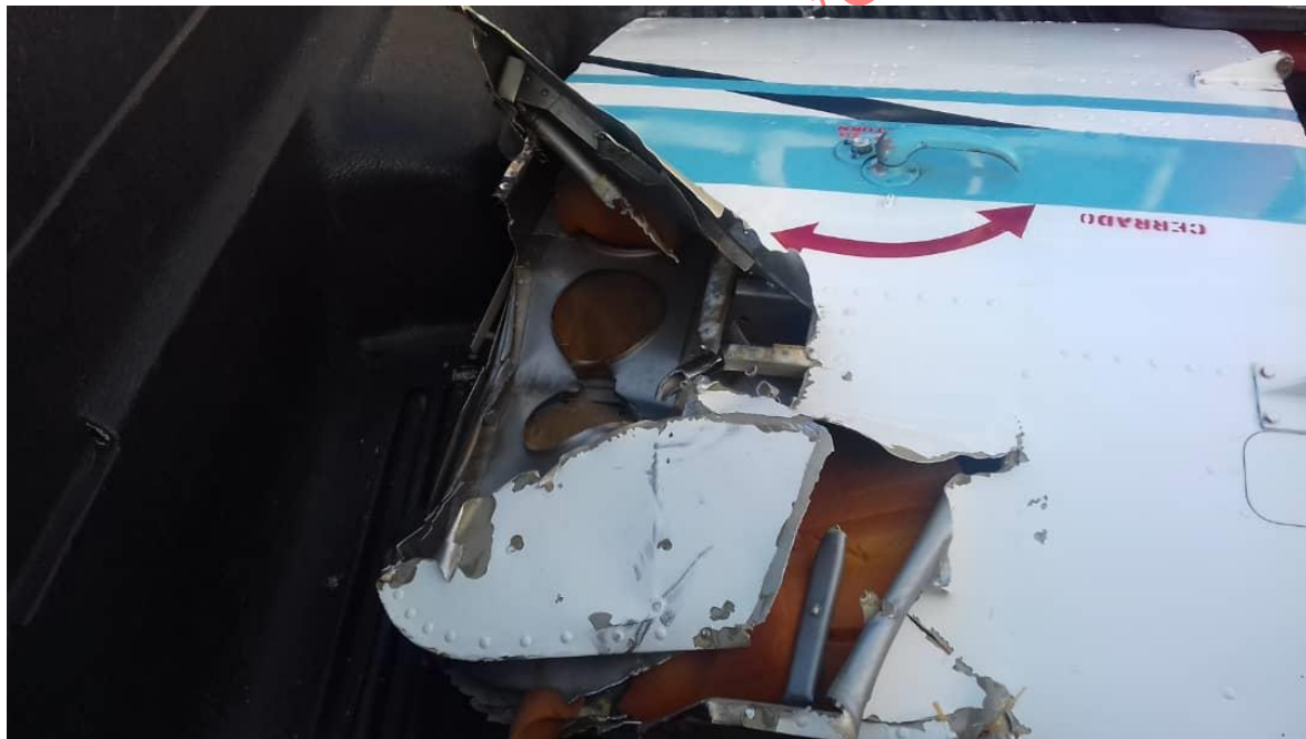
Imagen 3: Daños en la compuerta del YV1844
