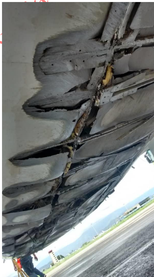
Imagen 4 y 5: Daños en el Fuselaje, Aeronave YV3275
