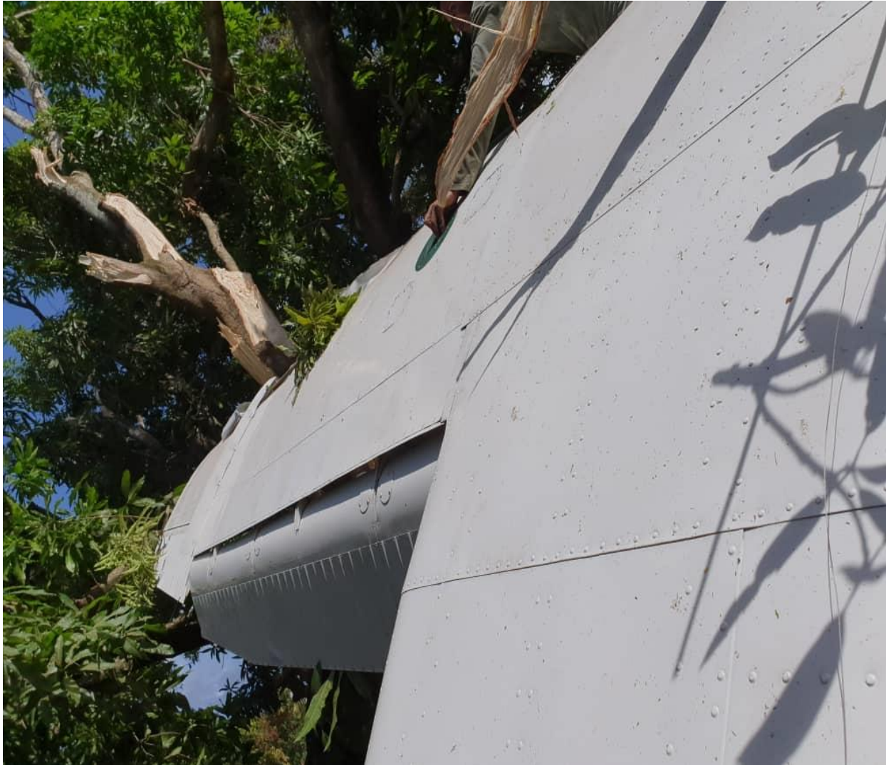
Imagen 5: Daños en el Plano Derecho, Aeronave YV1860
