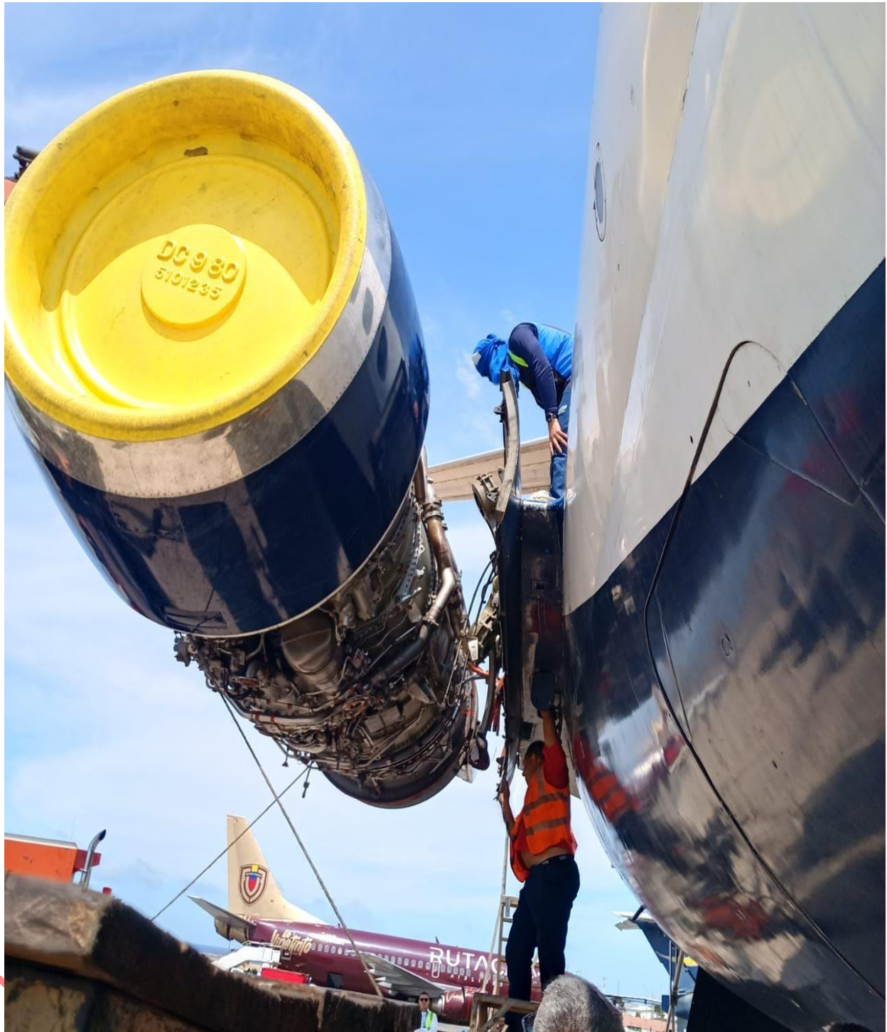
Figura 4. Instalación del motor, aeronave YV3499. Fuente: Investigador Encargado. Año: 2026
