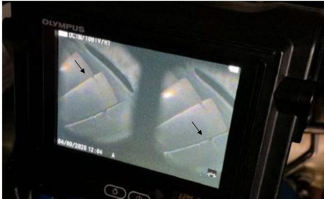
Figura 10. Daños (Nick), en la mayoría de los bordes de ataque de los álabes YV3499. Fuente: Investigador Encargado. Año: 2026
