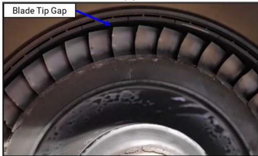
Imagen 33. Huevo en la punta de las palas de la turbina de alta presión mayor de lo normal.
