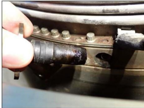
Imagen 25. Fractured P3 Cooling Air Flange Fuente: Fabricante Año: 2022
