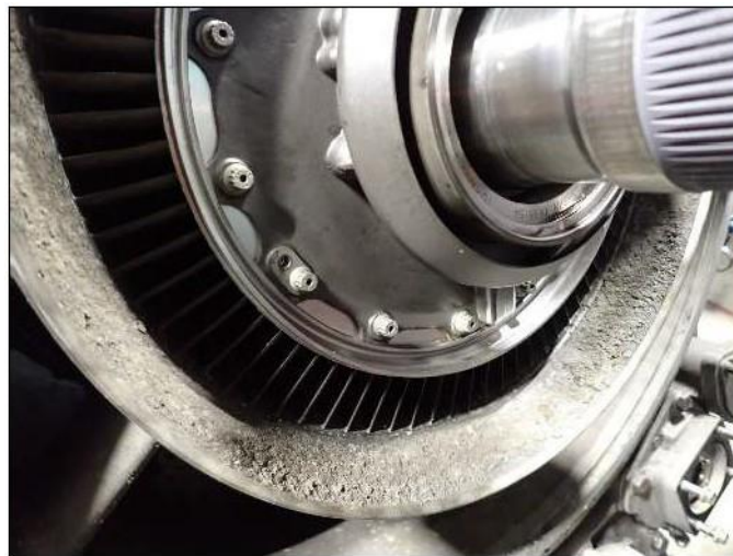
Imagen 38 Corrosión del sello de aire exterior del rotor de presión intermedio Fuente: Fabricante Año: 2022
