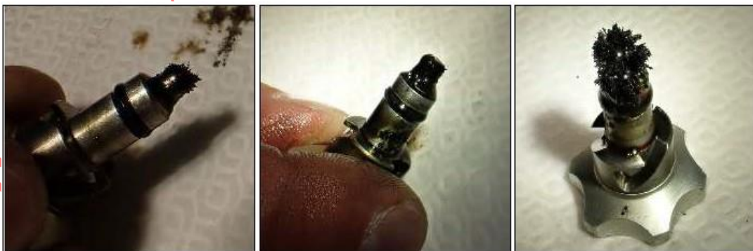
Imagen 24. Drenaje del tanque (izquierda), caja de cambios (centro). y No. 3/No. 4 detectores de virutas de barrido (derecha)
