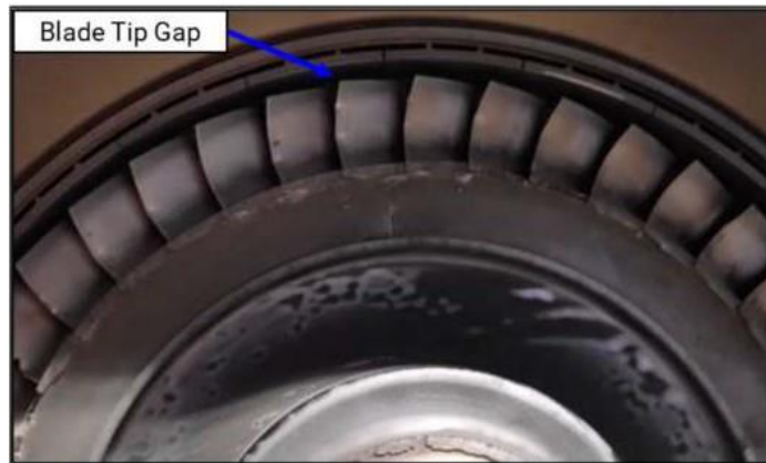
Imagen 29 Separación de la punta de la pala de la turbina de alta presión más grande de lo normal
