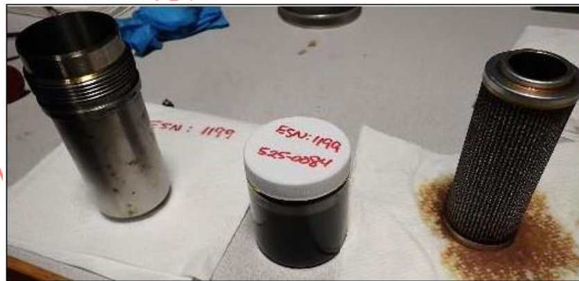
Imagen 21 Recipiente de llenado de aceite, muestra de aceite y filtro del motor izquierdo N1
