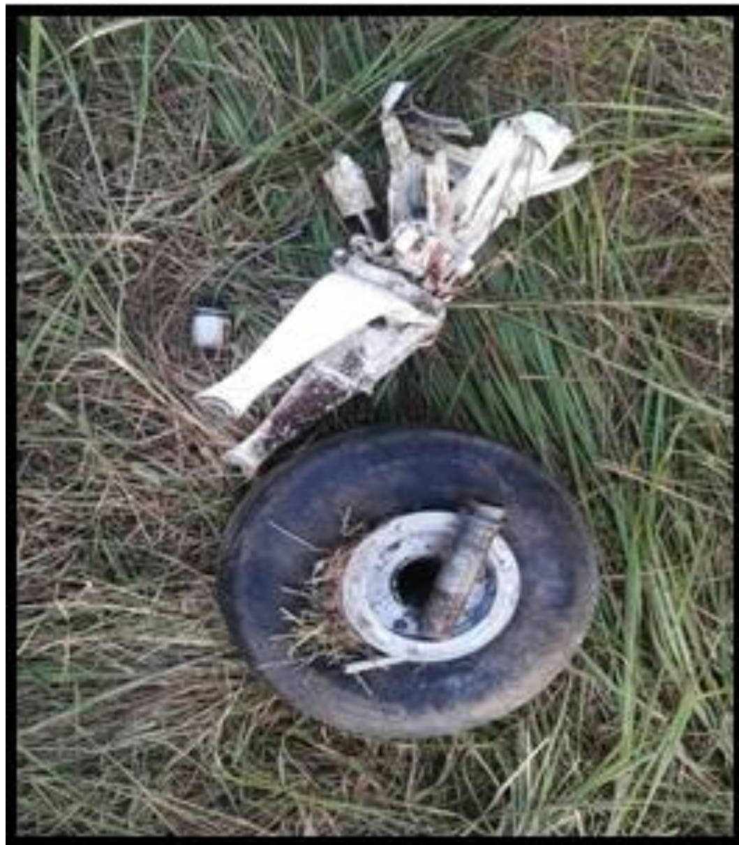
Imagen 7. Tren de aterrizaje fracturado, YV1154 Fuente: Investigador Encargado Año: 2023
