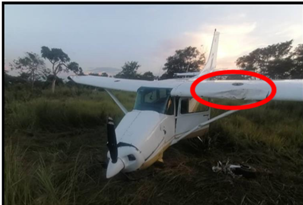
Imagen 3: Torcedura y arruga en el plano izquierdo, YV1154 Fuente: Investigador Encargado. Año: 2023
