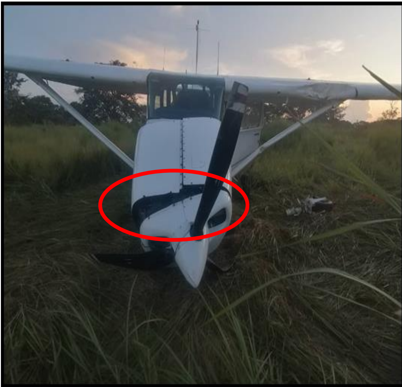
Imagen 5. Desprendimiento del fuselaje Fuente: Investigador Encargado. Año: 2023
