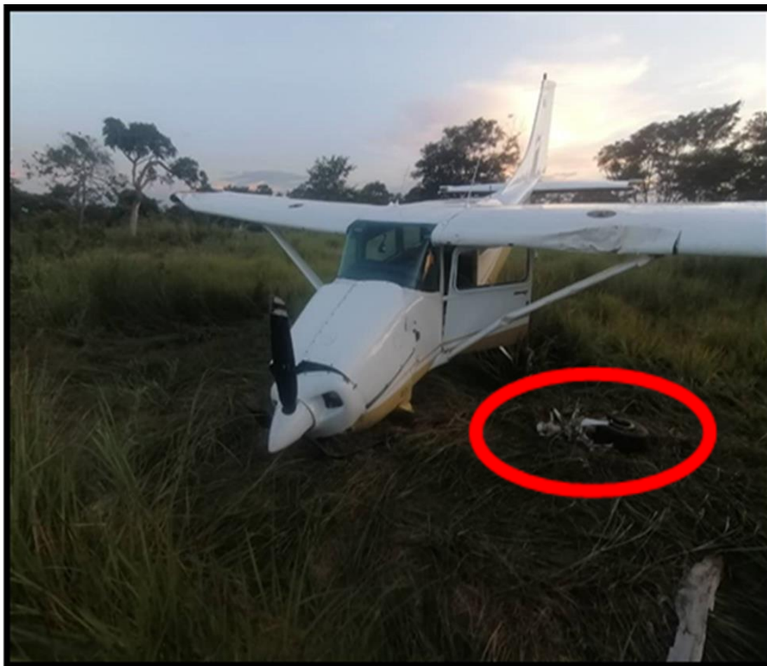
Imagen 4: Desprendimiento del tren de nariz del anclaje del fuselaje Fuente: Investigador Encargado. Año: 2023
