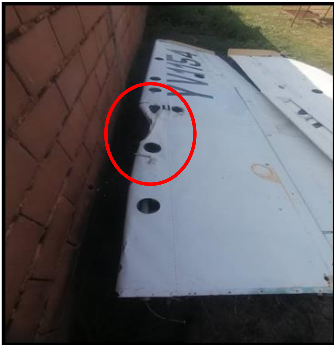
Imagen 12. Plano izquierdo con torceduras y arruga Fuente: Investigador encargado. Año: 2023
