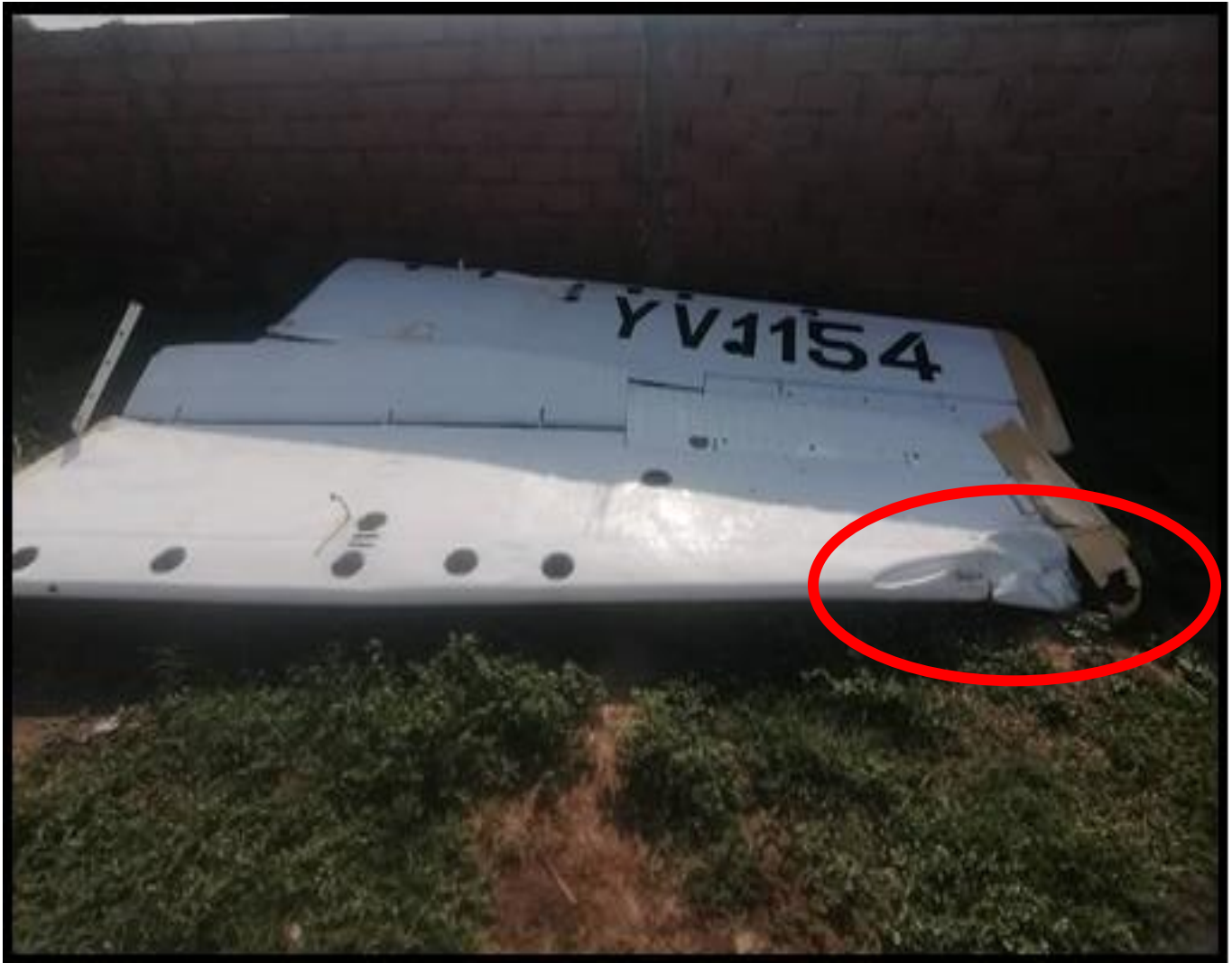
Imagen 11. Plano derecho con torceduras y arruga Fuente: Investigador encargado. Año: 2023
