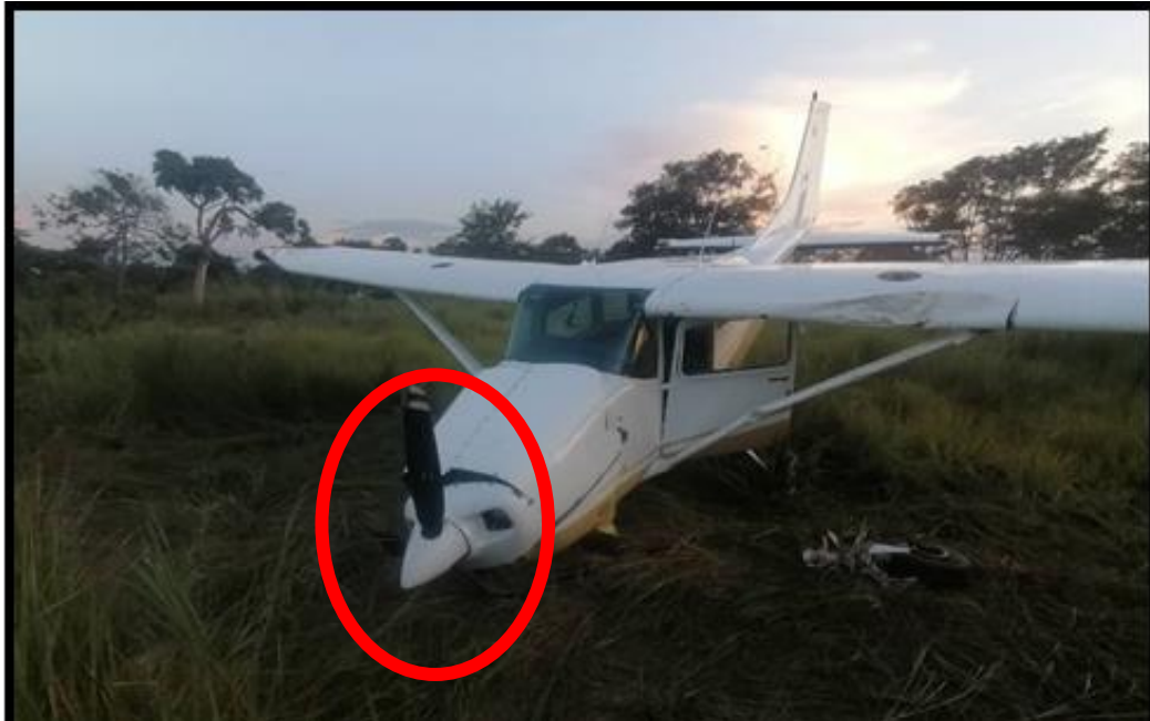
Imagen 2: Daños en las palas YV1154 Fuente: Investigador Encargado. Año: 2023
