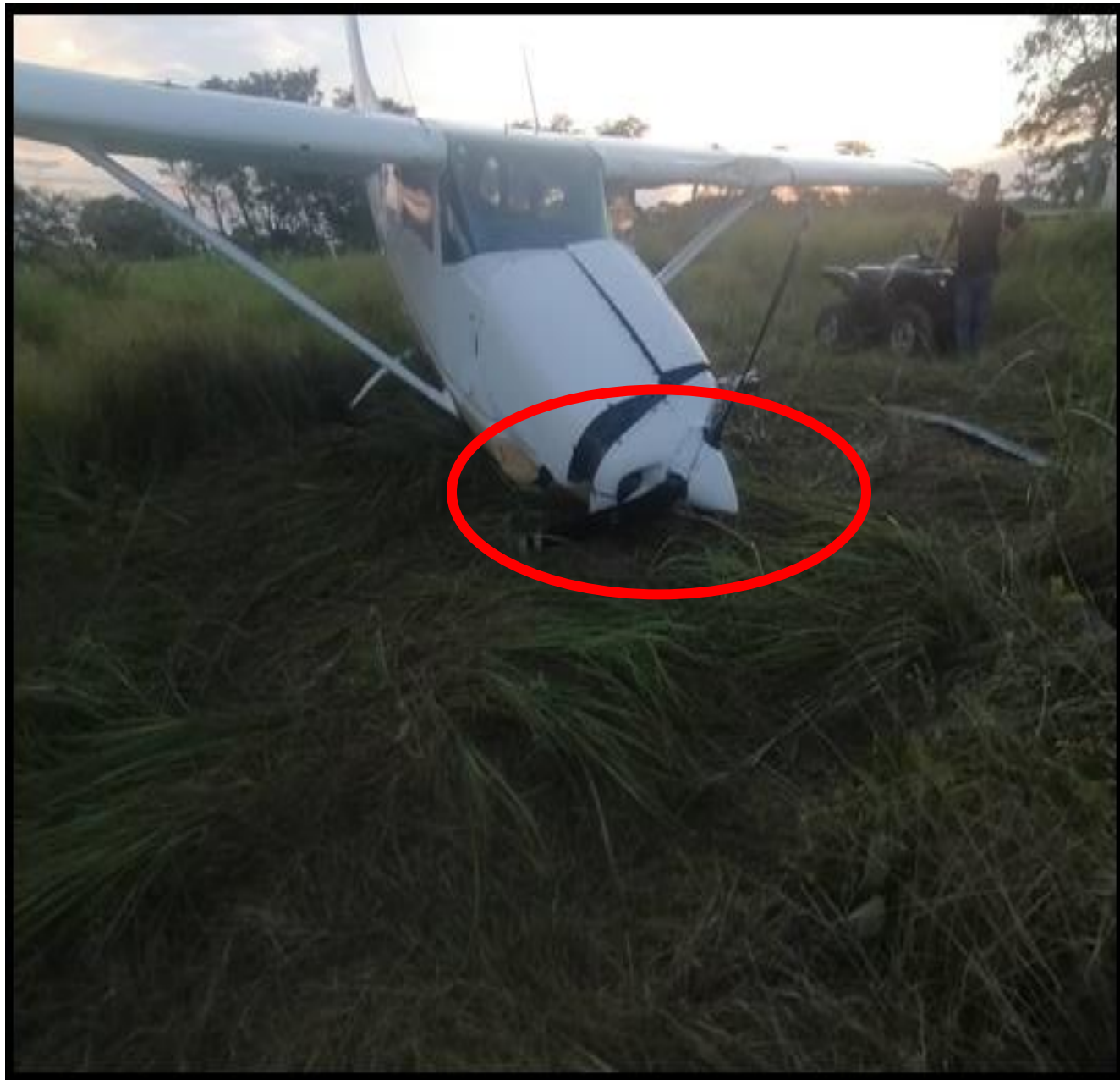
Imagen 6: Daños en el área del motor de la aeronave Fuente: Investigador Encargado Año: 2023
