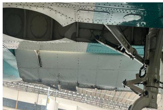
Imagen 10. Daños en el borde de ataque (vista frontal y posterior) Fuente: Investigador Encargado. Año: 2022.
