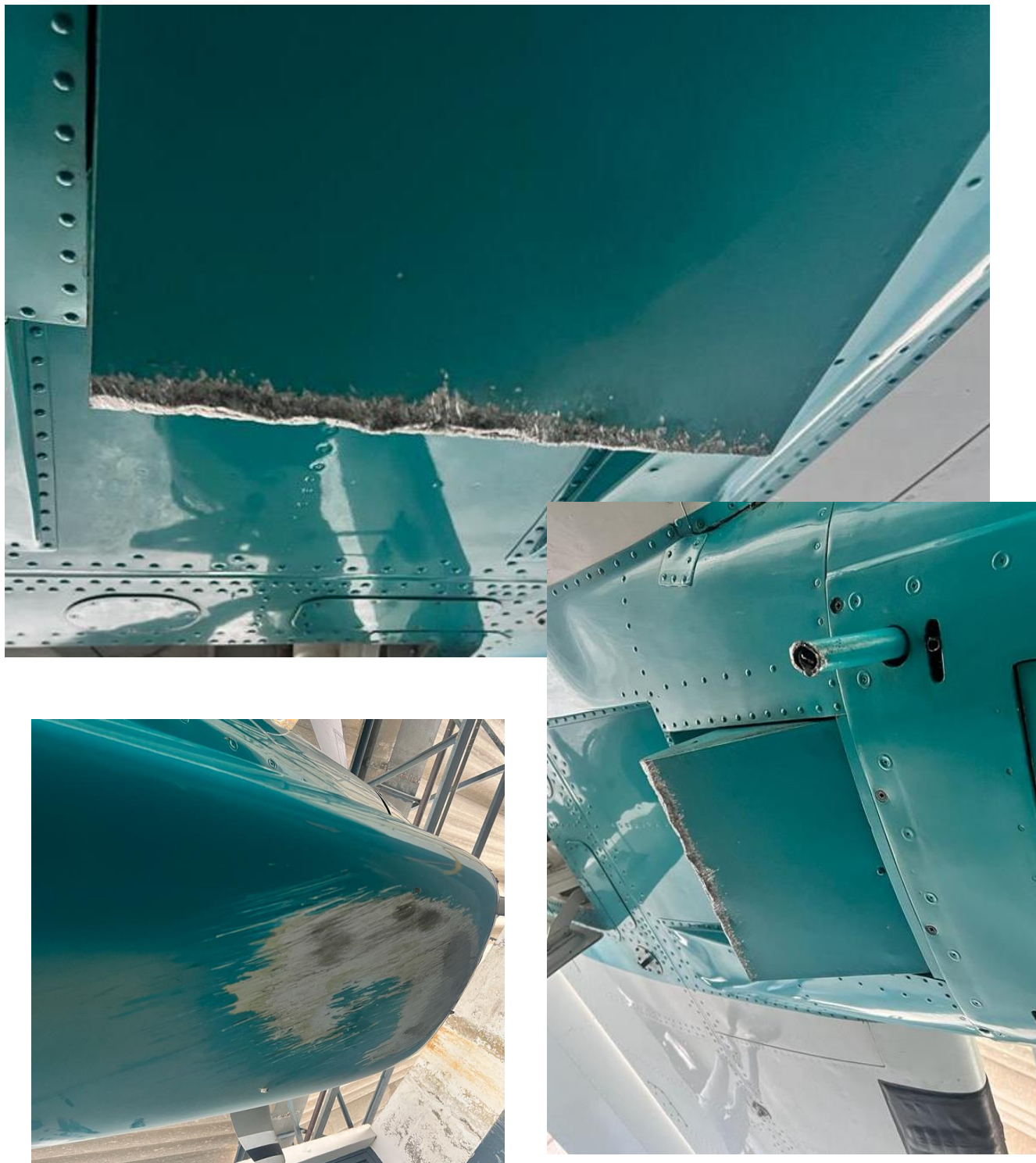
Imagen 9. Daños en la parte inferior del fuselaje Fuente: Investigador Encargado. Año: 2022.
