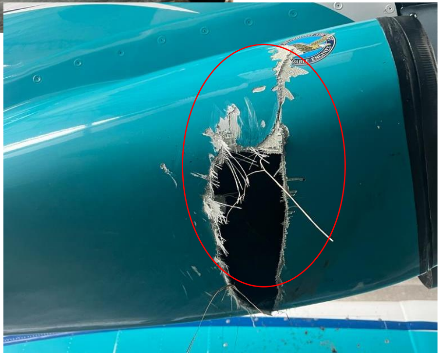
Imagen 11. Daños en la capota del motor derecho (RH) Fuente: Investigador Encargado. Año: 2022.
