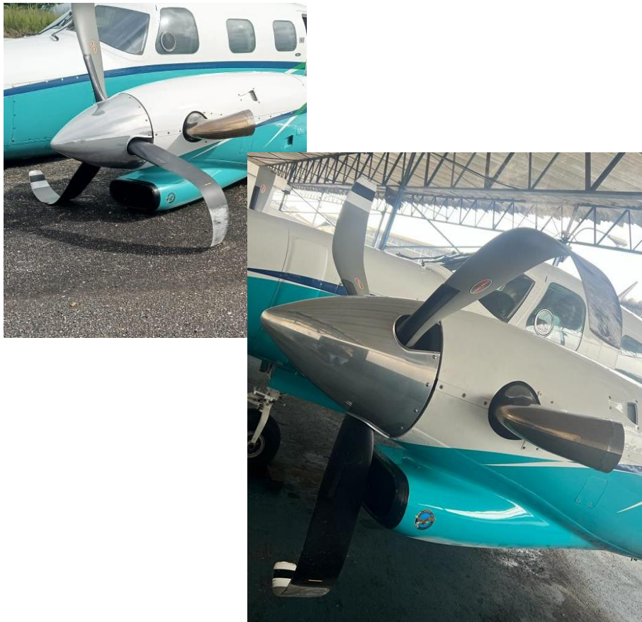
Imagen 6. Torsión en las palas motor izquierdo LH Fuente: Investigador Encargado. Año: 2022.
