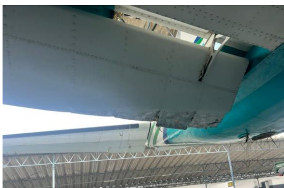
Imagen 10. Daños en el borde de ataque (vista frontal y posterior) Fuente: Investigador Encargado. Año: 2022.
