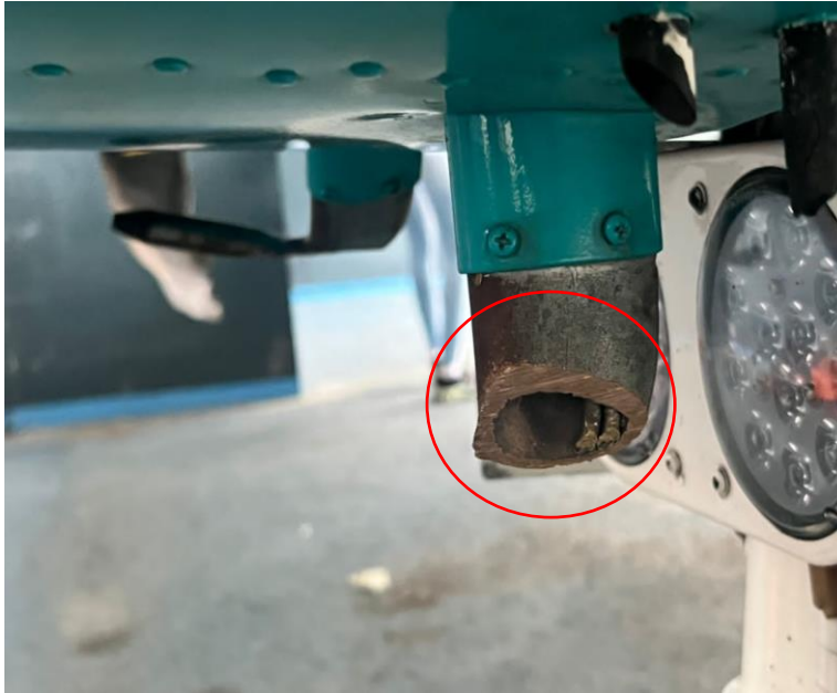
Imagen 12. Daños en el tubo pitot Fuente: Investigador Encargado. Año: 2022.
