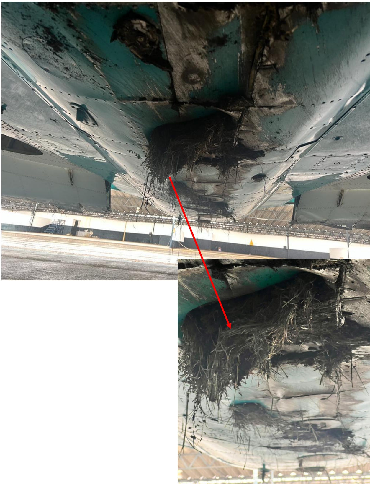
Imagen 7. Daños en la parte inferior del fuselaje Fuente: Investigador Encargado. Año: 2022.
