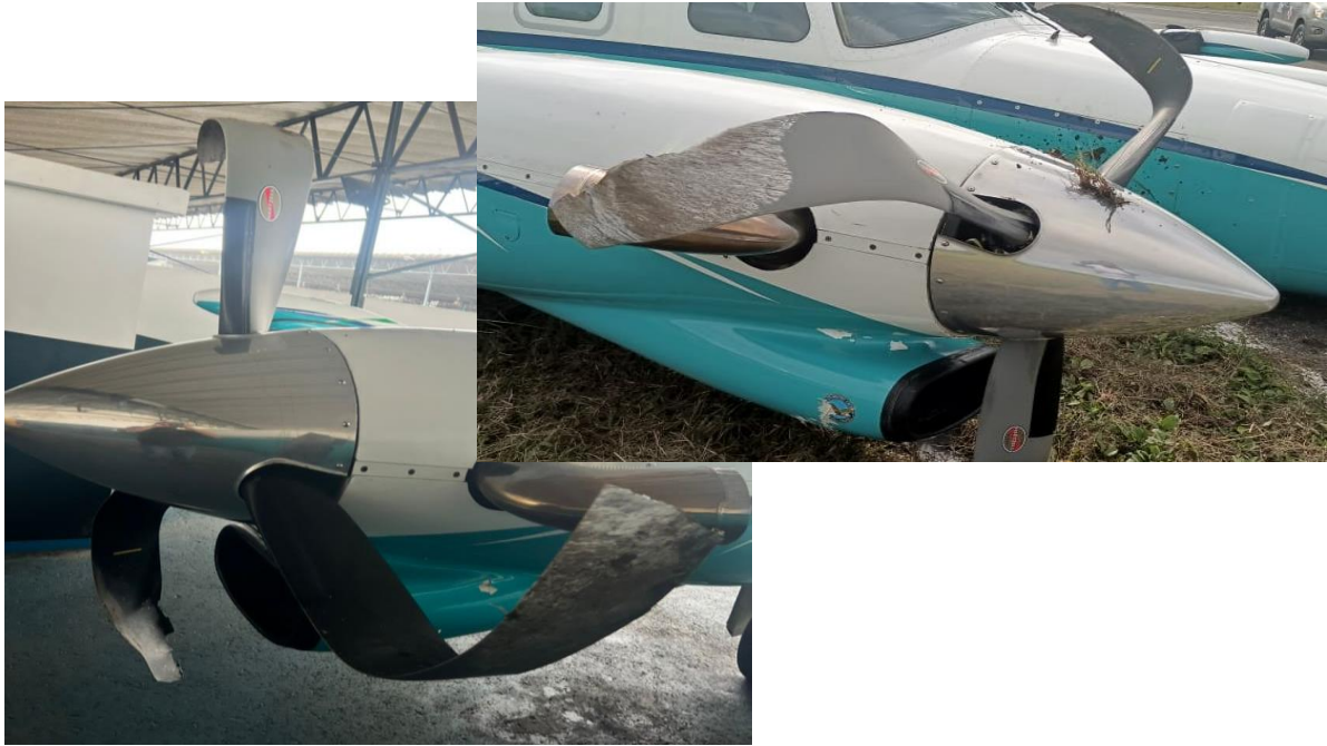
Imagen 5. Torsión en las palas motor derecho RH Fuente: Investigador Encargado. Año: 2022.
