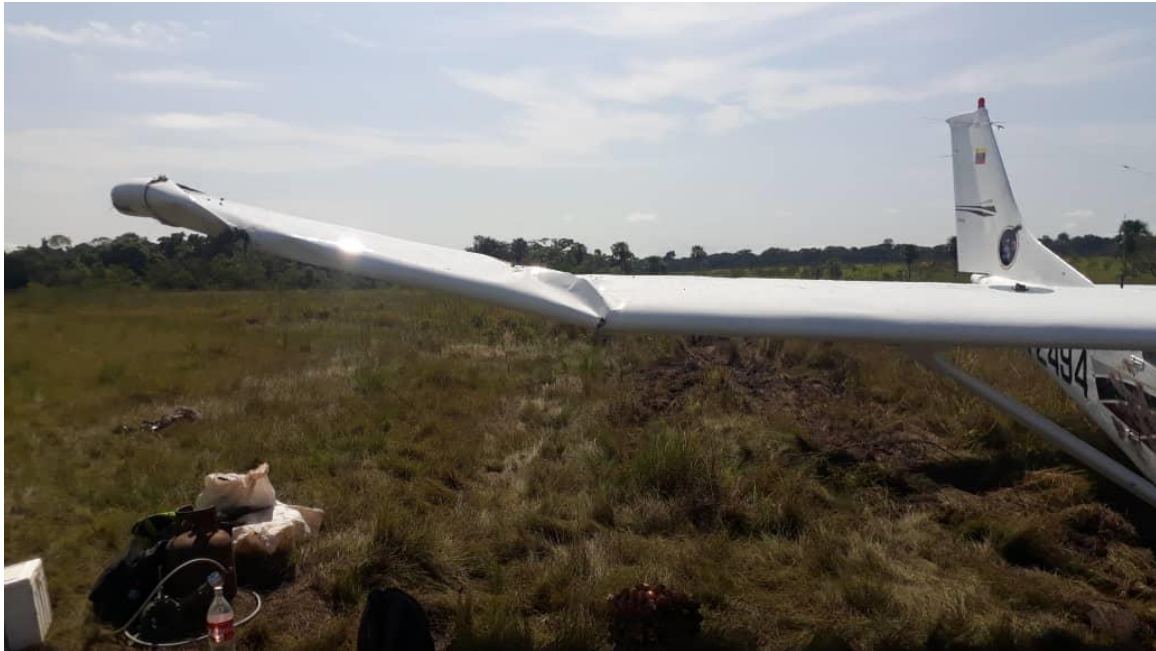
Imagen 7. Extremo del ala derecha doblada por impacto contra el terreno.
