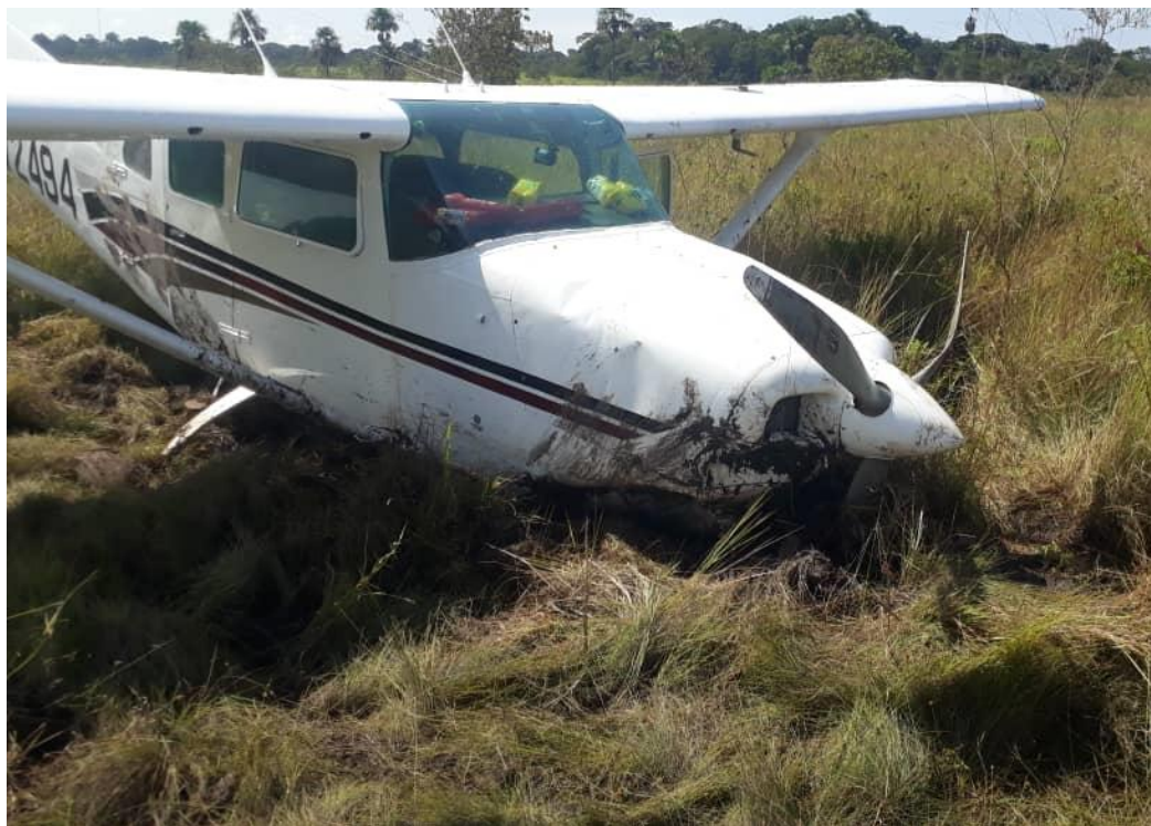
Imagen 1. Sitio donde quedó la aeronave con el tren de aterrizaje principal hundido en el pantano, las hélices ligeramente dobladas hacia atrás por impacto sin potencia
