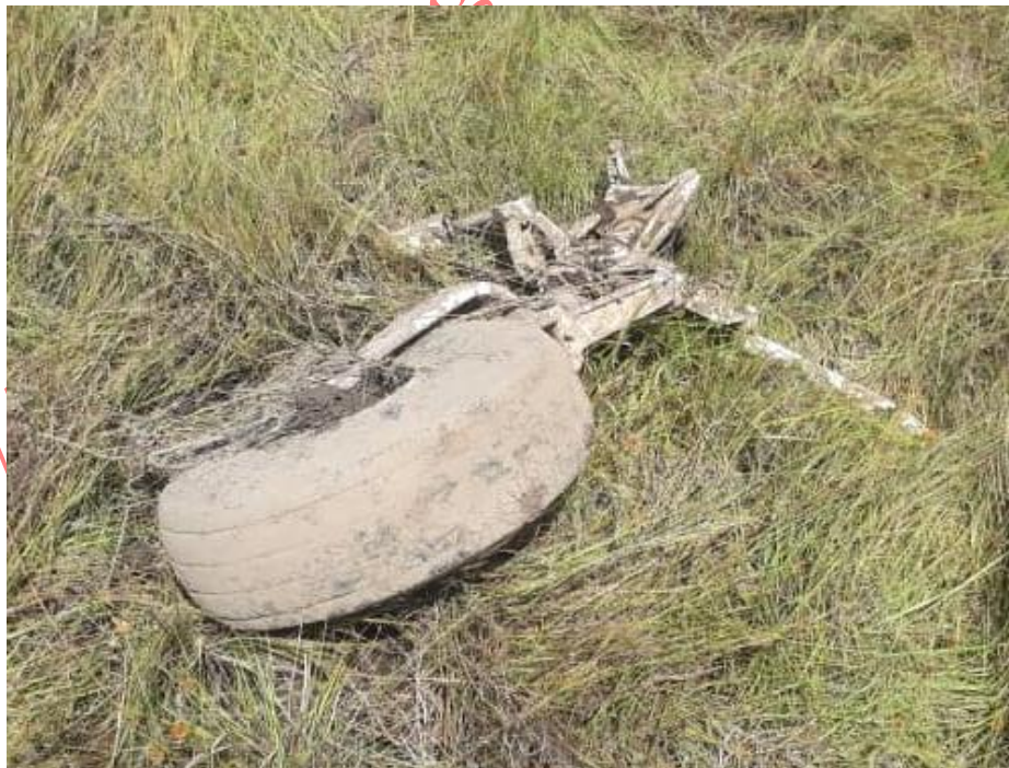
Imagen 4. Tren de nariz fracturado
