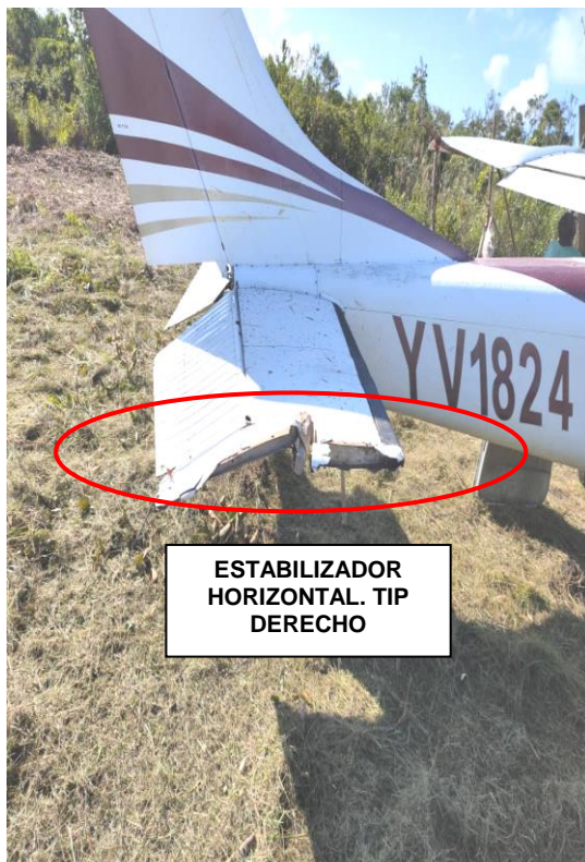
Imagen 2. Daños en la aeronave YV1824. Fuente: Investigador encargado
