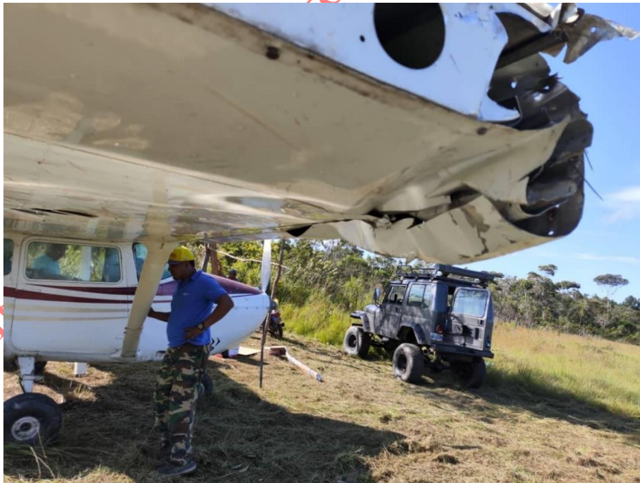
Figura 10. Daños del plano Derecho. Fuente: Investigador Encargado. Año: 2023
