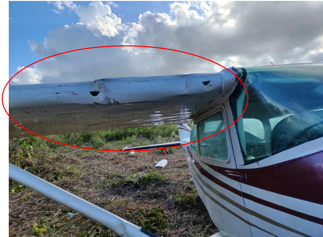
Figura 4. Daños del plano Derecho. Fuente: Investigador Encargado. Año: 2023
