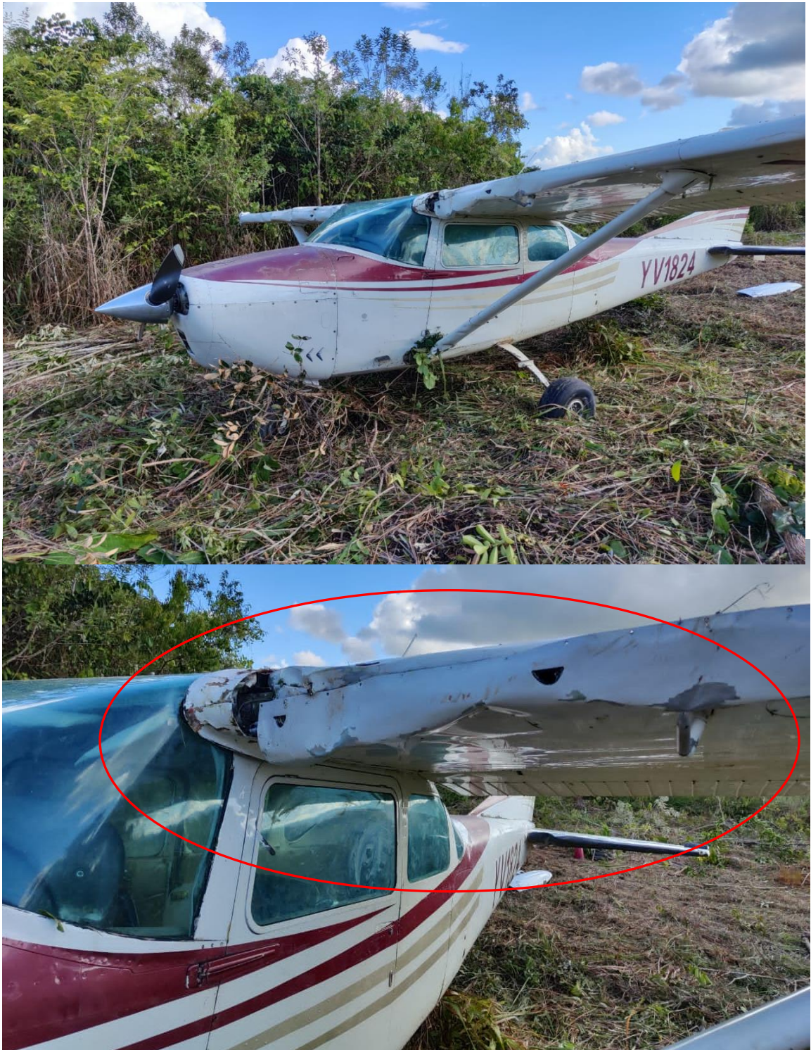
Figura 3. Daños en el plano Izquierdo. Fuente: Investigador Encargado. Año: 2023
