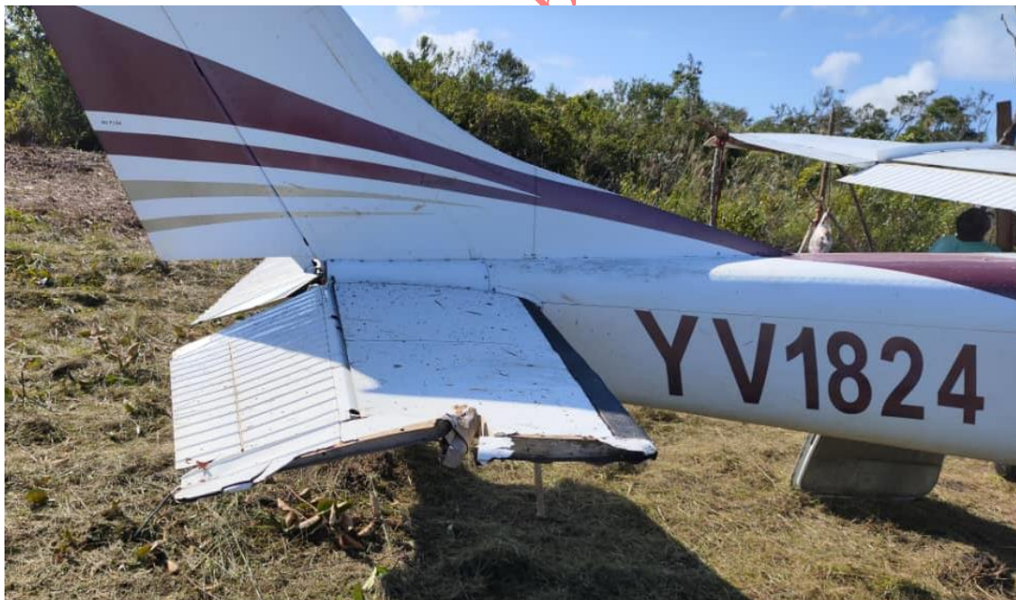
Figura 8. Daños en el estabilizador horizontal Derecho. Fuente: Investigador Encargado. Año: 2023
