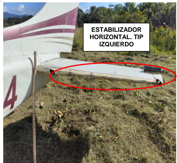
Imagen 2. Daños en la aeronave YV1824. Fuente: Investigador encargado
