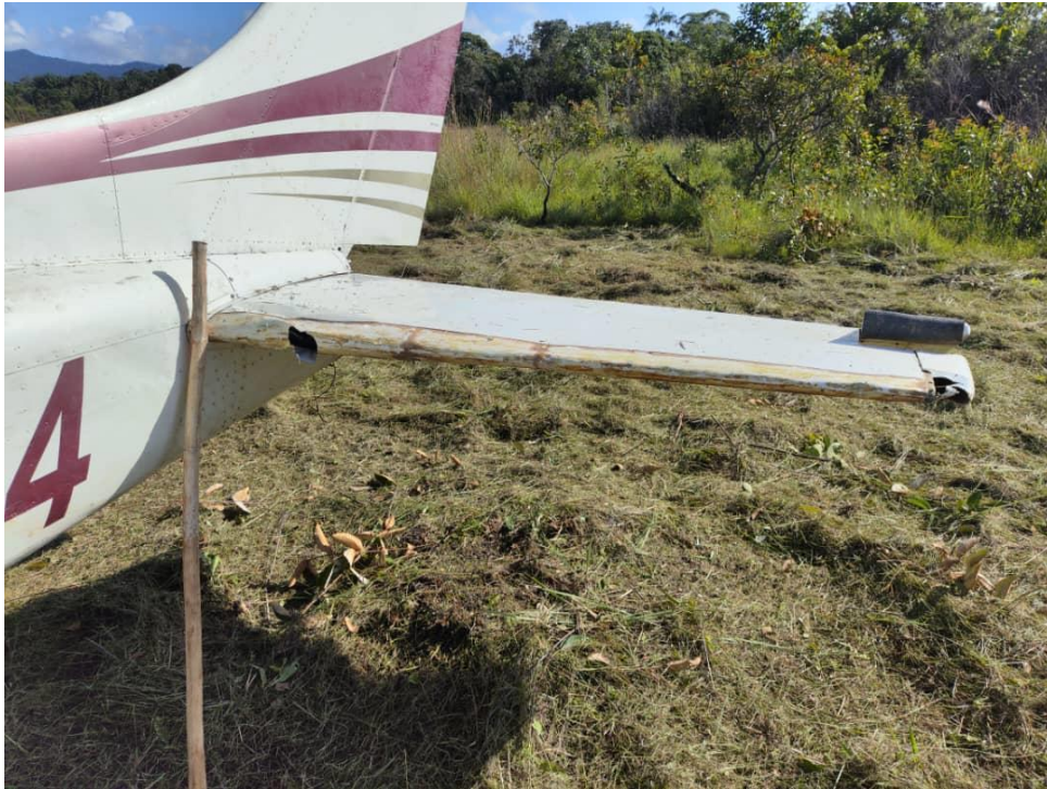
Figura 7. Daños en el estabilizador horizontal Izquierdo. Fuente: Investigador Encargado. Año: 2023
