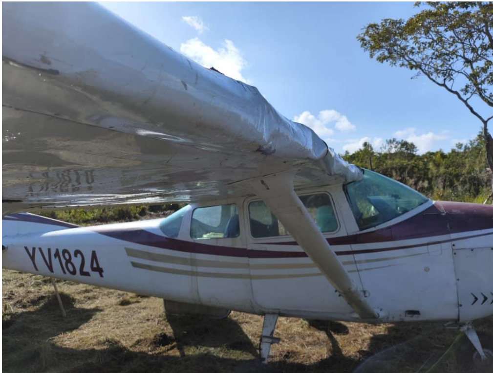
Figura 9. Daños del plano Derecho. Fuente: Investigador Encargado. Año: 2023
