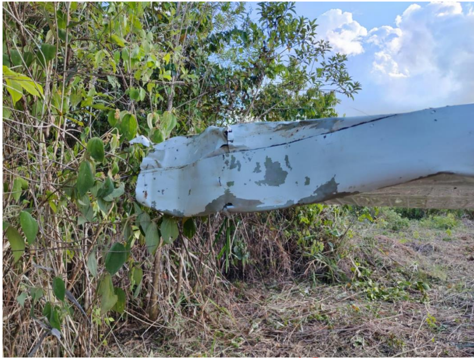
Figura 5. Daños del plano Izquierdo. Fuente: Investigador Encargado. Año: 2023
