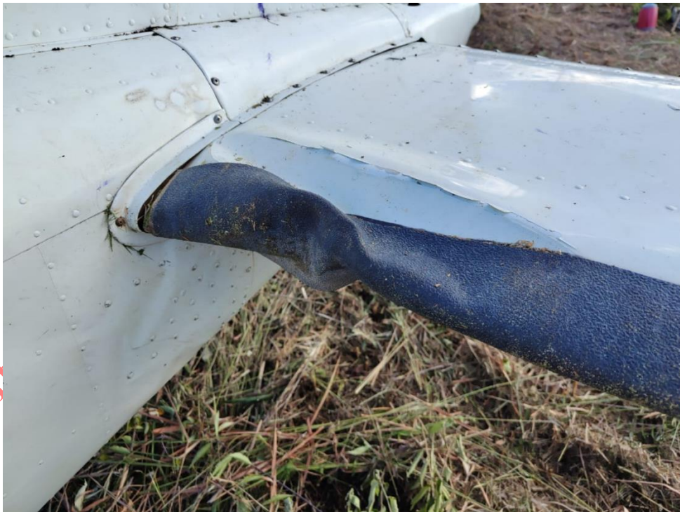
Figura 6. Daños del plano Izquierdo. Fuente: Investigador Encargado. Año: 2023
