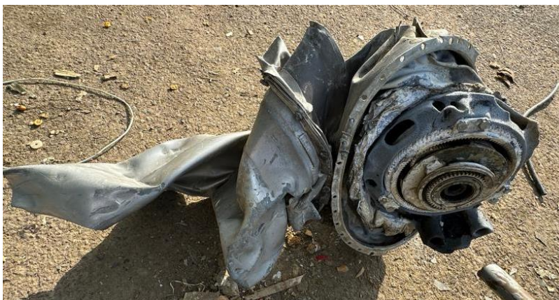
Imagen 16. Motor con evidencia de torsión por el impacto Fuente: Investigador encargado. Año: 2024
