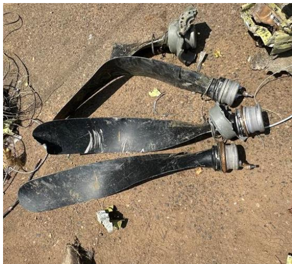
Imagen 14. Palas con evidencia de torsión por el impacto Fuente: Investigador encargado. Año: 2024
