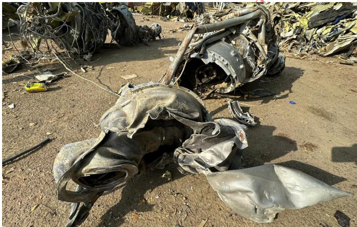
Imagen 14. Palas con evidencia de torsión por el impacto Fuente: Investigador encargado. Año: 2024
