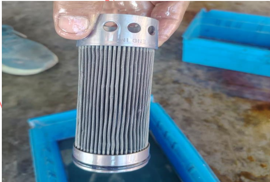
Imagen 6. Inspección del filtro motor LH YV2653.
