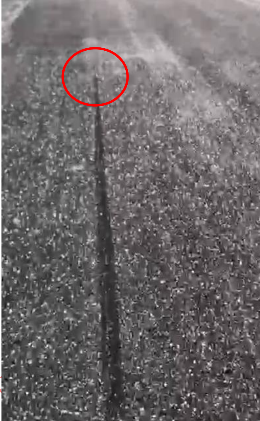
Imagen 5 Marca en la pista de inicio de frenado tren principal derecho. Fuente: Investigador Encargado. Año: 2026.
