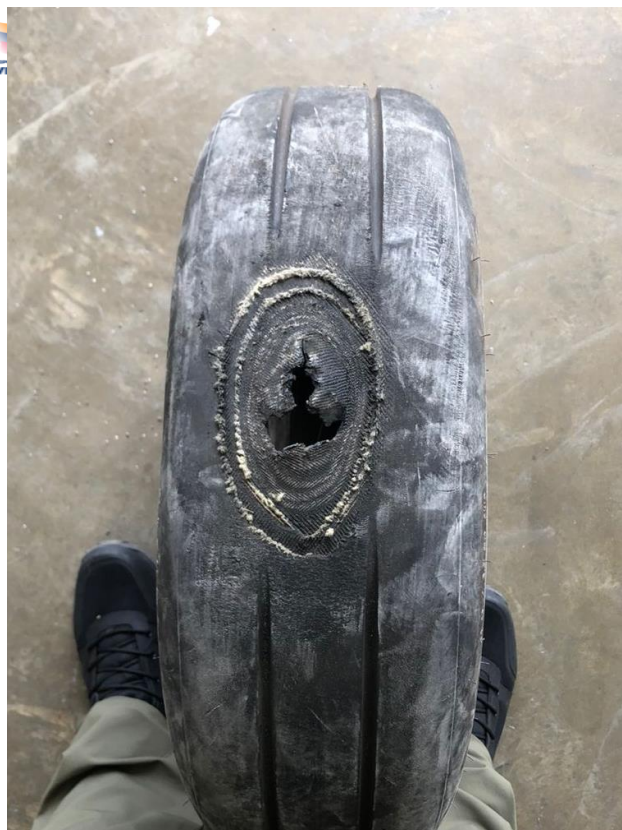
Imagen 12 Condición neumático tren derecho Vs Manual del fabricante
