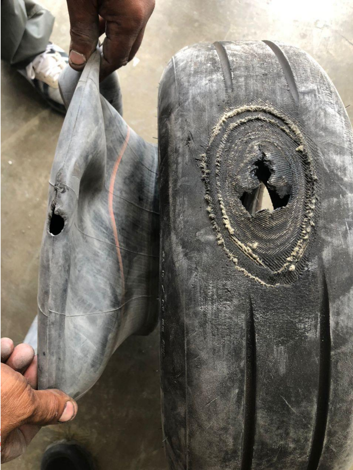
Imagen 10 Condición neumático tren principal derecho. Fuente: Investigador Encargado. Año: 2026.
