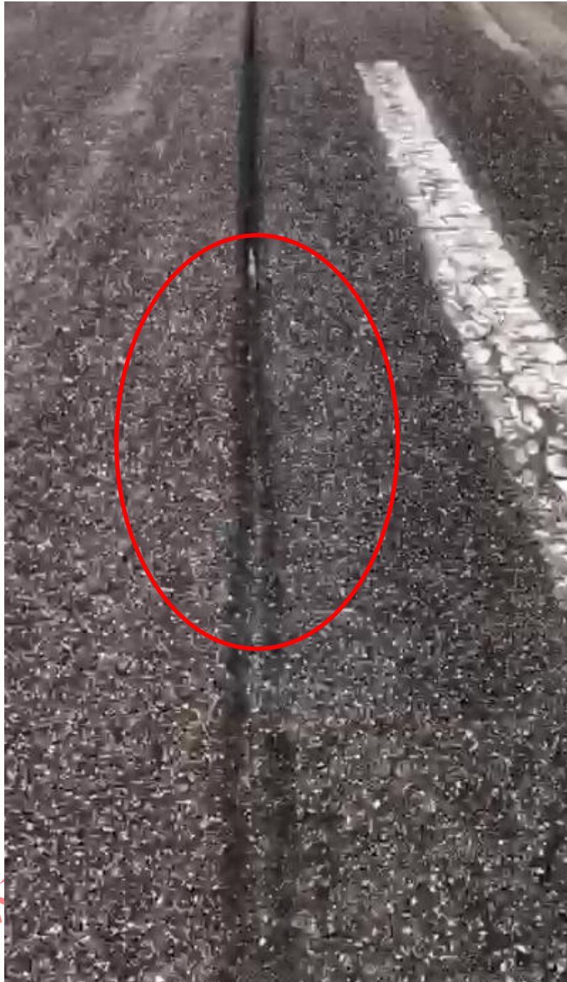
Imagen 6 Marca en la pista con el neumático desinflado (evidencia de rin)
