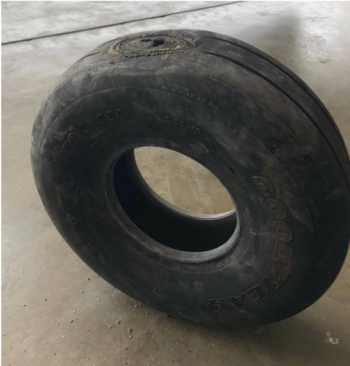
Imagen 11 Condición neumático tren principal derecho. Fuente: Investigador Encargado. Año: 2026.
