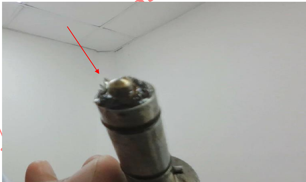
Imagen 7. Inspección del Magnetic Chip Detector YV3439.
