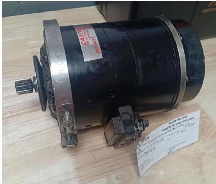
Imagen 2. Generador Eléctrico removido e inspeccionado sin novedades YV3439.
