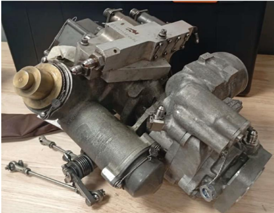
Imagen 4. Bomba de Combustible se constató que el eje de mando estaba inoperativo YV3439.
