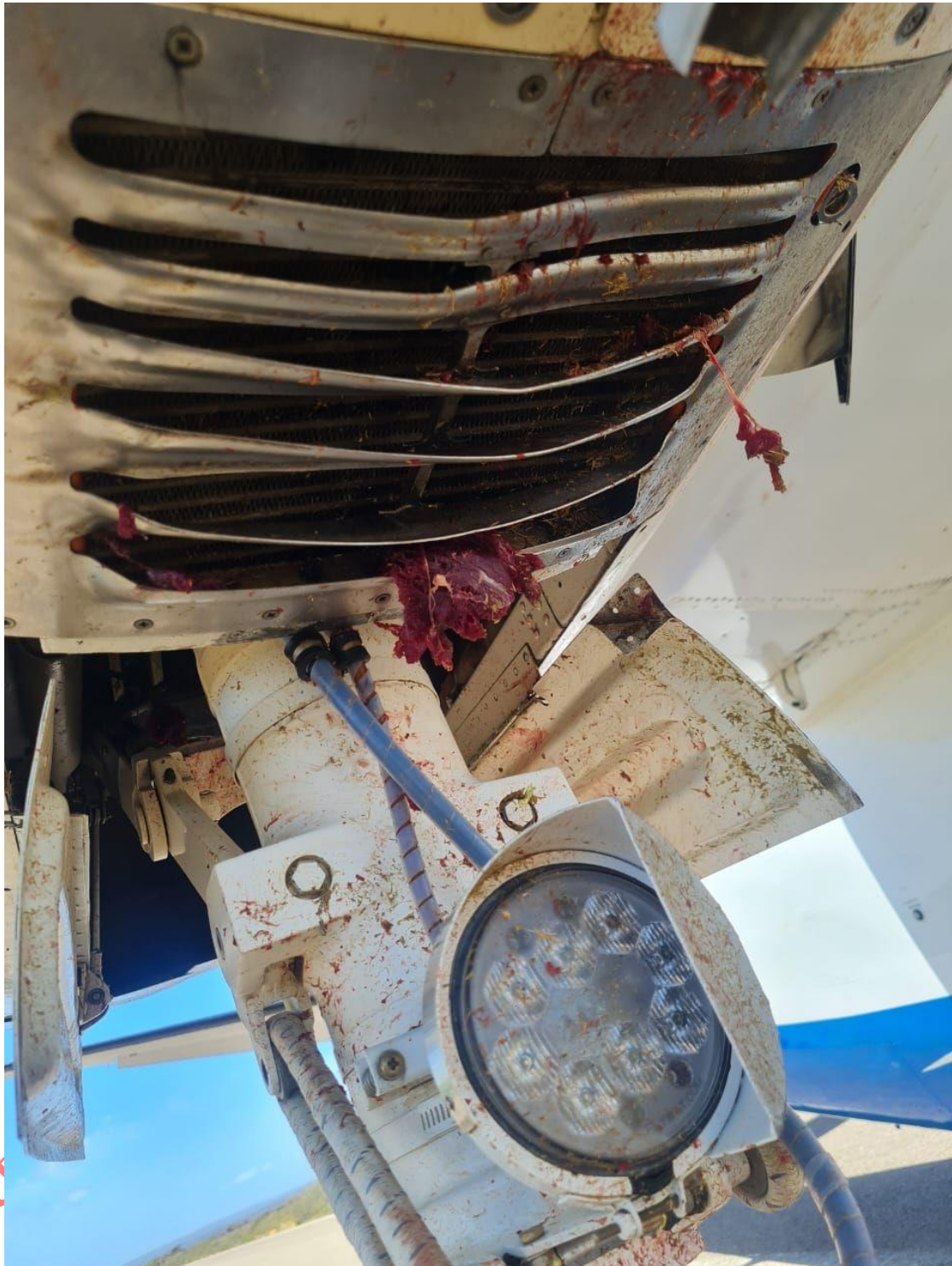
Imagen 4. Daños en Rejillas de entrada de aire del radiador del motor derecho YV1892.
