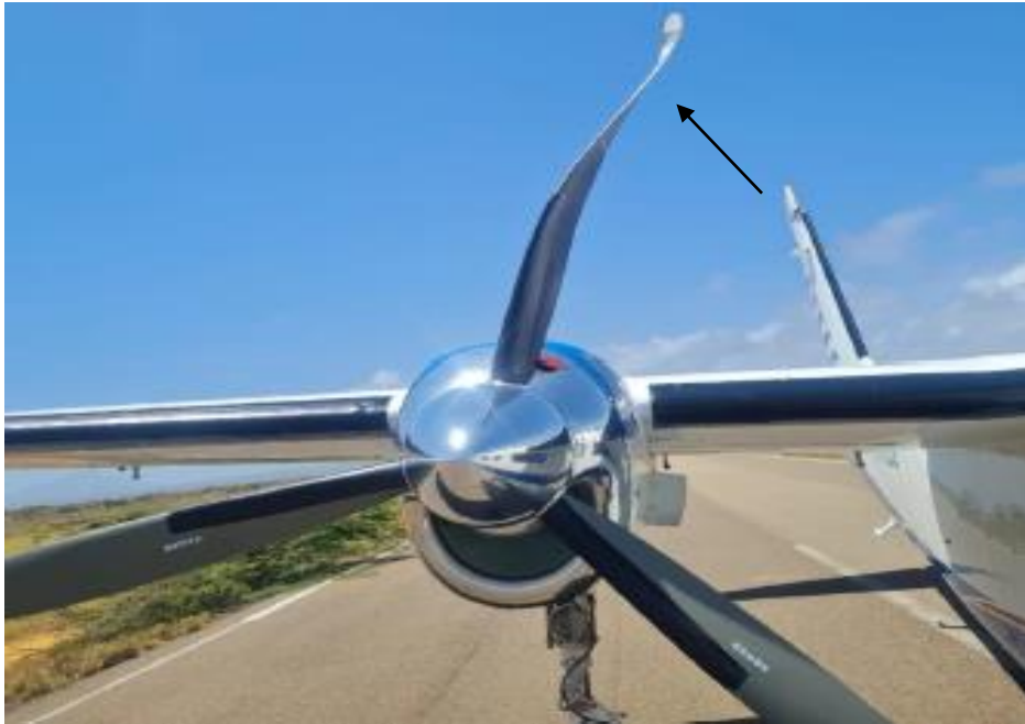
Imagen 5. Daño en las palas del motor derecho YV1892. Fuente: Investigador Encargado. Año: 2026.
