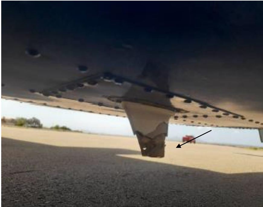
Imagen 8. Daños en la antena DME/TRANSponder, YV1892.
