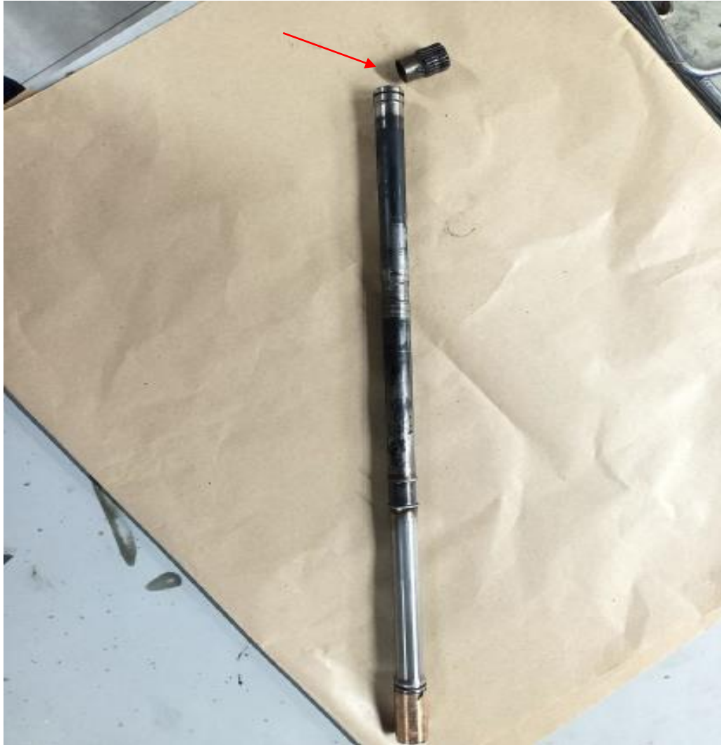
Imagen 11. Eje de torsión motor derecho Fracturado YV1892.
