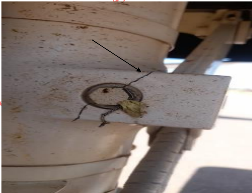
Imagen 9. Fractura en soporte externo al brazo de sobrecentro (DRAG BRACE)
