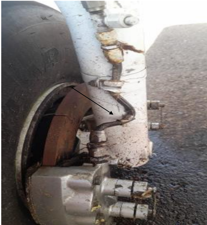
Imagen 10. Ruptura de la línea de suministro de presión hidráulica en conjunto de freno del tren principal derecho YV1892.
