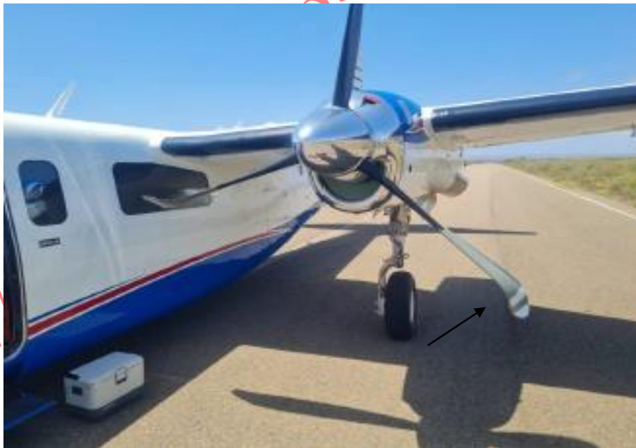
Imagen 6. Daño en las palas del motor izquierdo YV1892. Fuente: Investigador Encargado. Año: 2026
