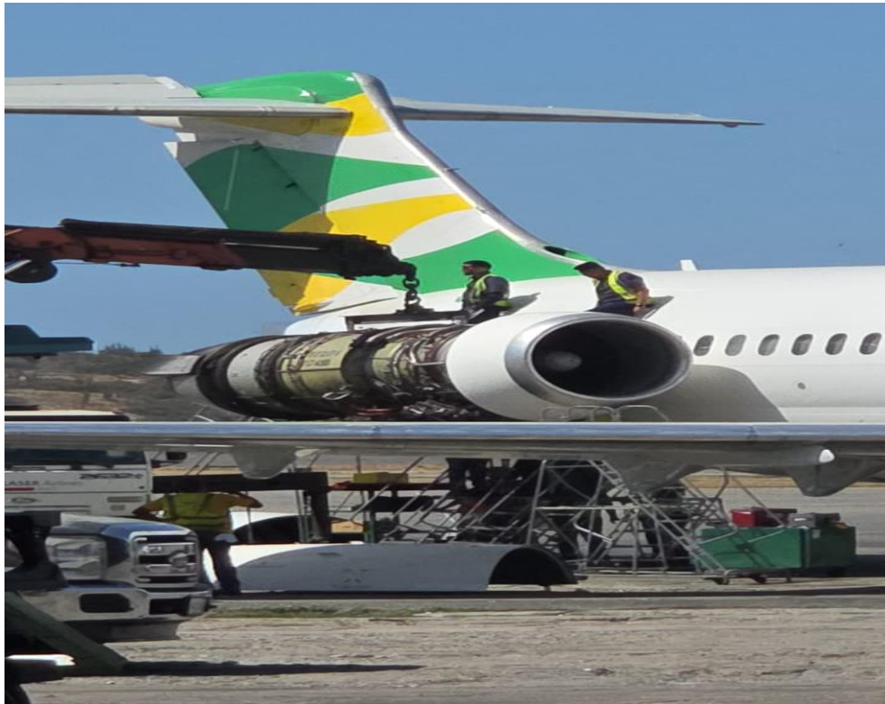
Figura 12. Remoción de Motor Derecho (RH) por Motor Servicial YV2923 Fuente: Investigador Encargado Año 2026
