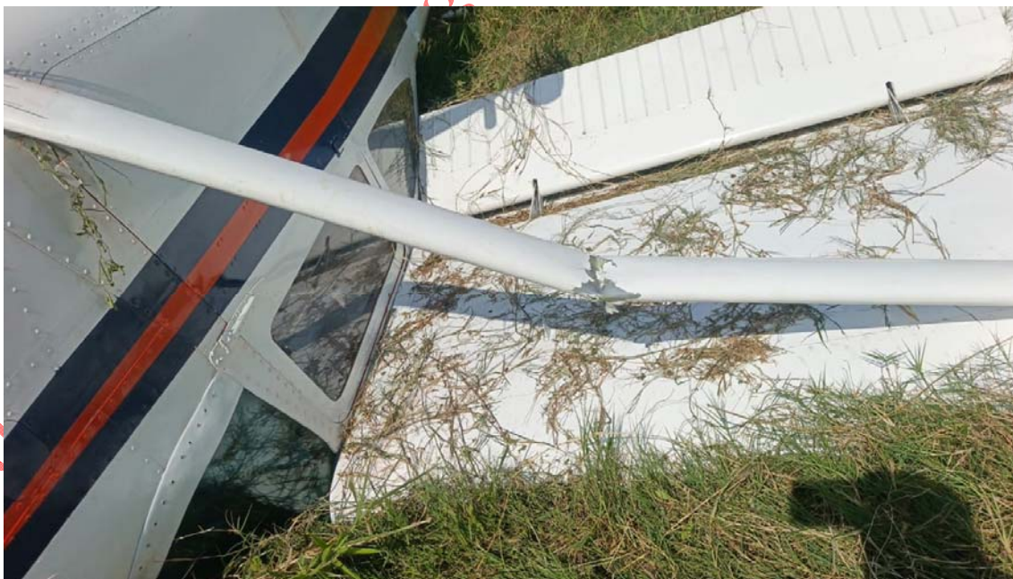
Imagen 17. Viga transversal plano izquierdo doblada YV2385.
