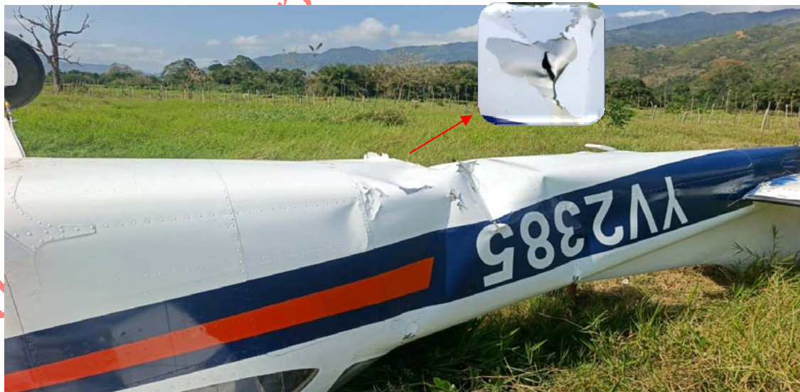
Imagen 13. Daños en el fuselaje YV2385.
