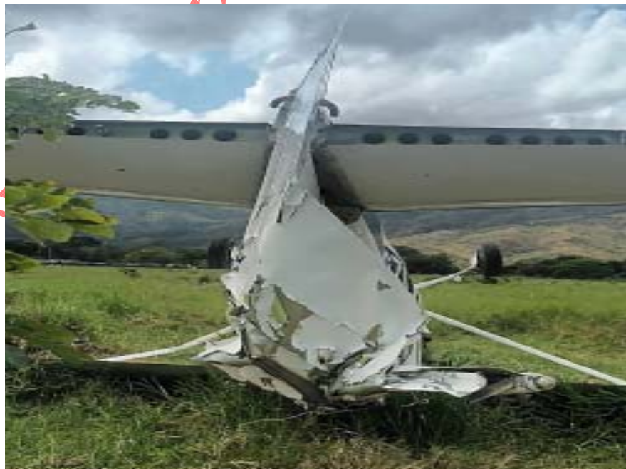
Imagen 15. Daños en el Empenaje YV2385. Fuente: Investigador Encargado. Año: 2026
