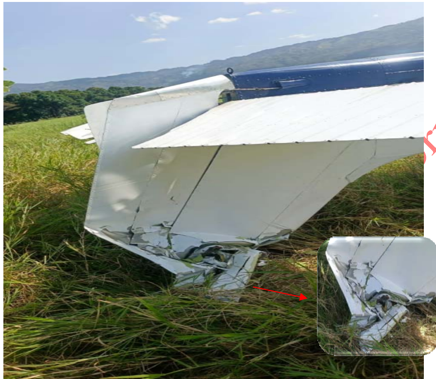
Imagen 14. Daños en el Empenaje YV2385. Fuente: Investigador Encargado. Año: 2026
