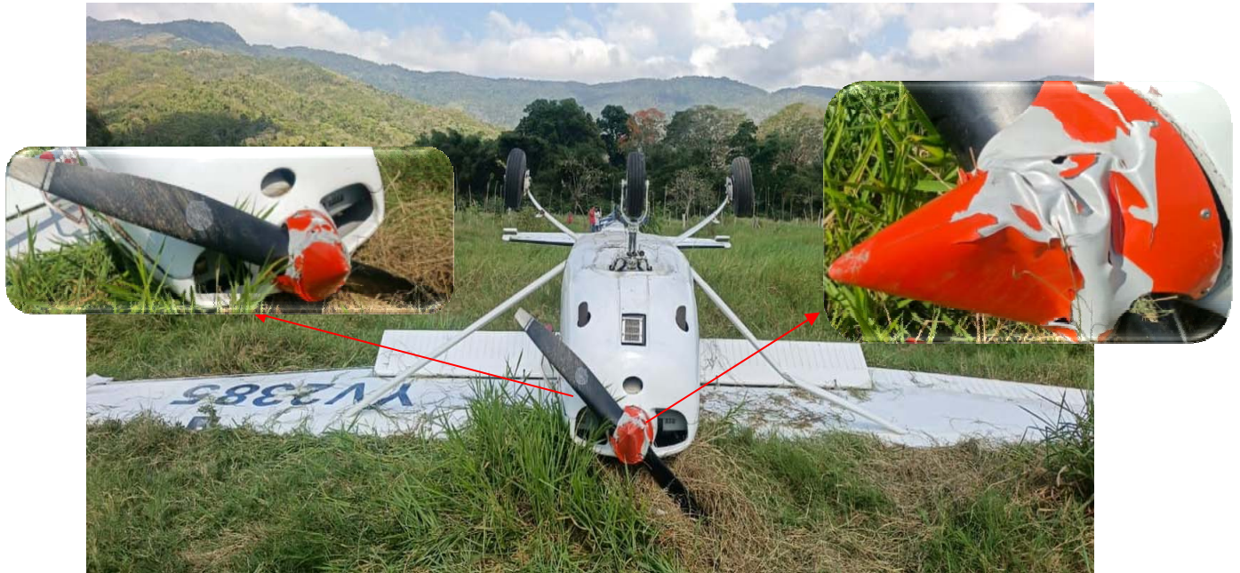
Imagen 16. Daños en la hélice (Deformada) YV2385.
