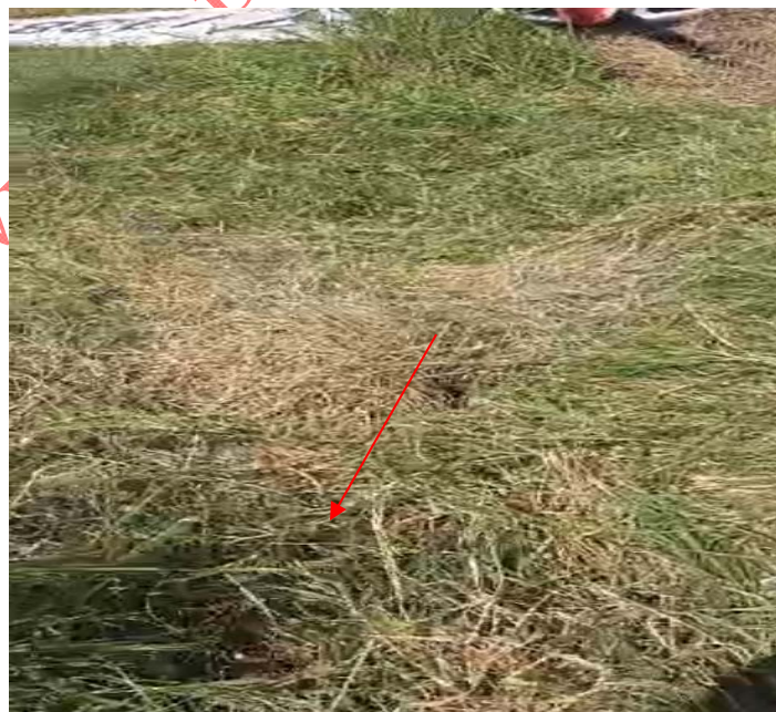
Imagen 11. Bache donde entro el tren de nariz lo que ocasionó el capoteo de la aeronave. Fuente: Investigador Encargado. Año: 2026
