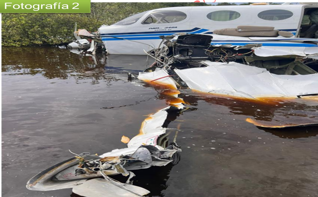
Fotografía 2. Daños de nariz y ala izquierda YV3112.
