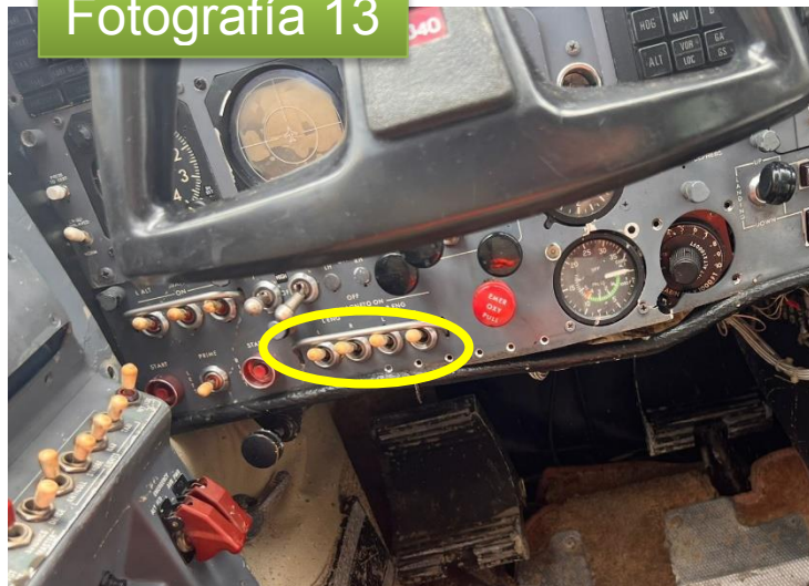
Fotografía 13: Magnetos de ambos motores en la posición ON. Fuente: Investigador encargado. Año: 2024
