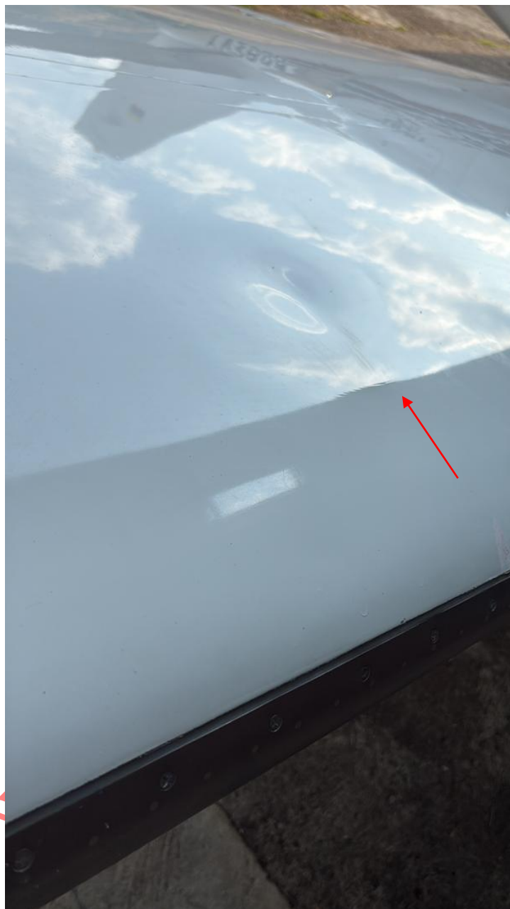
Imagen 5. Abolladura en el plano derecho YV2988.
