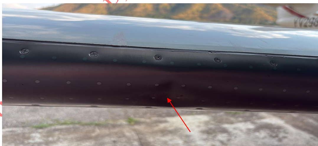
Imagen 4. Abolladura en el borde de ataque del plano derecho YV2988.
