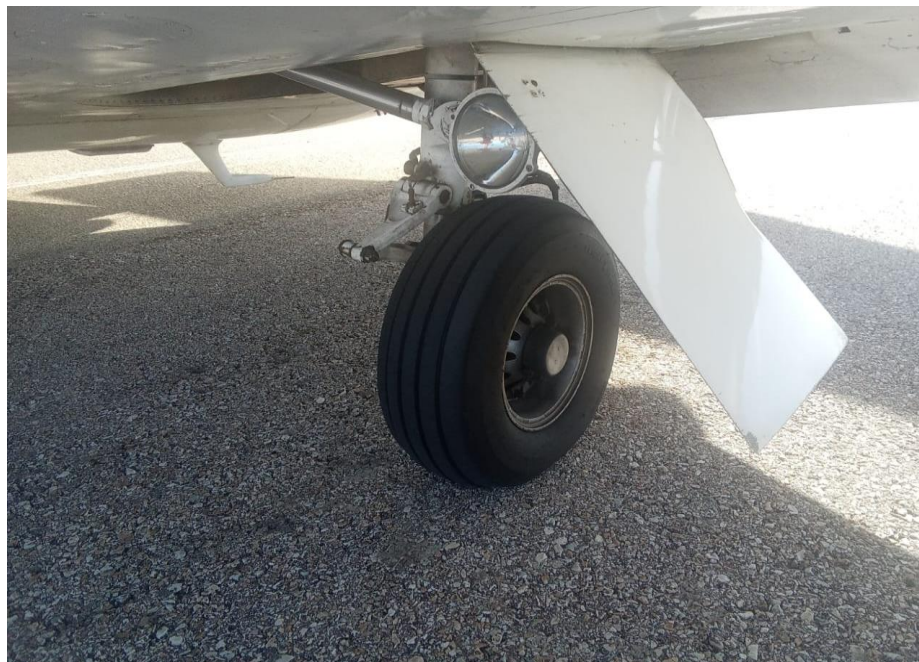
Figura 6. Tren principal izquierdo sin daños YV2892. Fuente: Investigador Encargado. Año: 2026
