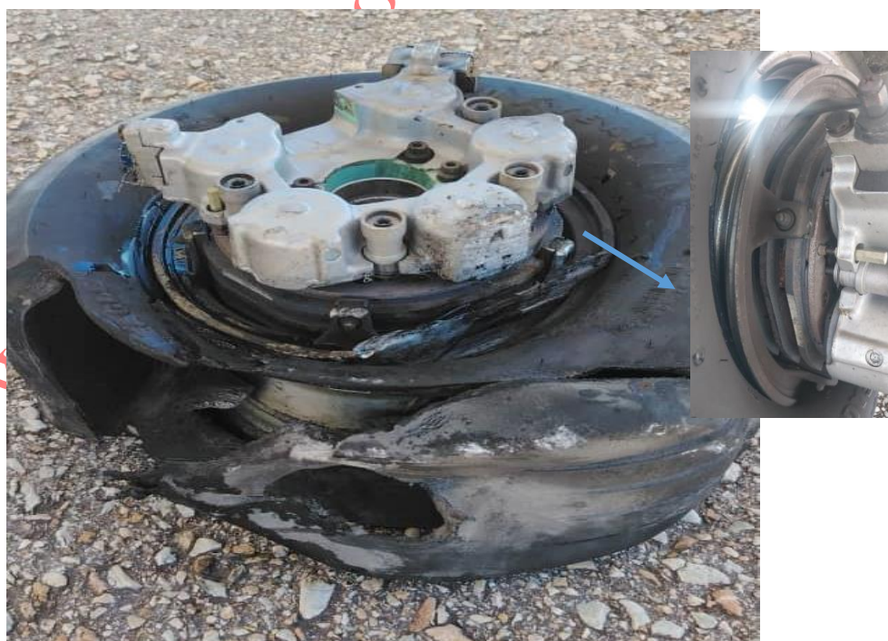
Figura 11. Daños en el Rin y caucho del YV2892. Fuente: Investigador Encargado. Año: 2026
