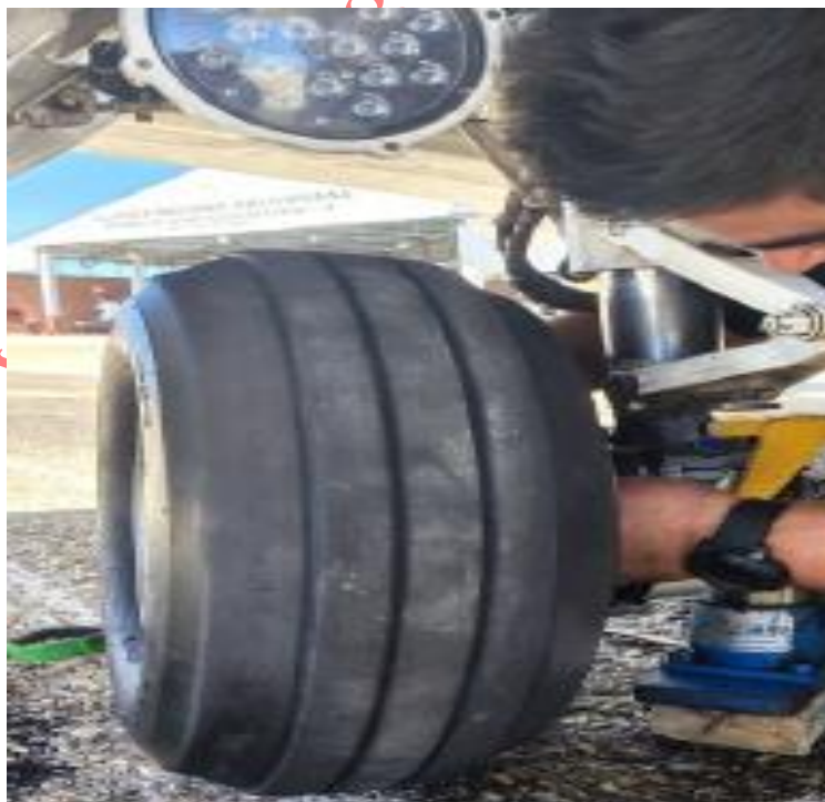
Figura 13. Instalación del caucho YV2892. Fuente: Investigador Encargado. Año: 2026
