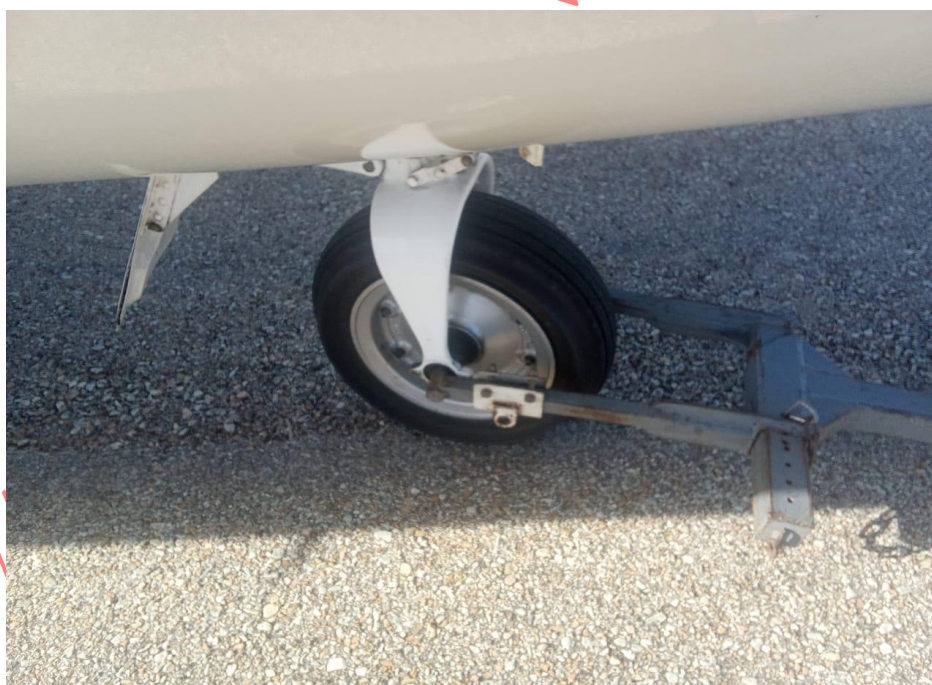
Figura 7. Tren de Nariz sin daños YV2892. Fuente: Investigador Encargado. Año: 2026
