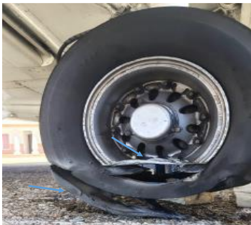
Figura 10. Daños en el Rin y caucho del YV2892. Fuente: Investigador Encargado. Año: 2026
