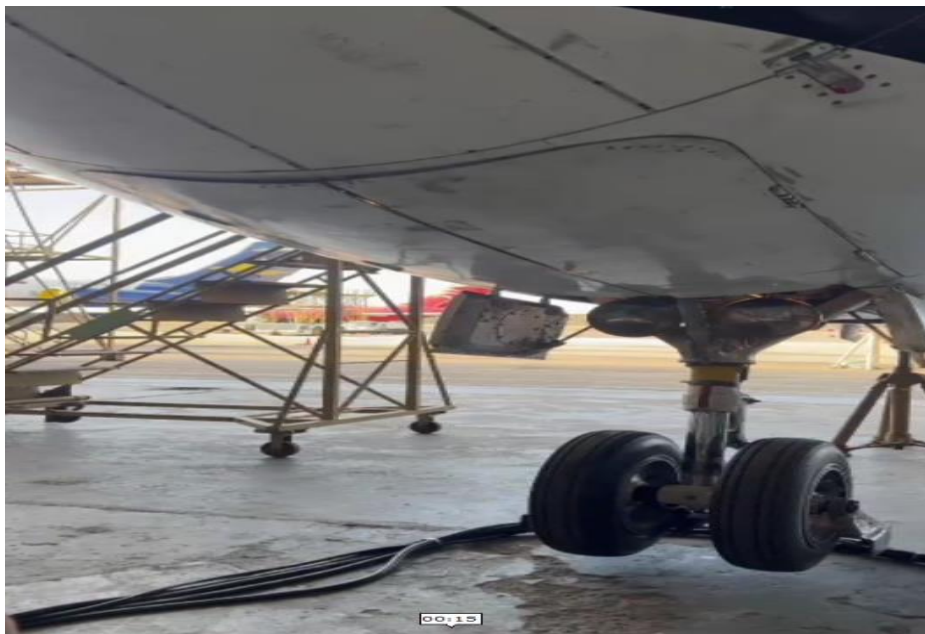
Figura 6. Prueba de retracción y extensión de trenes YV648T Fuente: Investigador Encargado. Año: 2026
