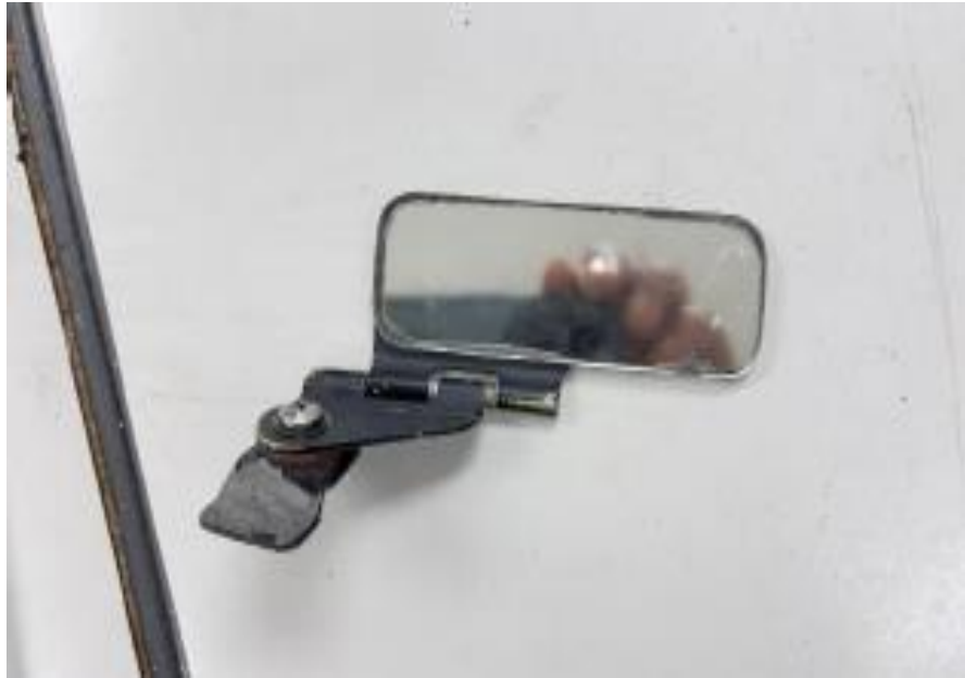
Figura 3. Espejo de la brújula del primer oficial Removida YV648T.
