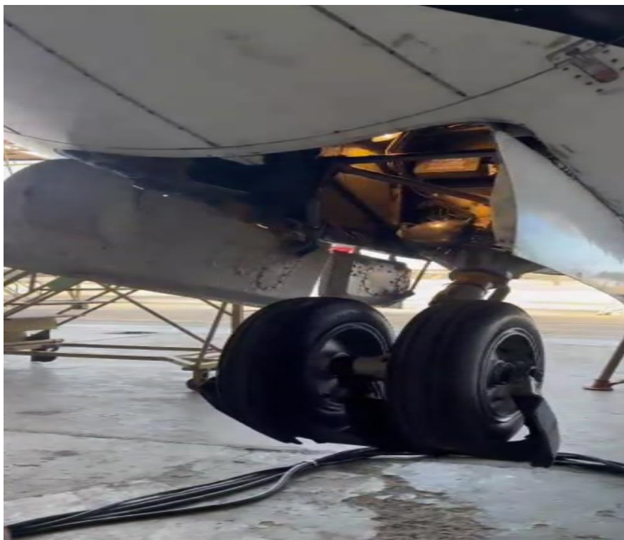
Figura 7. Prueba de retracción y extensión de trenes YV648T Fuente: Investigador Encargado. Año: 2026
