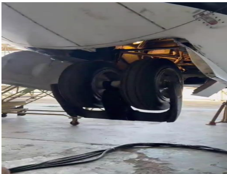
Figura 8. Prueba de retracción y extensión de trenes YV648T Fuente: Investigador Encargado. Año: 2026
