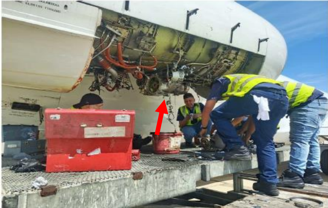
Figura 5. Trabajos de remoción de la caja de accesorios YV670T. Fuente: Investigador Encargado Año: 2026
