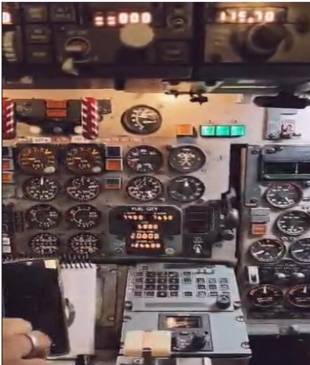
Figura 7. Inspección de la presión de aceite del motor luego del reemplazo de la caja de accesorios. Fuente: Investigador Encargado Año: 2026
