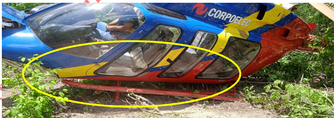
Figura 2. Daños en los Stet del lado Izquierdo. Fuente: Investigador Encargado. Año: 2022.
