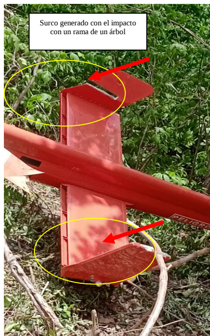
Figura 6. Daños en el Estabilizador Horizontal. Fuente: Investigador Encargado. Año: 2022.
