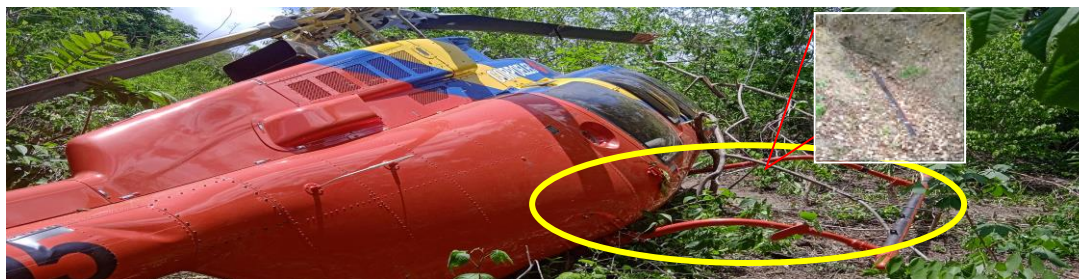
Figura 3. Daños en los Stet del lado derecho. Fuente: Investigador Encargado. Año: 2022.
