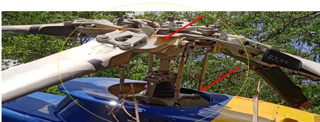
Figura 8. Daños en el Rotor Principal. Fuente: Investigador Encargado. Año: 2022.
