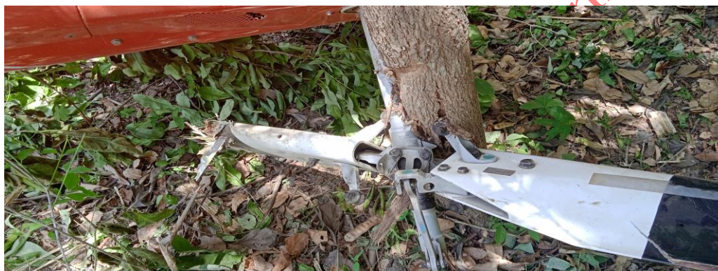
Figura 9. Daños de las Hélices del Rotor de Cola. Fuente: Investigador Encargado. Año: 2022
