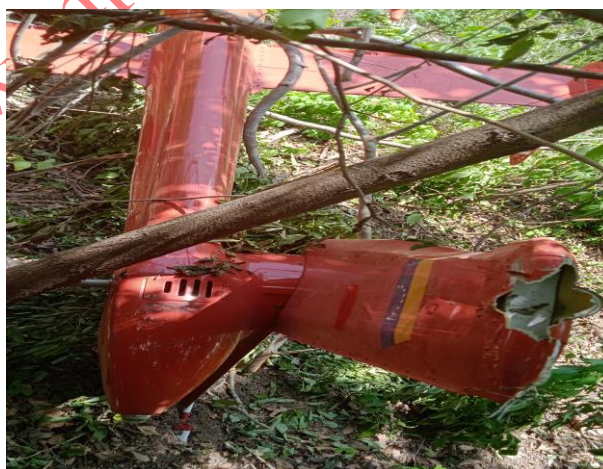
Figura 10. Daños del Patin de Cola. Fuente: Investigador Encargado. Año: 2022
