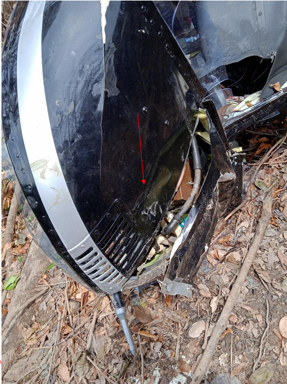
Fotografía 17 Daños fuselaje de la nariz YVO211. Fuente: Investigador encargado. Año: 2024
