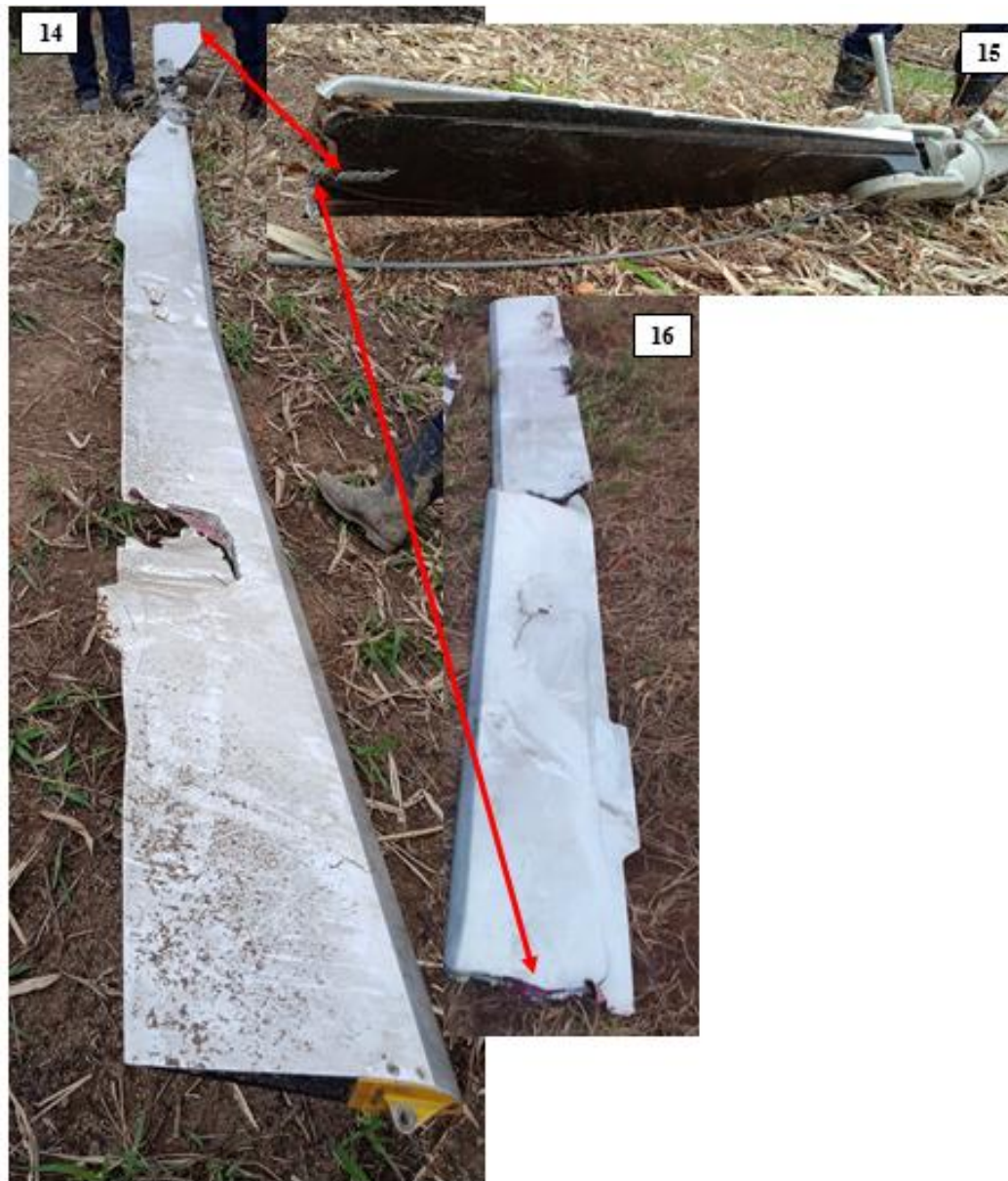
Fotografía 14, 15 y 16. Daños en las Aspas o palas del rotor principal YVO211. Fuente: Investigador encargado. Año: 2024
