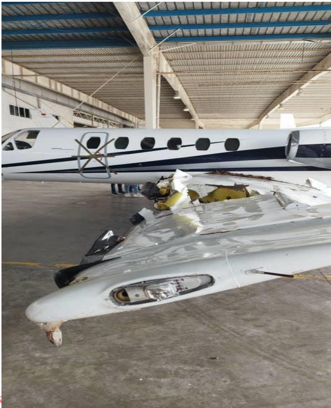
Figura 6. Deformación y rajadura del plano LH Y RH zona FS 531,FS 521, FS 631, FS 621 de la Aeronave YV2166 .
