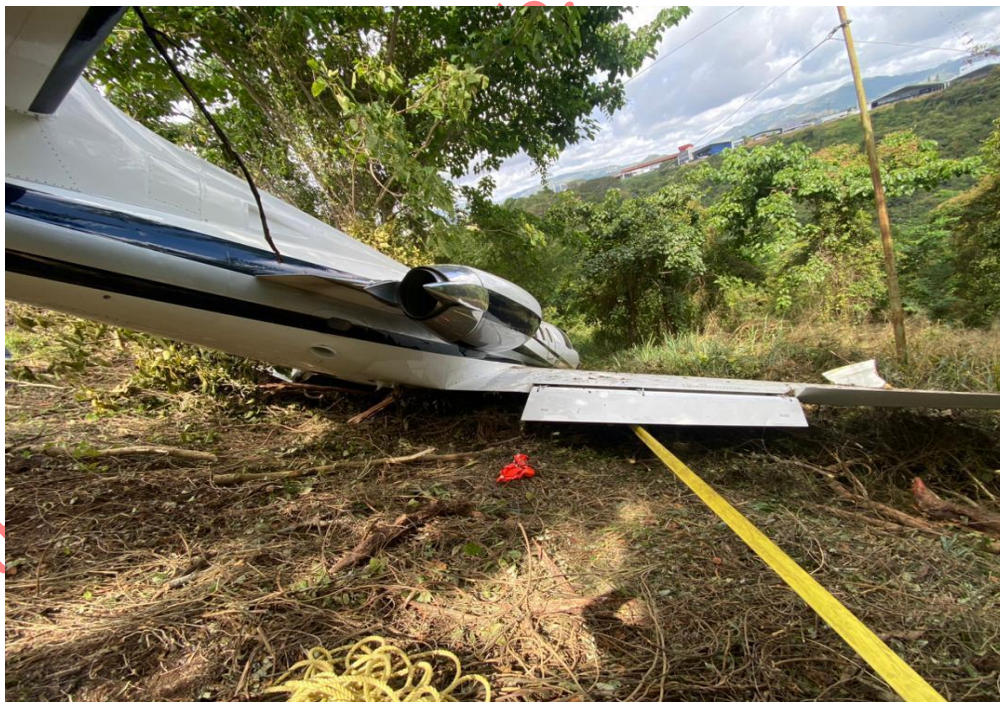
Figura 12. Daños en el Plano Derecho parte posterior de la Aeronave YV2166. Fuente: Investigador Encargado. Año: 2023.
