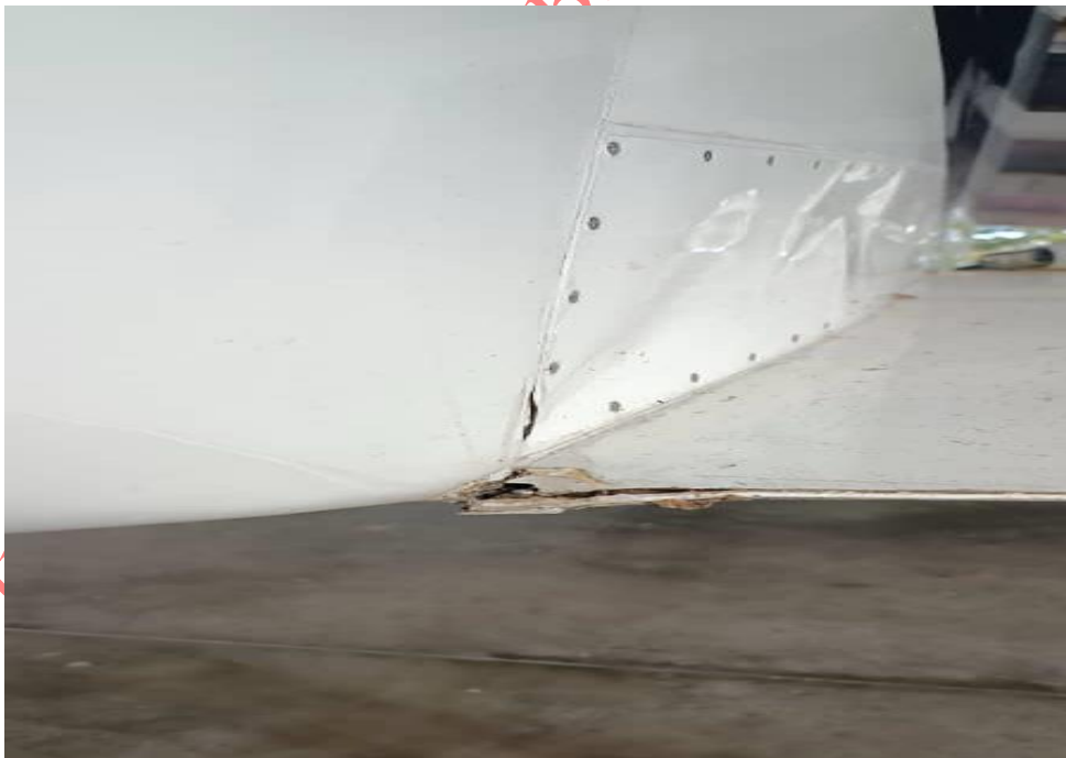
Figura 10. Deformación en el encastre del ala FS 511 de la Aeronave YV2166.
