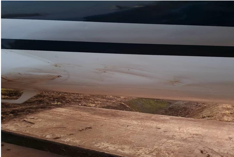
Figura 9. Deformación de la zona baja del fuselaje delantero FS 161 de la Aeronave YV2166.
