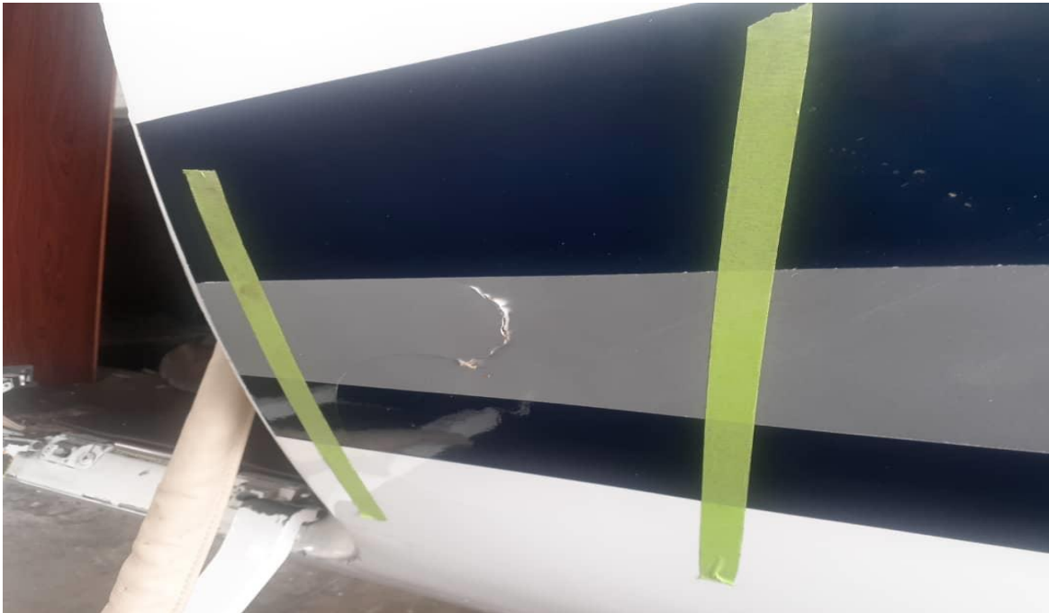
Figura 7. Deformación del fuselaje delantero FS 261 de la Aeronave YV2166.
