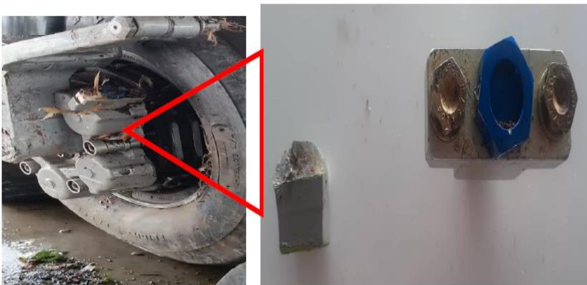
Figura 25. Daños del CALIPER DEL TREN PRINCIPAL IZQUIERDO de La Aeronave YV2166 Fuente: Investigador Encargado. Año: 2023
