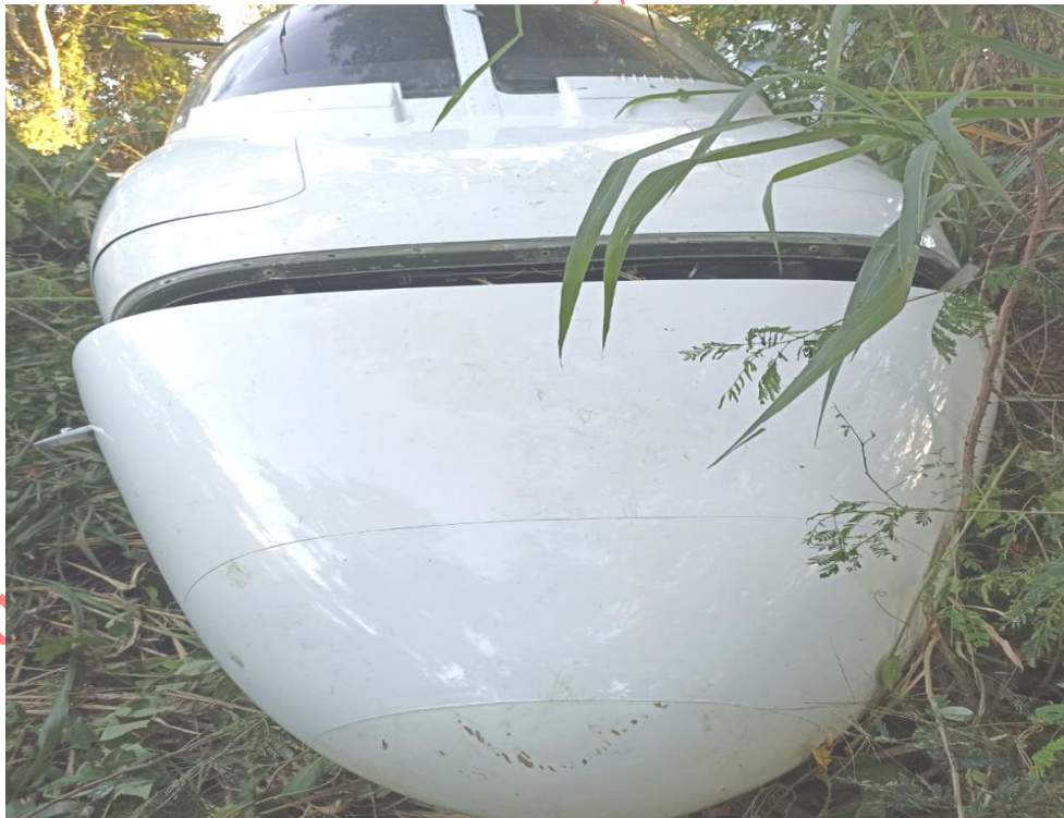
Figura 14. Daños en el Radón de la Aeronave YV2166. Fuente: Investigador Encargado. Año: 2023.
