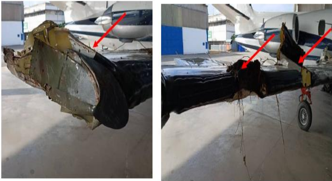
Figura 13. Daños en el Plano Derecho parte anterior de la Aeronave YV2166. Fuente: Investigador Encargado. Año: 2023.
