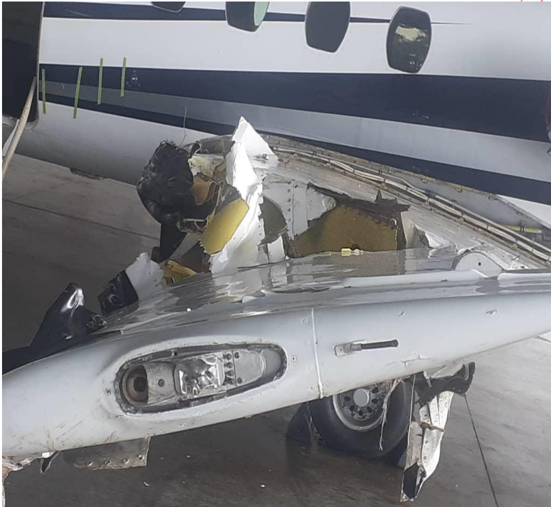
Figura 5. Deformación y rajadura del plano LH Y RH zona FS 531,FS 521, FS 631, FS 621 de la Aeronave YV2166 .
