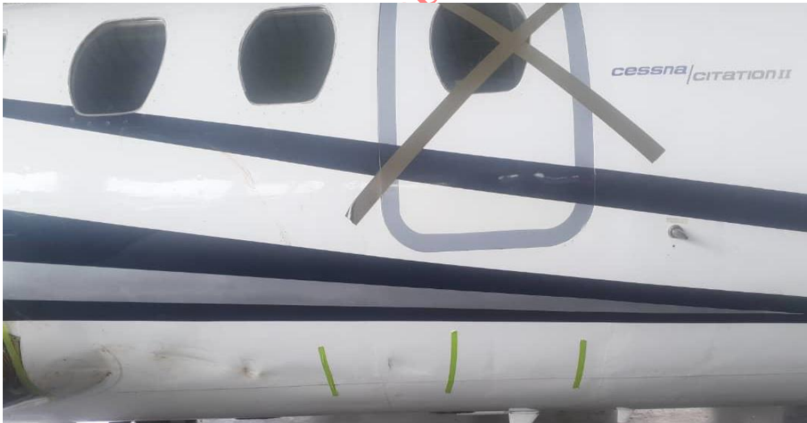
Figura 8. Deformación de la zona baja del fuselaje delantero FS 295 de la Aeronave YV2166.
