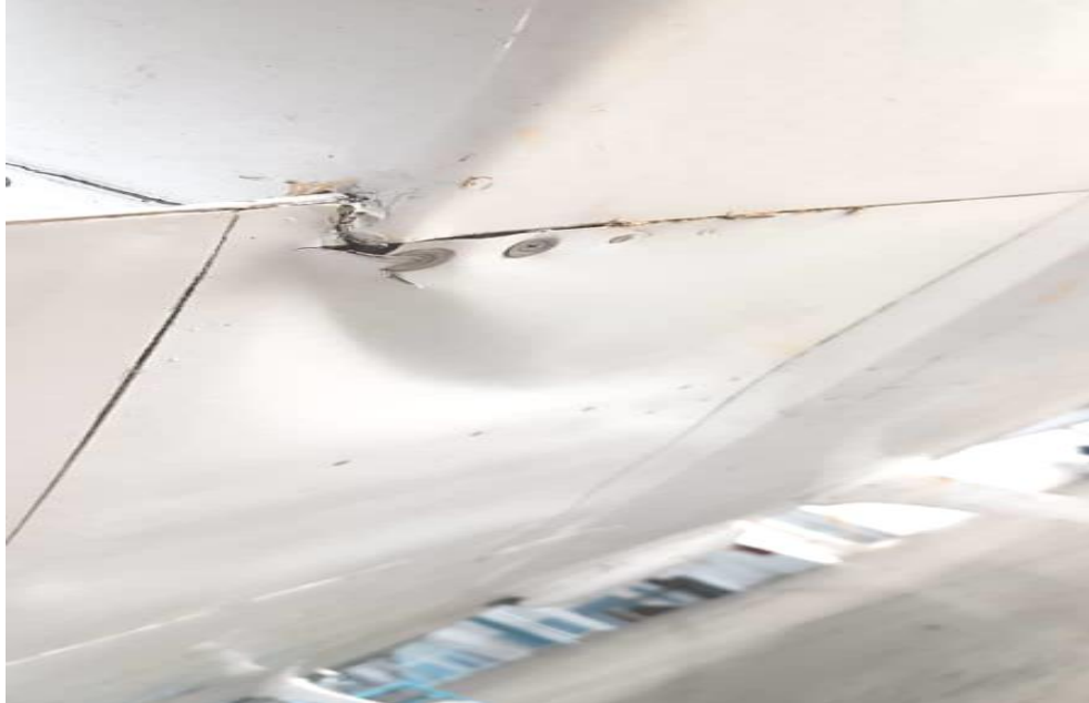
Figura 11. Deformación en el encastre del ala RH FS 611 Fuente: Investigador Encargado. Año: 2023.
