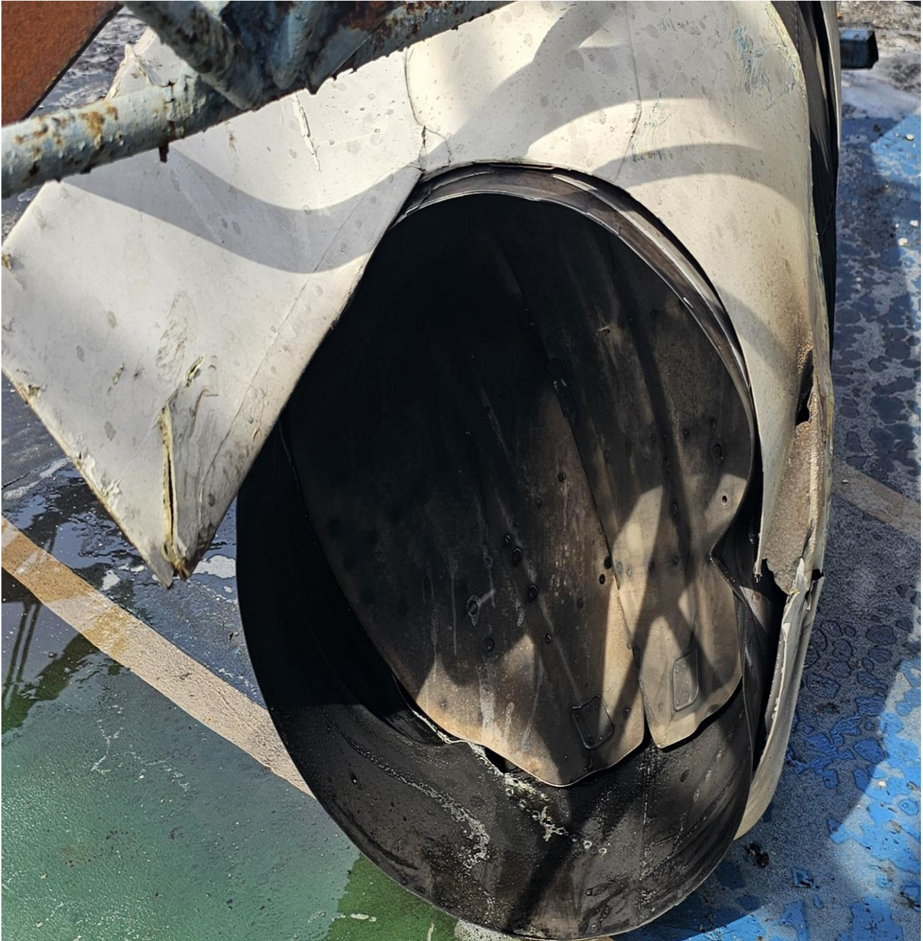
Imagen 28 Motor derecho con reversible desplegado.
