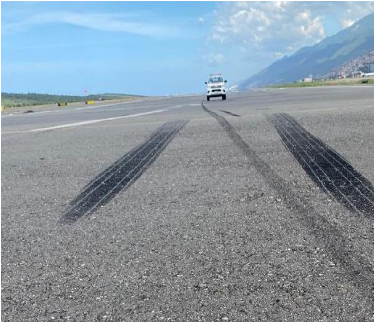
Imagen 18 Marcas de frenado al final de la pista Fuente: Investigador encargado. Año: 2025
