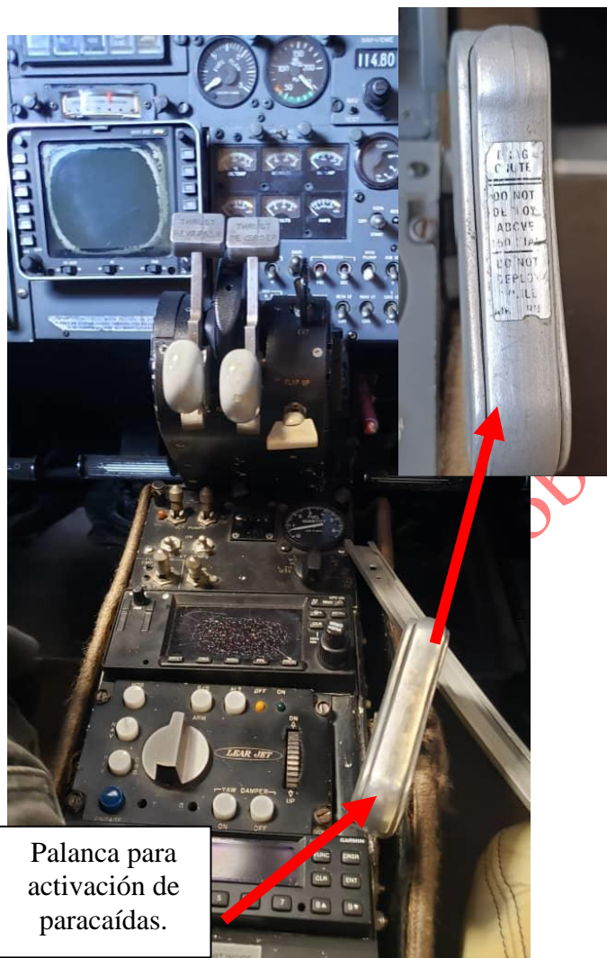
Imagen 36 Comparación cabina YV3440 vs cabina equipada con paracaídas.
