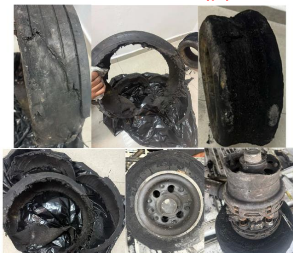
Imagen 50 Neumáticos trenes RH y LH Fuente: Investigador Encargado. Año: 2025
