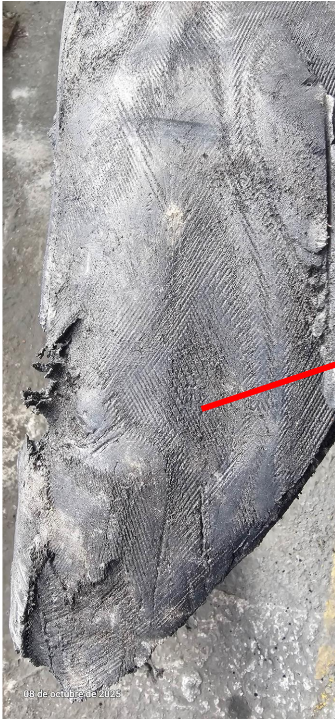
Imagen 24 Neumático recuperado tren principal derecho
