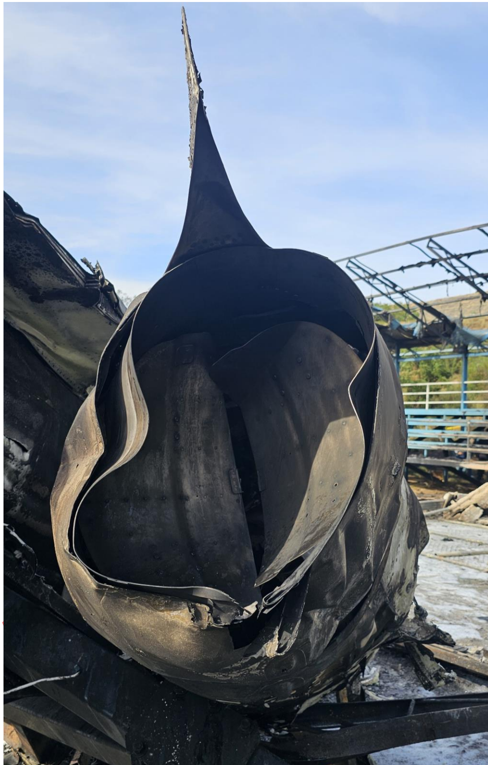
Imagen 29 Motor izquierdo con reversible desplegado. Fuente: Investigador encargado. Año: 2025
