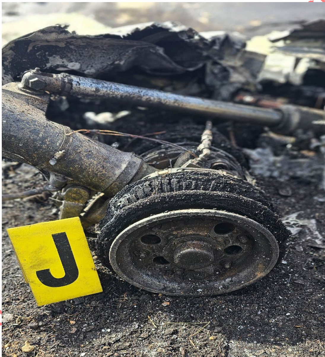
Imagen 32 Tren principal Derecho. Fuente: Investigador encargado. Año: 2025
