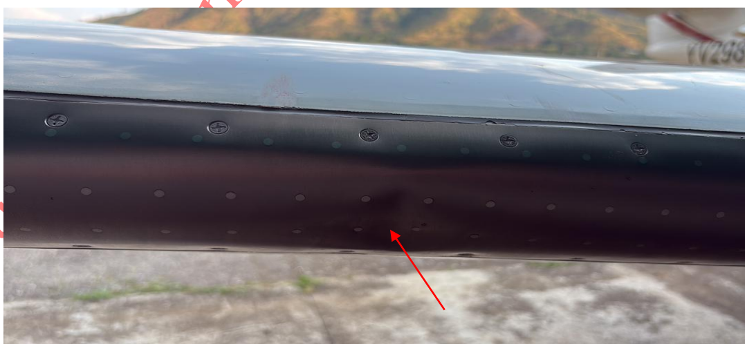
Imagen 4. Abolladura en el borde de ataque del plano derecho YV2988.
