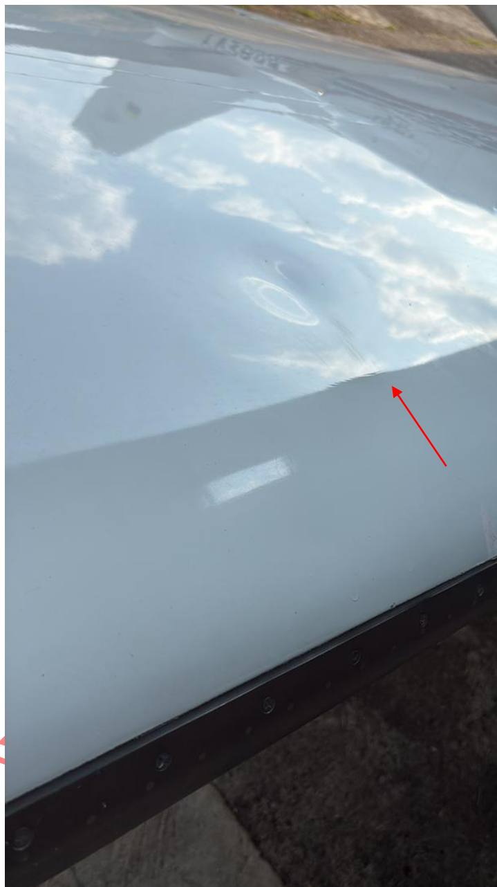
Imagen 5. Abolladura en el plano derecho YV2988.
