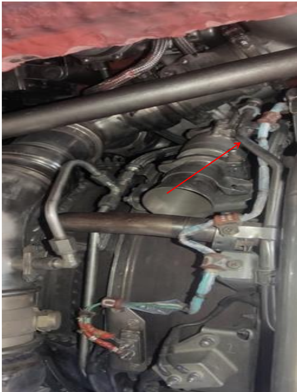
Figura 3. Línea Hidráulica reparada YV3063. Fuente: Investigador Encargado. Año: 2025
