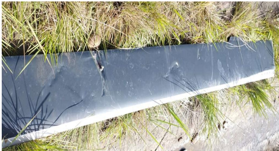
Imagen 16. Pala rotor principal donde se observa la integridad de los bordes de ataque y la ausencia de daños estructurales severos Aeronave YV3004.
