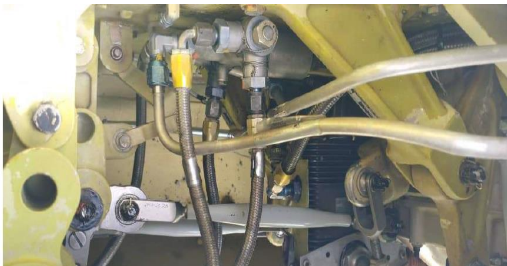
Imagen 18. Inspección de las líneas neumáticas y sellos de seguridad del Gobernador y FCU Aeronave YV3004. Fuente: Investigador Encargado. Año: 2025
