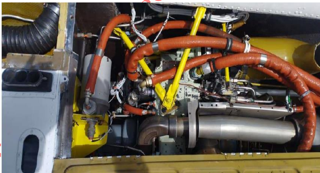
Imagen 19. Inspección de las líneas neumáticas y sellos de seguridad del Gobernador y FCU Aeronave YV3004. Fuente: Investigador Encargado. Año: 2025
