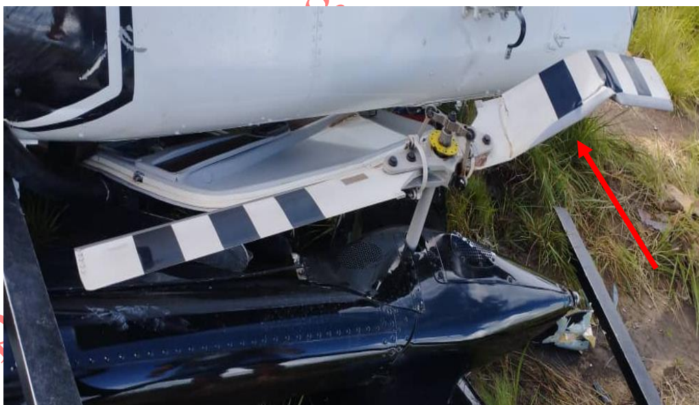
Imagen 10. Daño pala Rotor de cola Aeronave YV3004. Fuente: Investigador Encargado. Año: 2025
