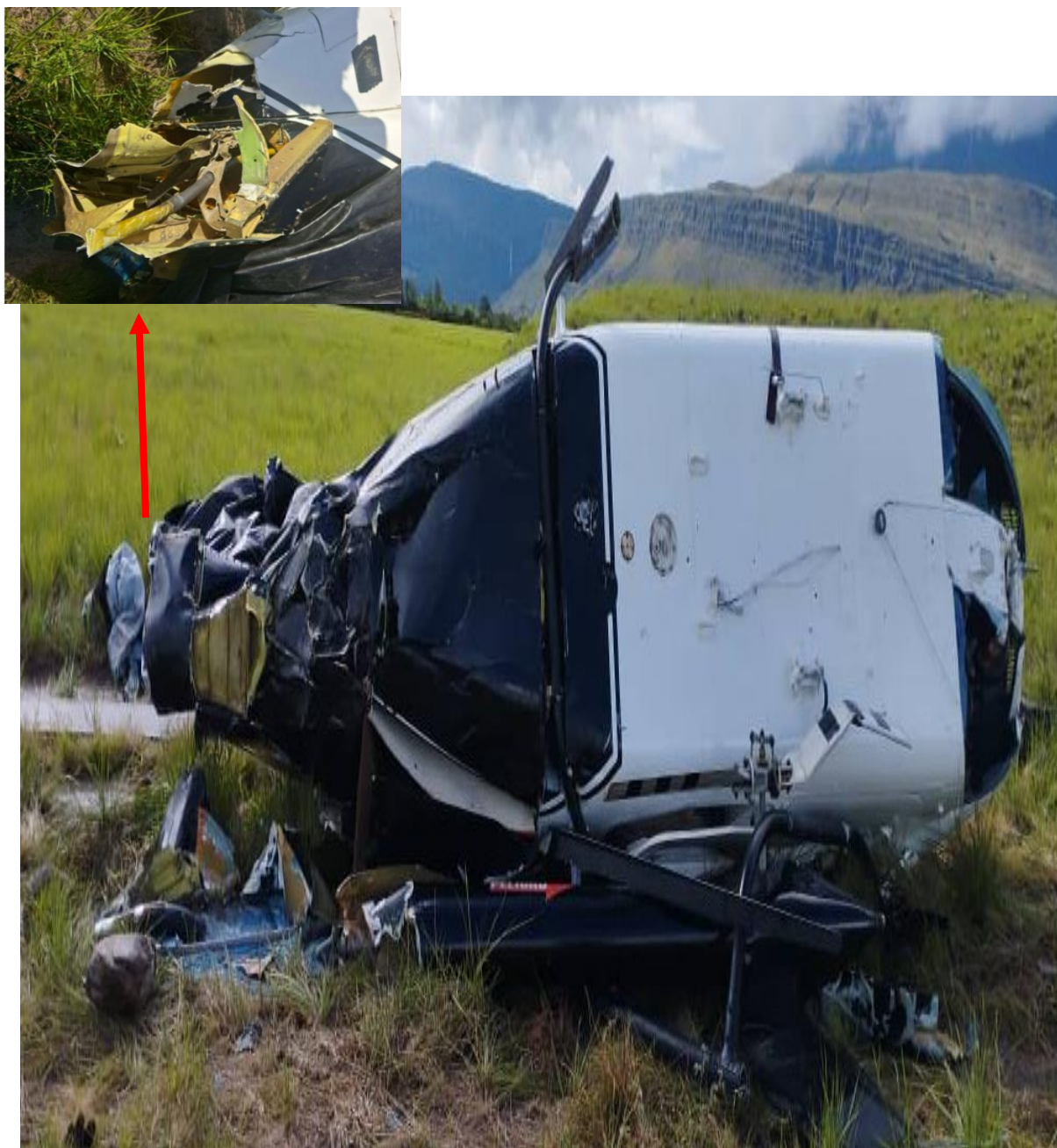
Imagen 11. Detalle de la raíz del Botalón de cola, evidenciando la fractura por cizalladura y la ausencia de marcas de impacto de las palas principales. Aeronave YV3004.
