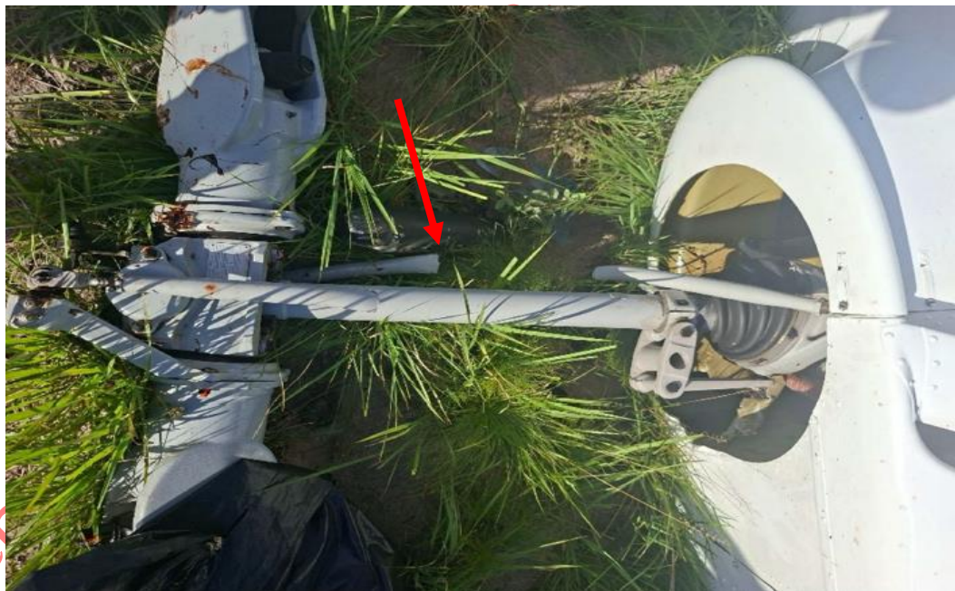
Imagen 17. Barra de cambio de paso rotas, evidenciando parada brusca Aeronave YV3004.
