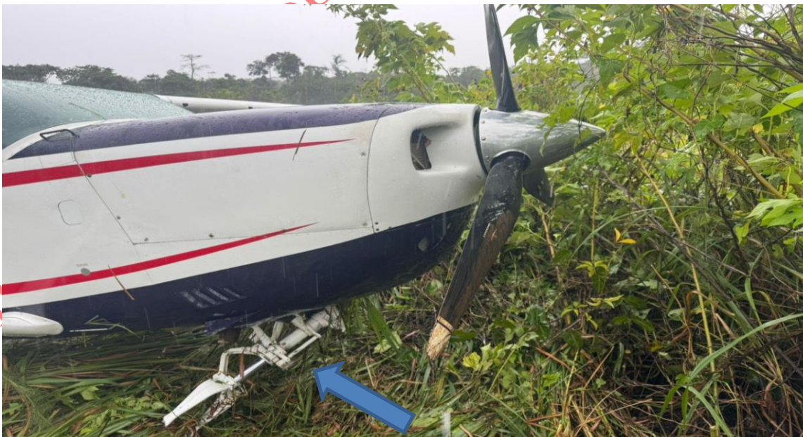
Figura 5. Daños tren de nariz Aeronave YV1797. Fuente: Investigador Encargado. Año: 2025
