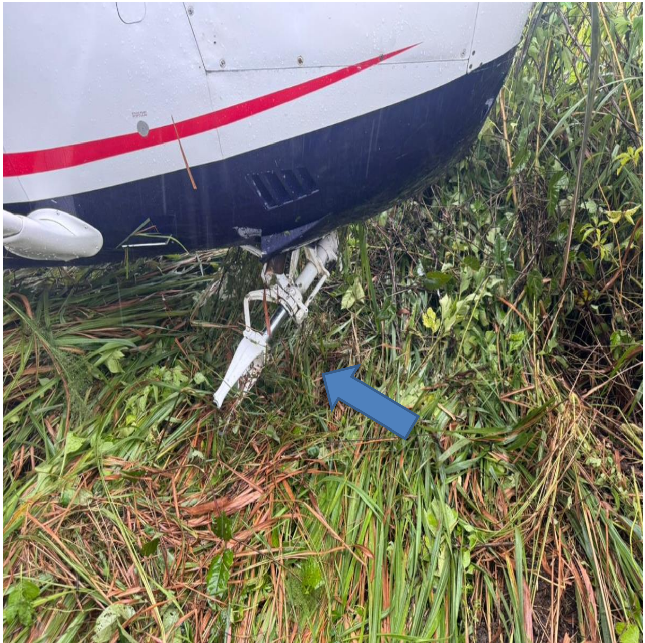
Figura 6. Daños tren de nariz Aeronave YV1797. Fuente: Investigador Encargado. Año: 2025
