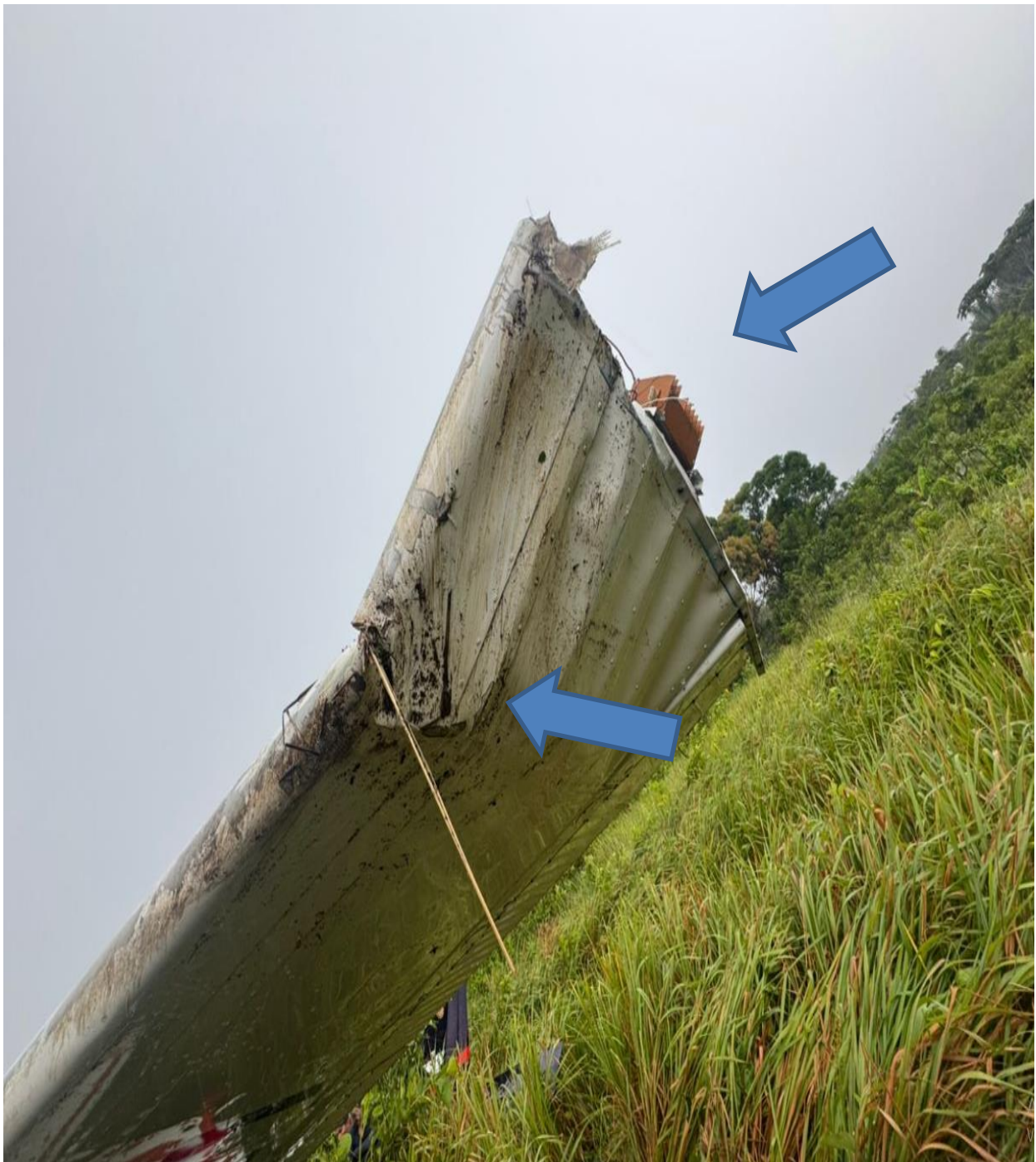
Figura 9. Daños en el borde de ataque y en el Wing Tip plano izquierdo, aeronave YV1797. Fuente: Investigador Encargado. Año: 2025
