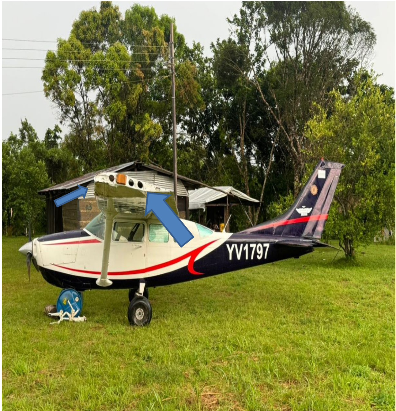
Figura 8. Daños plano izquierdo, aeronave YV1797. Fuente: Investigador Encargado. Año: 2025
