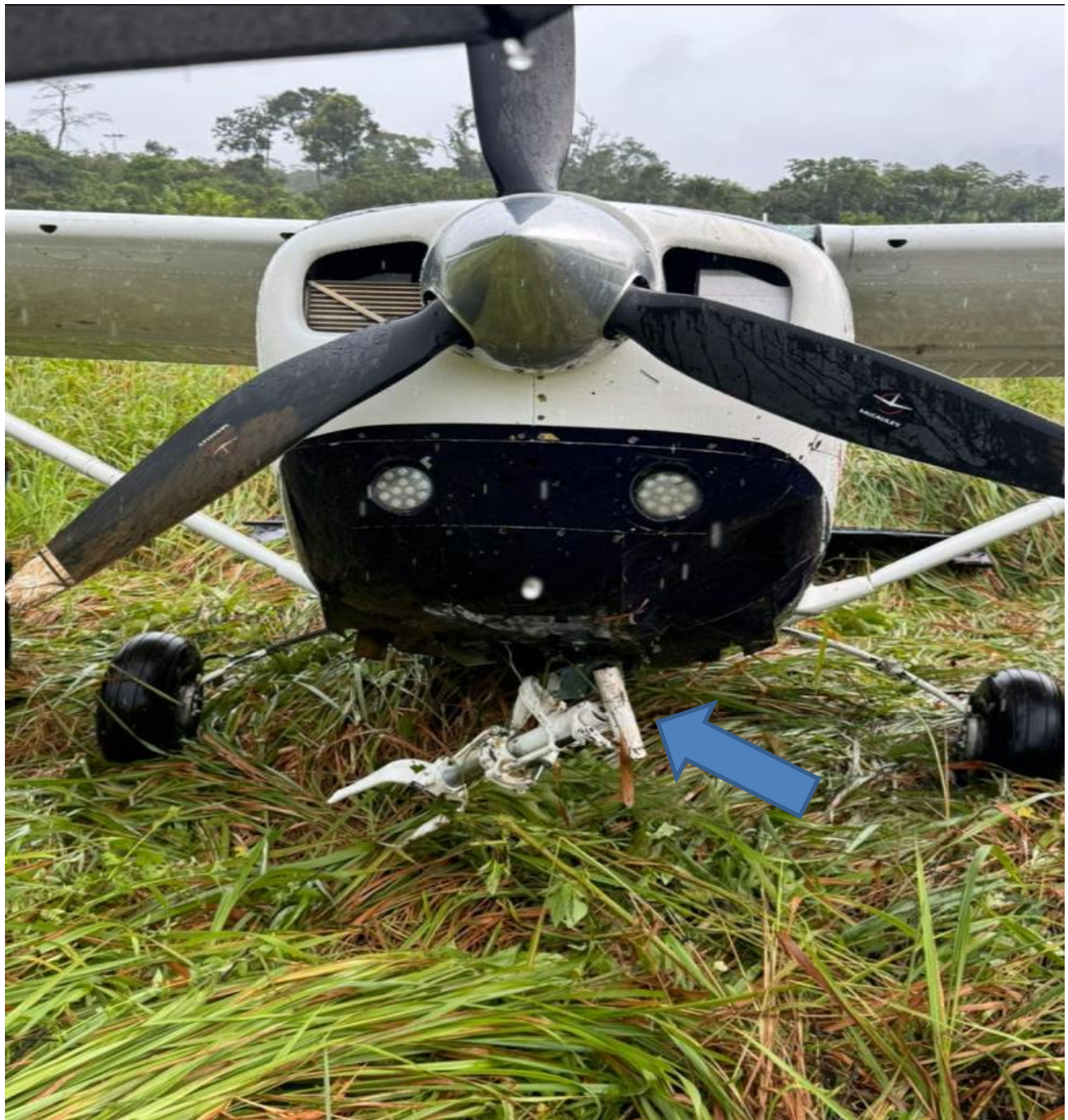
Figura 7. Daños tren de nariz, aeronave YV1797. Fuente: Investigador Encargado. Año: 2025
