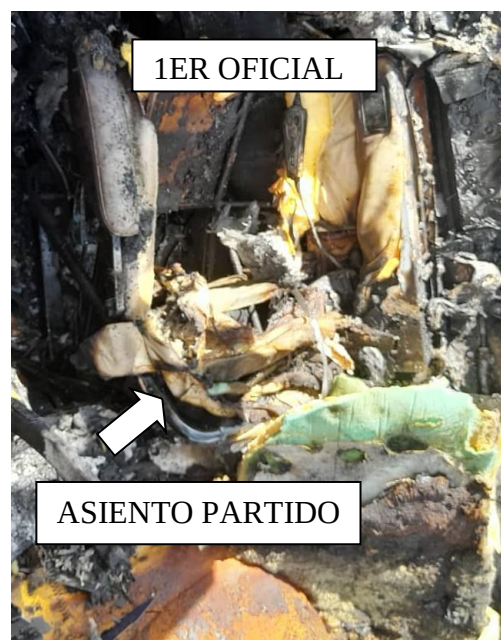
Imagen 43 Condición de los asientos de la cabina de mando Fuente: Investigador encargado. Año: 2025
