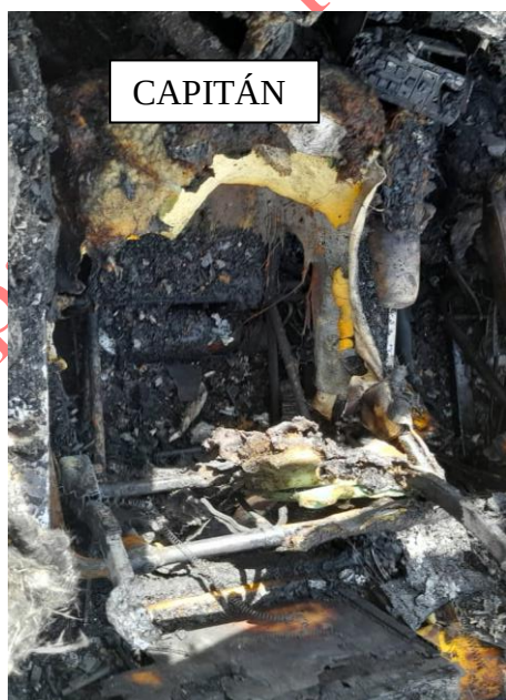
Imagen 43 Condición de los asientos de la cabina de mando Fuente: Investigador encargado. Año: 2025
