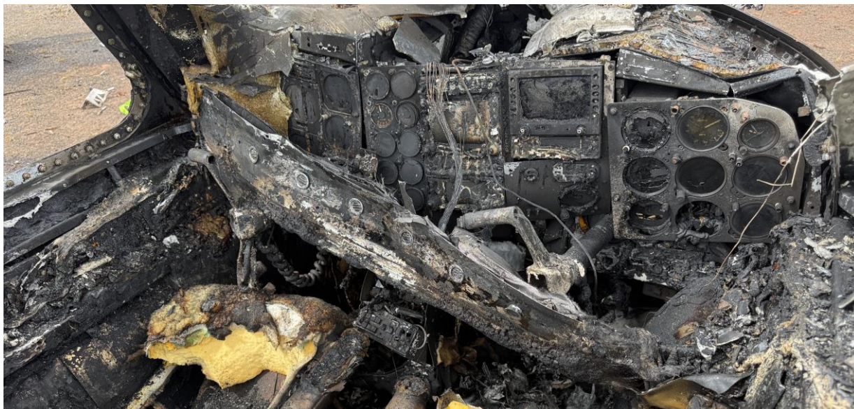
Imagen 45 Restos de los instrumentos de la aeronave Fuente: Investigador encargado. Año: 2025
