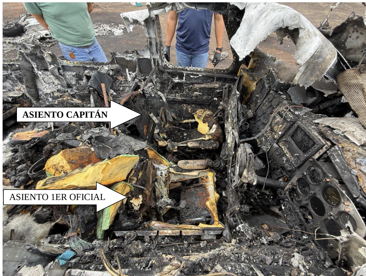
Imagen 43 Condición de los asientos de la cabina de mando Fuente: Investigador encargado. Año: 2025
