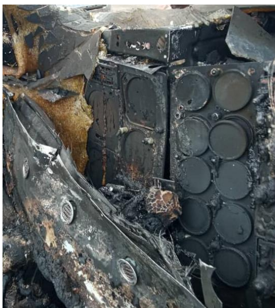
Imagen 45 Restos de los instrumentos de la aeronave Fuente: Investigador encargado. Año: 2025
