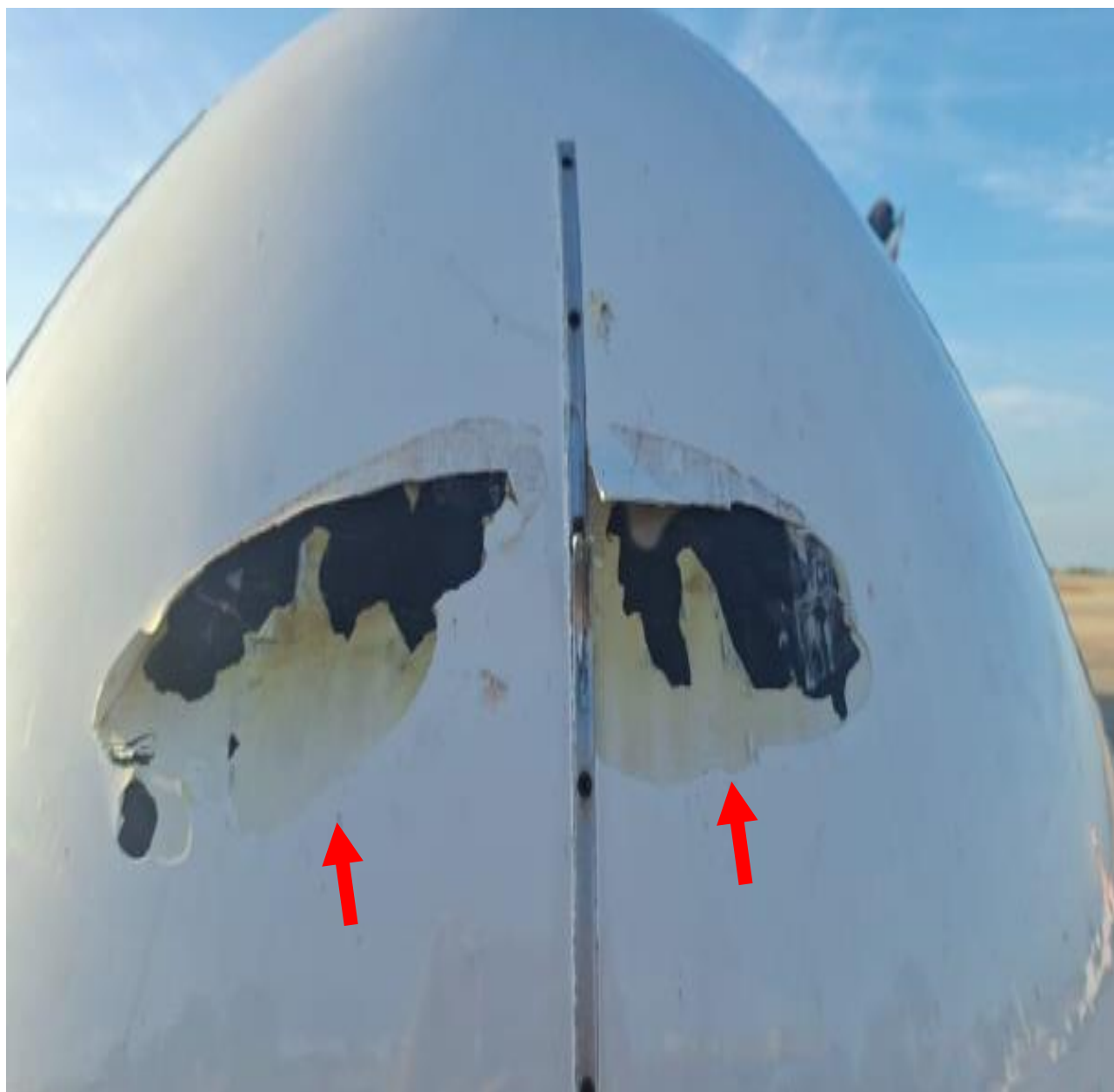
Figura 3. Daños en el Radomo Aeronave YV3145. Fuente: Investigador Encargado Año: 2025
