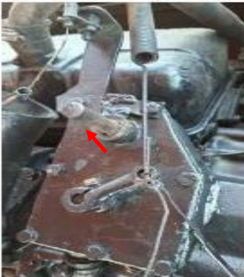
Figura 6. Sistema de varillaje de aceleración del PAYMOVER dañado. Fuente: Investigador Encargado Año: 2025
