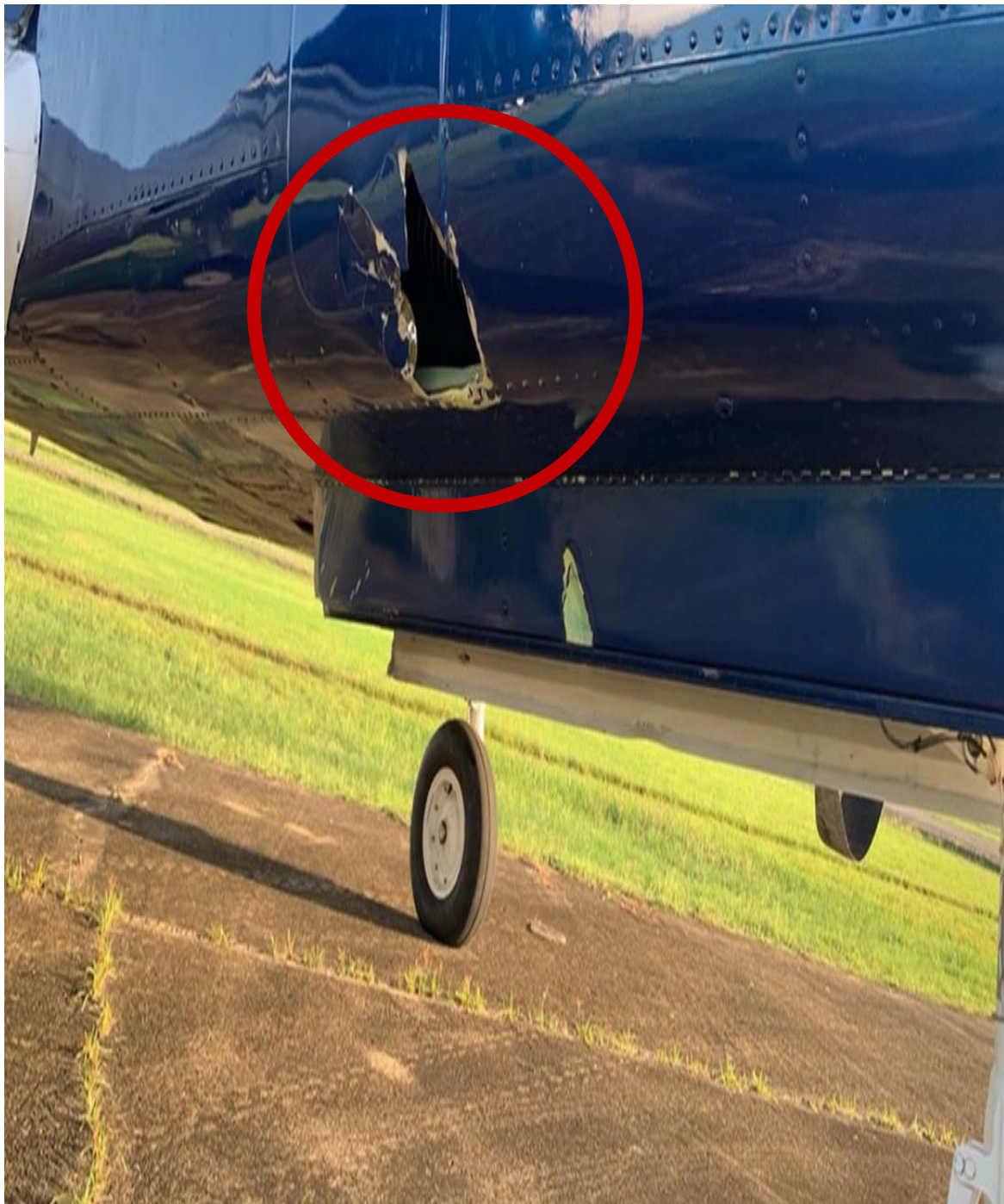
Figura 8. Perforación generada en la Bodega de Carga, aeronave YV1702
