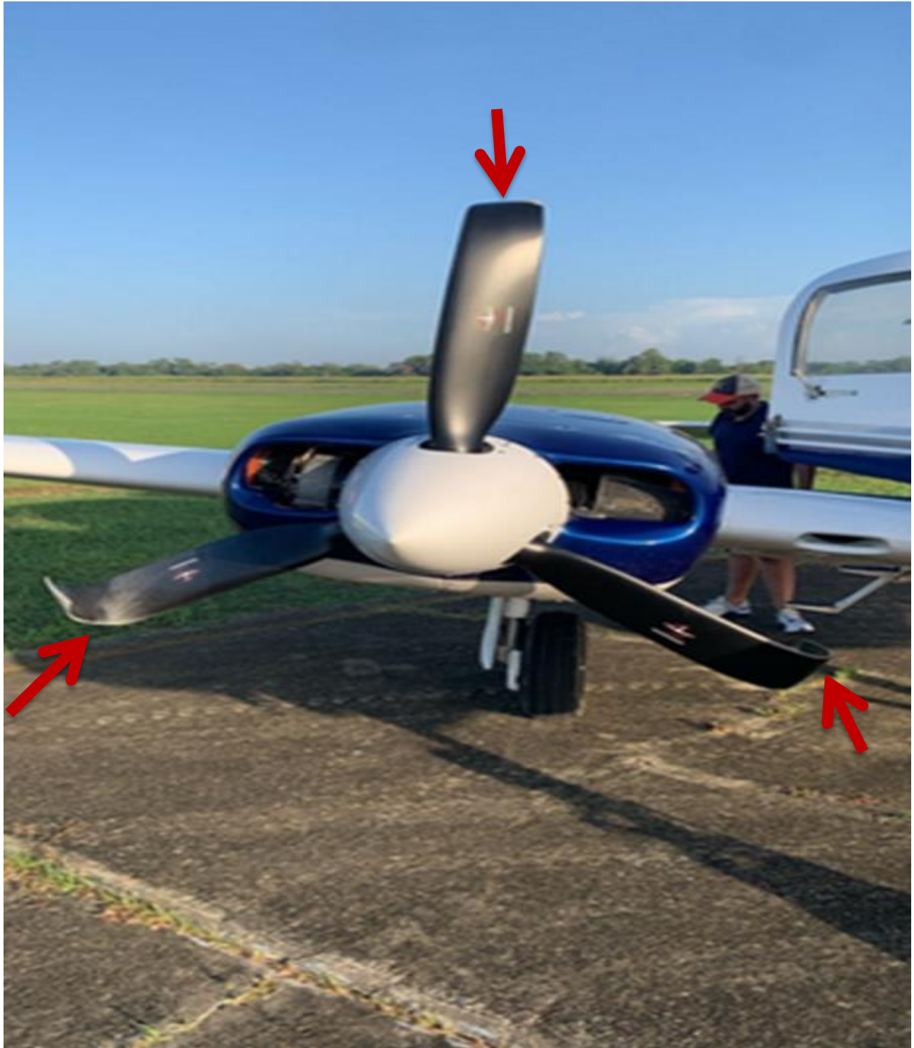
Figura 6. Daños ocasionados en las Palas del motor derecho, aeronave YV1702 Fuente: Investigador Encargado. Año: 2025
