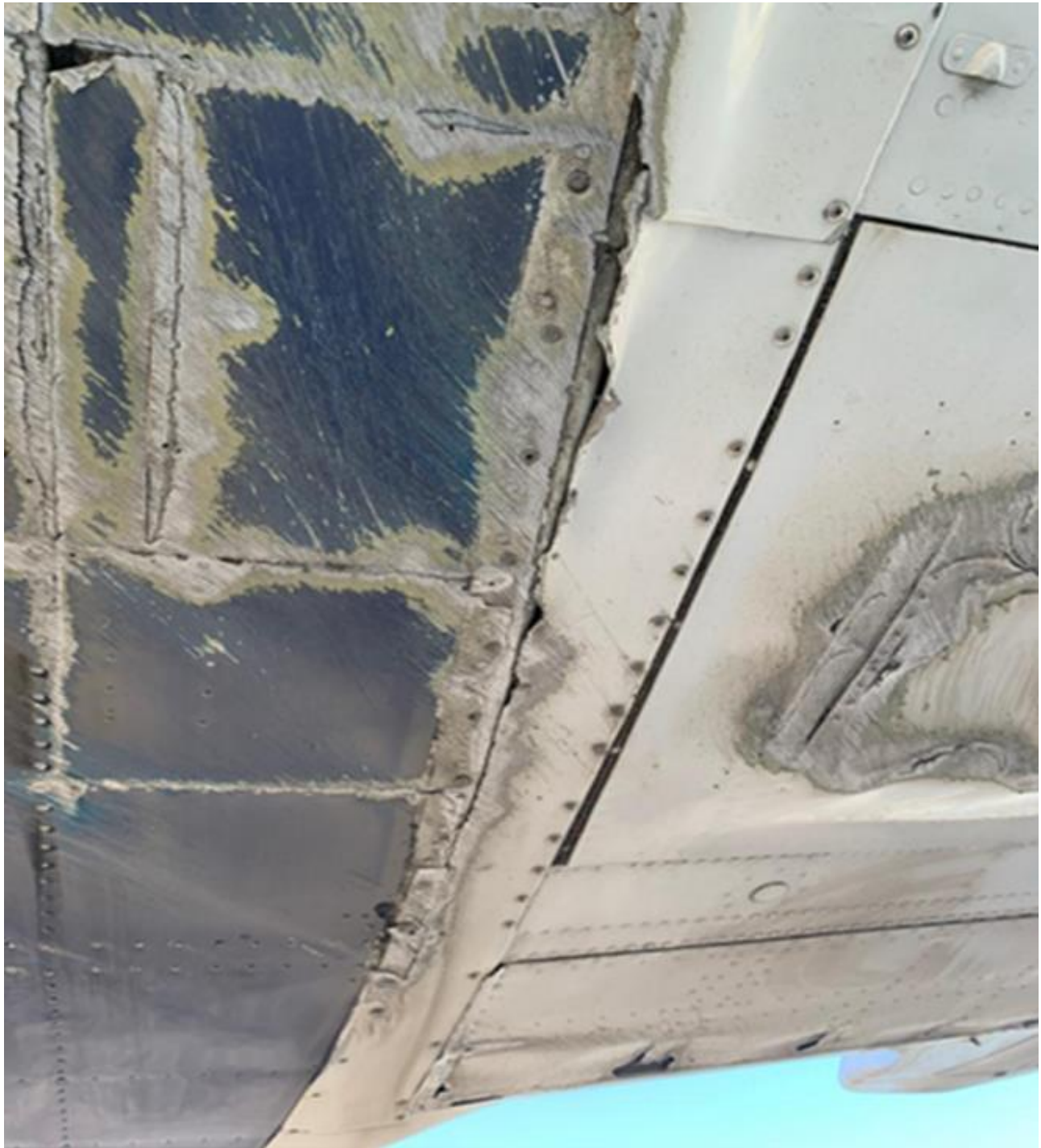
Figura 11. Daños generados en la superficie alar (Intradós), aeronave YV1702 Fuente: Investigador Encargado. Año: 2025
