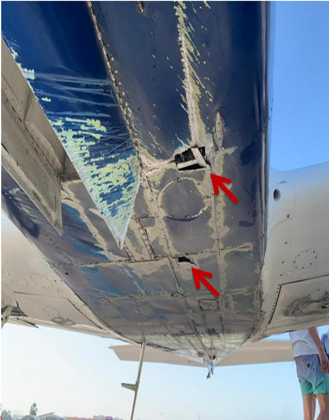
Figura 9. Perforación en la zona ventral YV1702 Fuente: Investigador Encargado. Año: 2025
