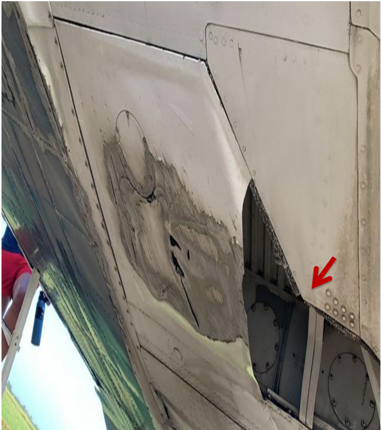
Figura 10. Perforación en la zona ventral YV1702 Fuente: Investigador Encargado. Año: 2025
