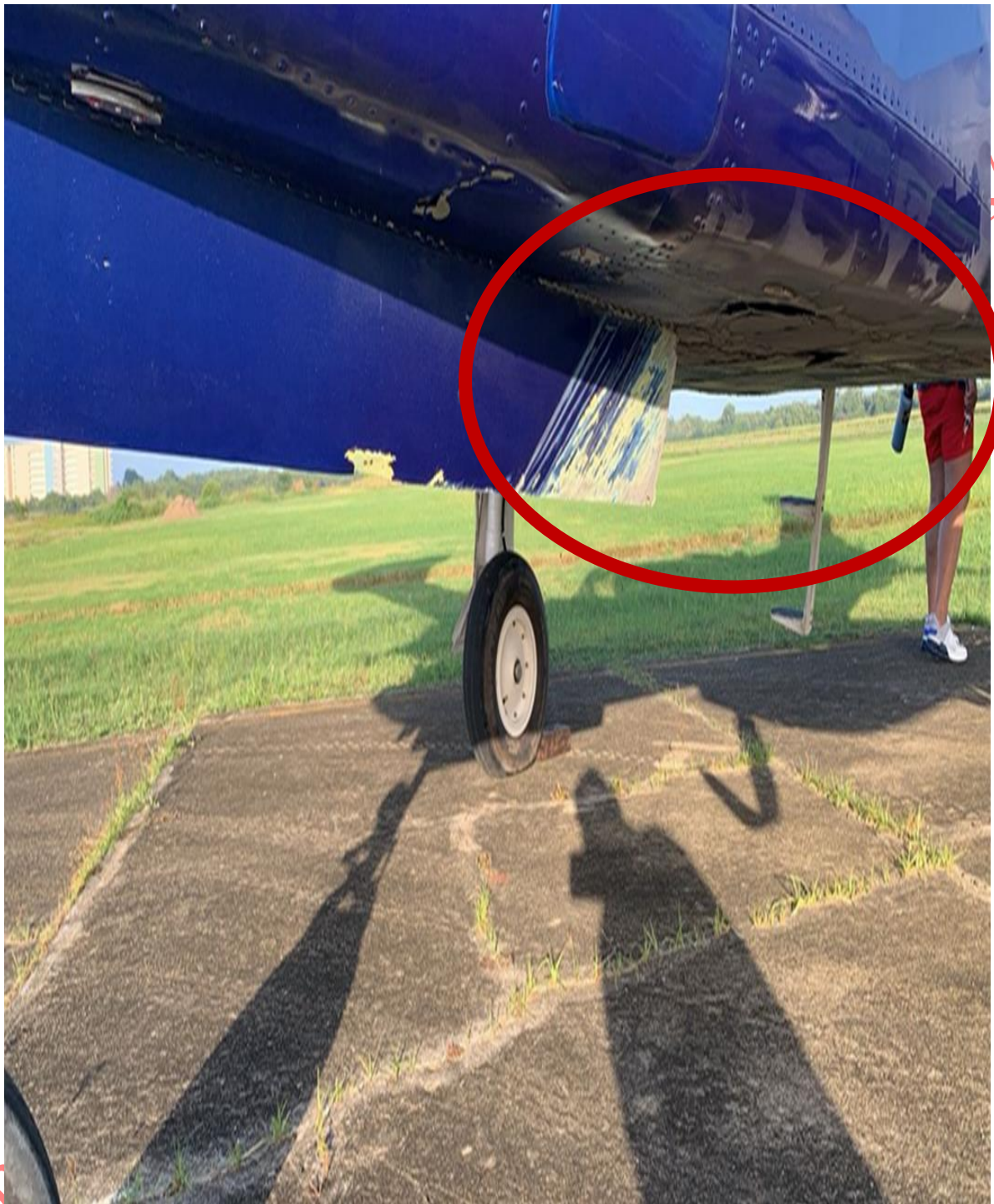
Figura 7. Daños ocasionados en la zona ventral, aeronave YV1702 Fuente: Investigador Encargado. Año: 2025
