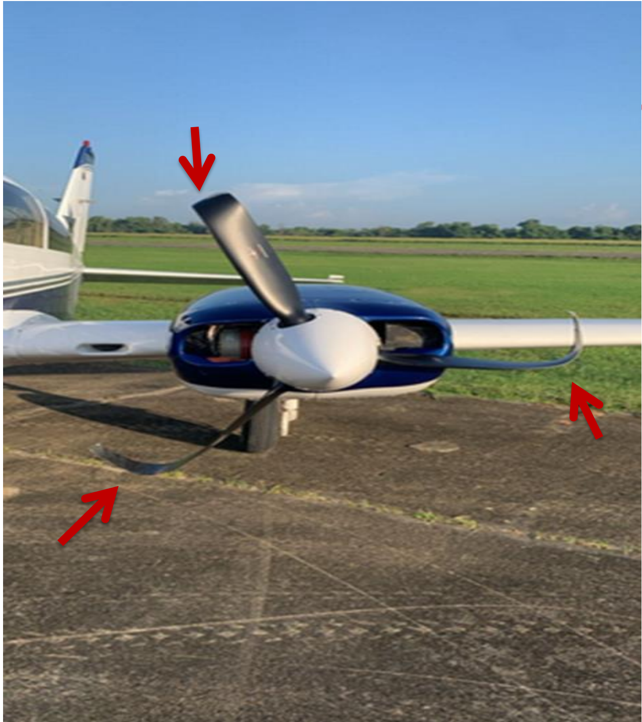
Figura 5. Daños ocasionados en las Palas del motor izquierdo, aeronave YV1702 Fuente: Investigador Encargado. Año: 2025
