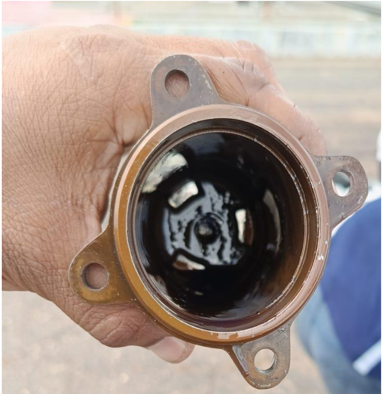
Figura 4. Filtro Contaminado Aeronave YV1776. Fuente: Investigador Encargado. Año: 2025
