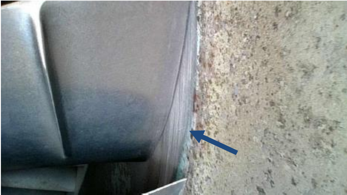
Figura 7. Roce del Fan con el Case aeronave YV1776 Fuente: Investigador Encargado. Año: 2025
