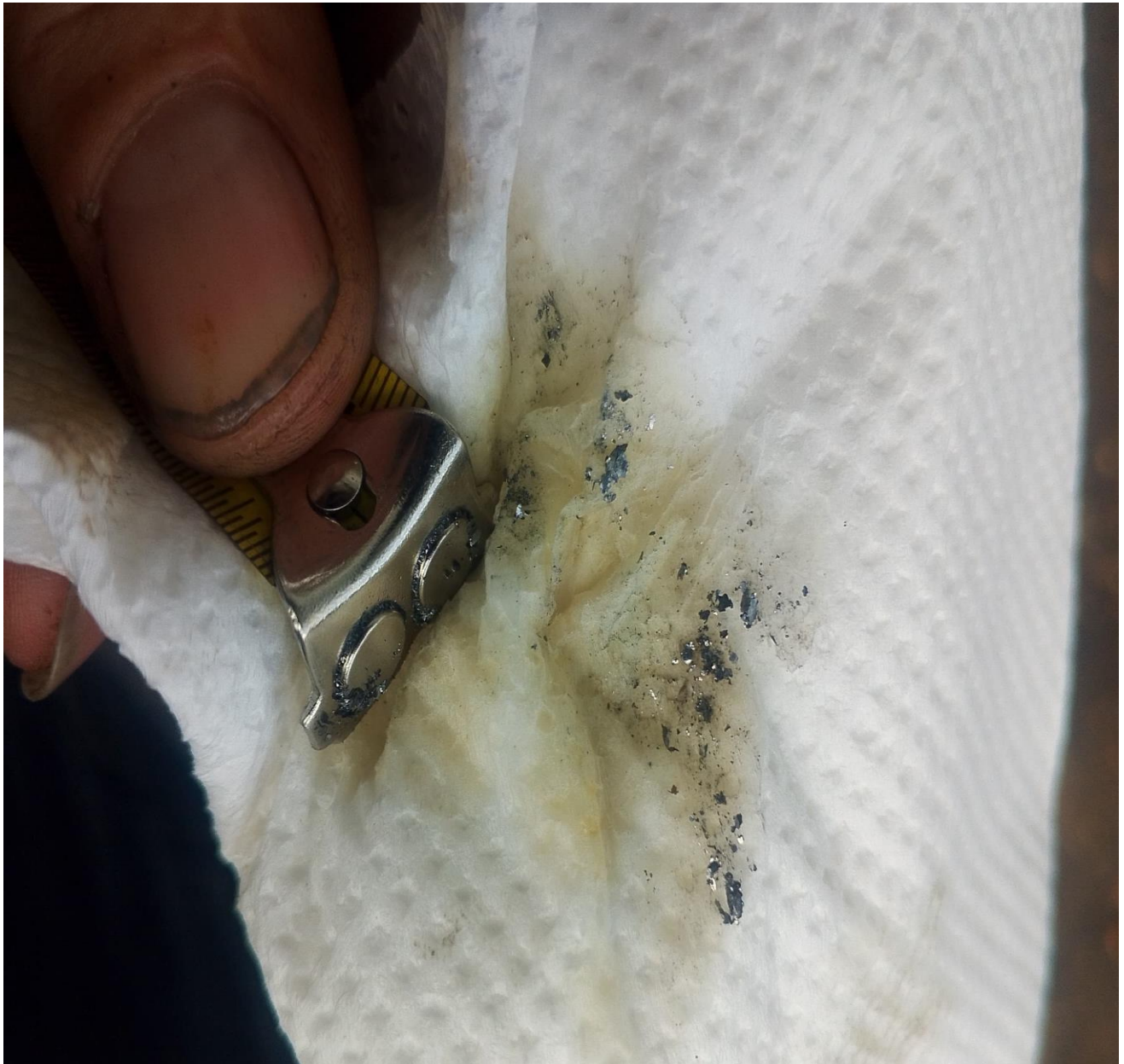
Figura 6. Partículas metálicas encontradas en el filtro de aceite Aeronave YV1776
