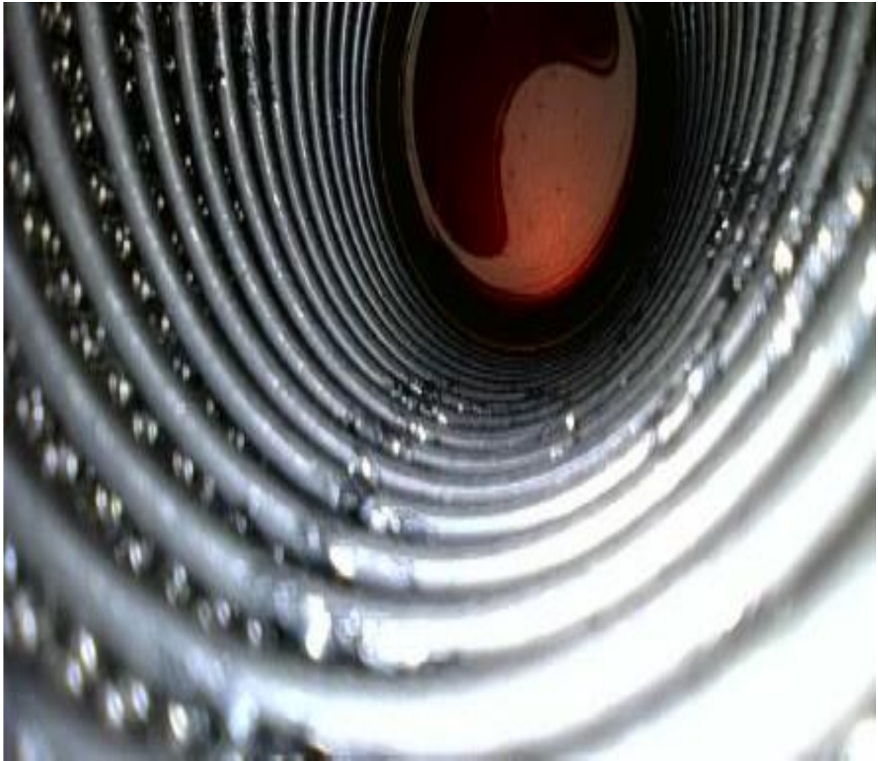
Figura 5. Partículas metálicas en el filtro de aceite Aeronave YV1776.
