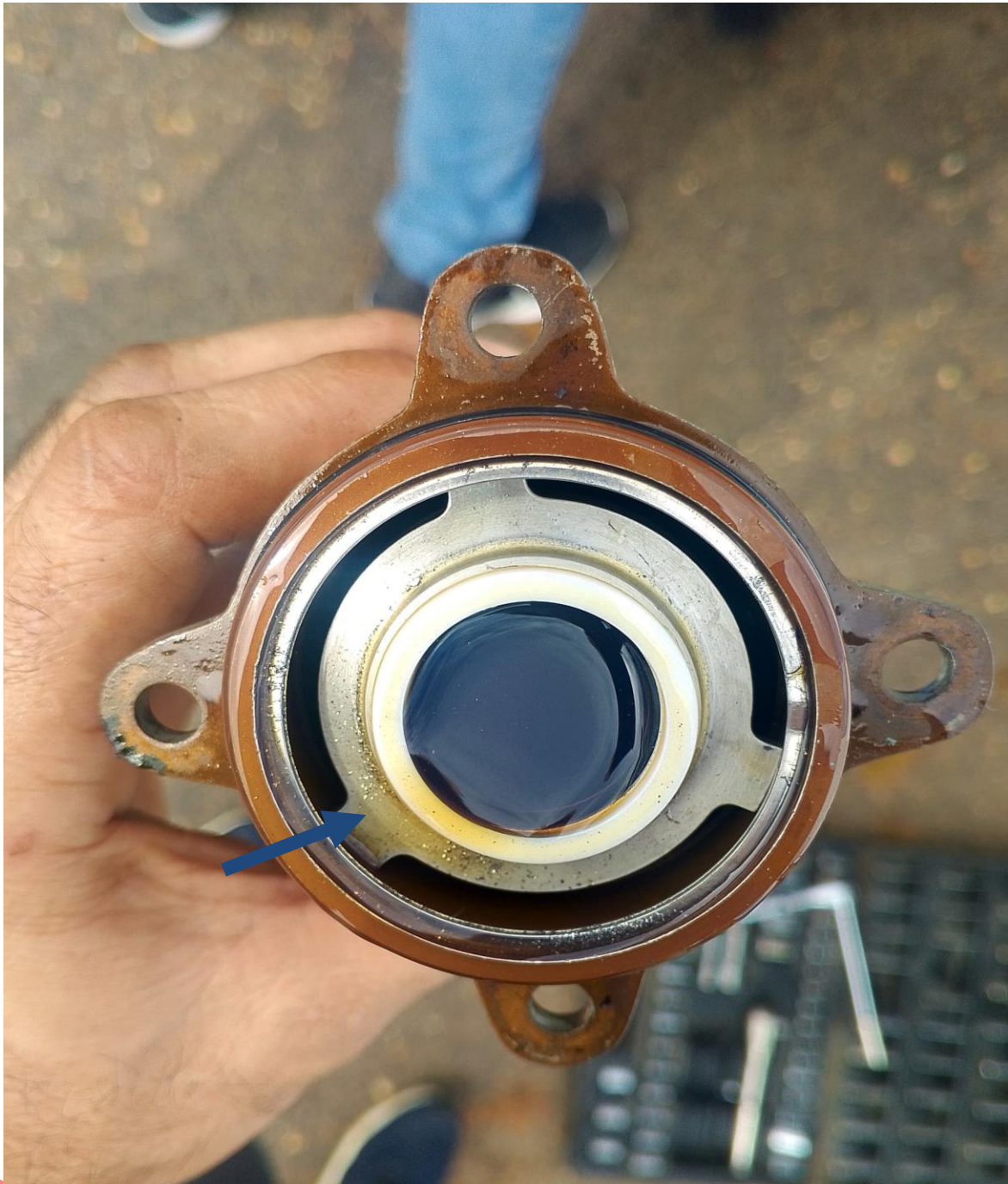
Figura 3. Filtro de Aceite contaminado aeronave YV1776. Fuente: Investigador Encargado. Año: 2025
