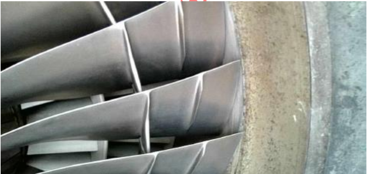
Figura 8. Roce del Fan con el Case aeronave YV1776. Fuente: Investigador Encargado. Año: 2025
