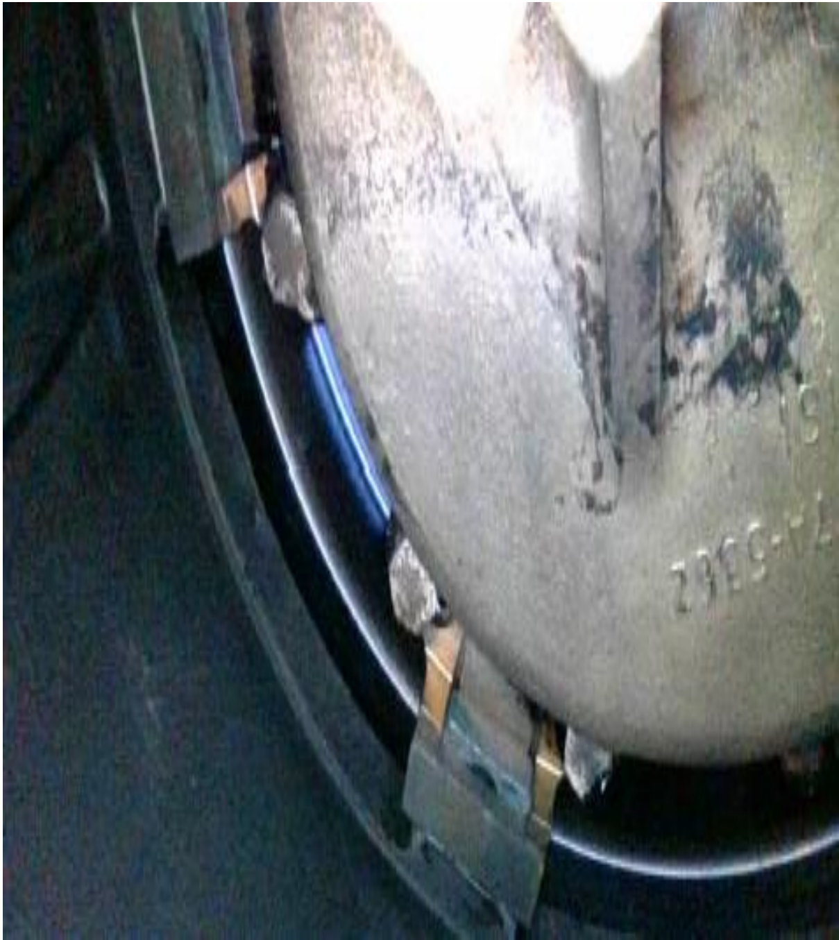
Figura 9. Sello del Bearing N°4 aeronave YV1776. Fuente: Investigador Encargado. Año: 2025
