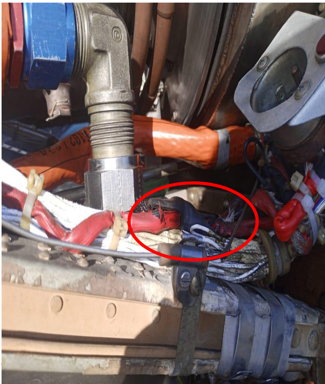
Figura 11. Sistema de calentamiento del motor (en desuso) Aeronave YV3438.
